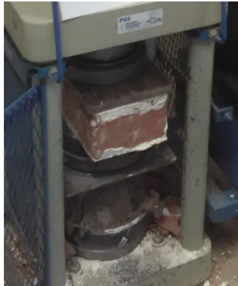
FIGURA Nº 11: Compresión axial de ladrillo King Kong 18 huecos
