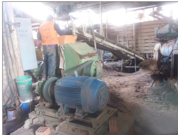
FIGURA N° 30: Banda transportadora en ladrillera semi industrial – distrito San Jerónimo
