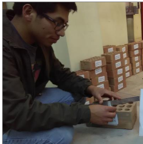
FIGURA N° 38: Medición del diámetro de huecos de la cara de asiento
