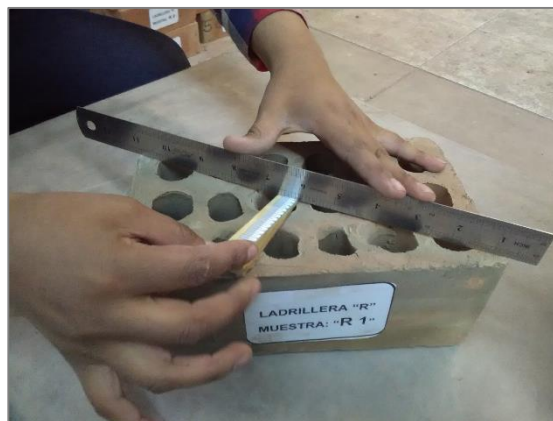
FIGURA N° 33: Alabeo-medición de máxima flecha en cara de asiento
