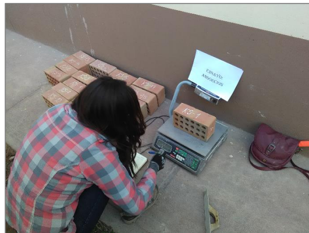
FIGURA N° 34: Absorción-pesaje de unidades de albañilería secas
