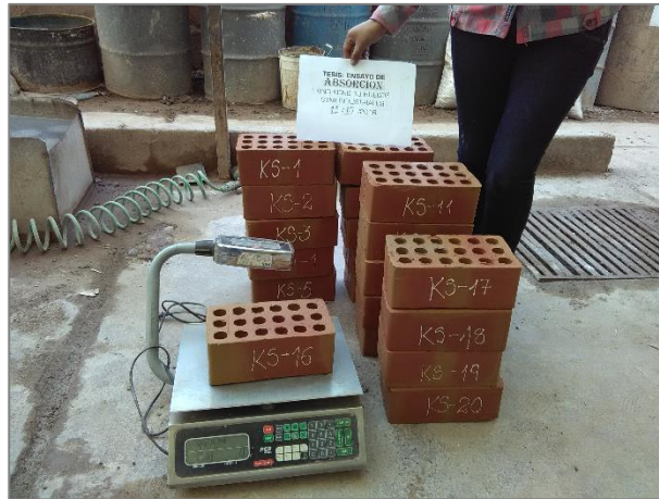
FIGURA Nº 37: Absorción-pesaje de unidades saturadas superficialmente secas
