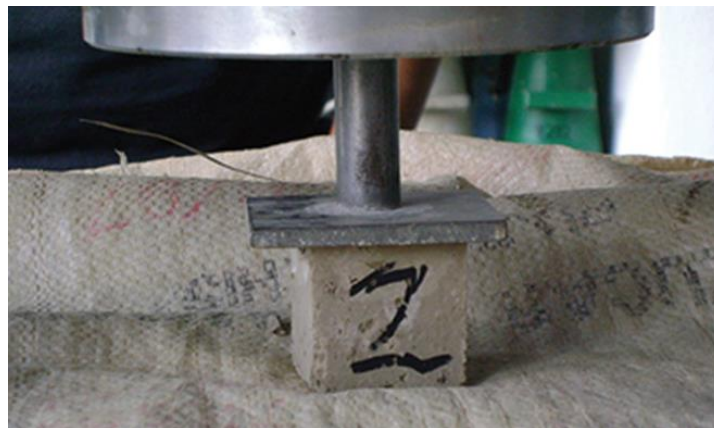
FIGURA N° 23: Ensayo de resistencia a compresión axial de testigo de mortero
