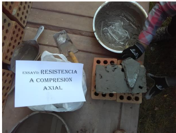
FIGURA N° 26: Capping de ladrillos King Kong con mortero de yeso cemento
