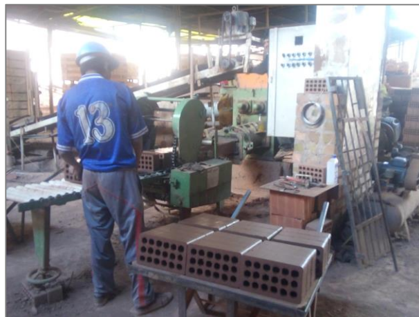
FIGURA N° 31: Moldeo de ladrillo King Kong 18 huecos – distrito San Jerónimo
