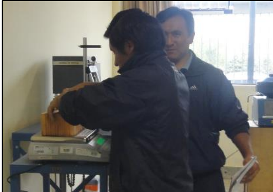
Foto N° 33: Control del peso del ladrillo con agua
