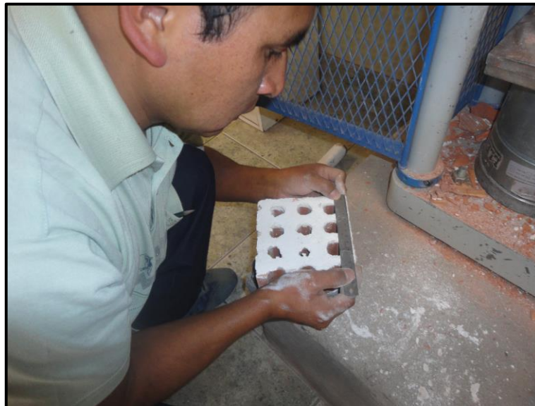
Foto N° 44: Toma de dimensiones del ladrillo
