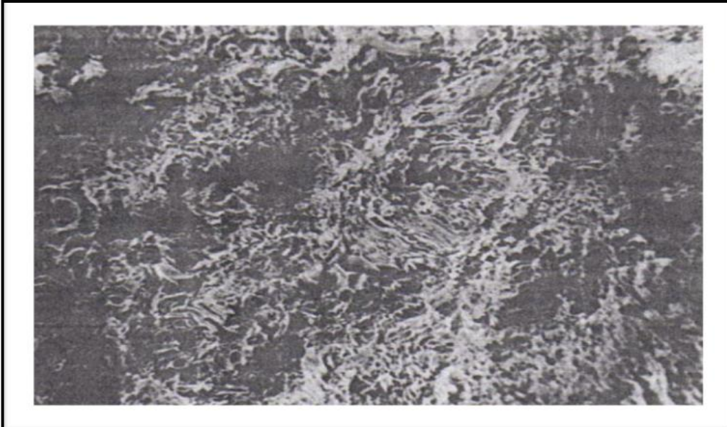
Ilustración 2: Superficie de un grano de puzolana amplificado 60 veces.
