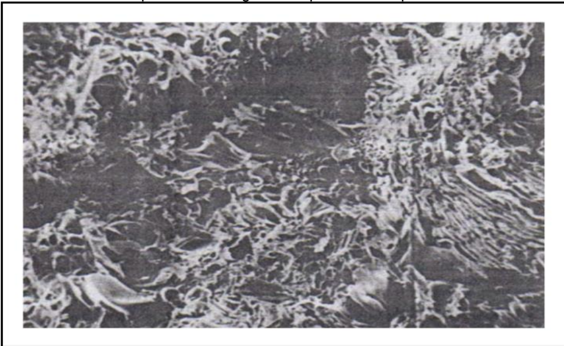
Ilustración 3: Superficie de un grano de puzolana amplificado 150 veces.
