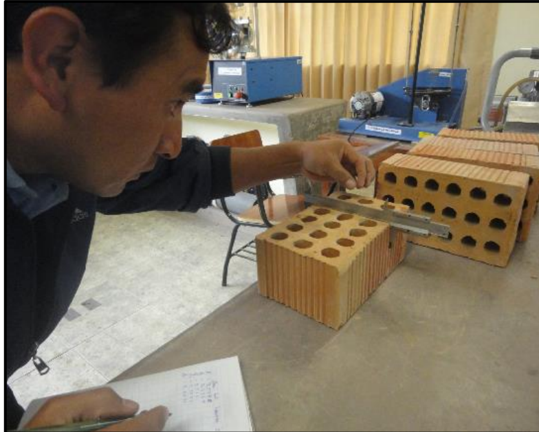
Foto N° 29: Medición de las dimensiones del ladrillo
