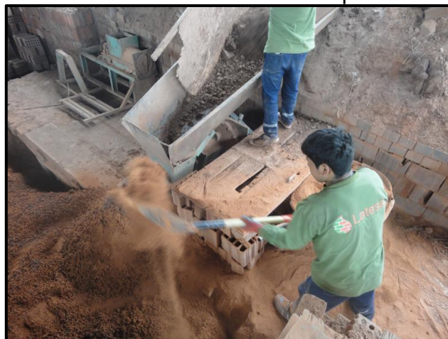
Foto N° 22: Dosificación de la materia prima del ladrillo
