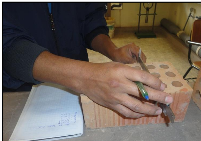
Foto N° 48: Medición de las dimensiones del ladrillo
