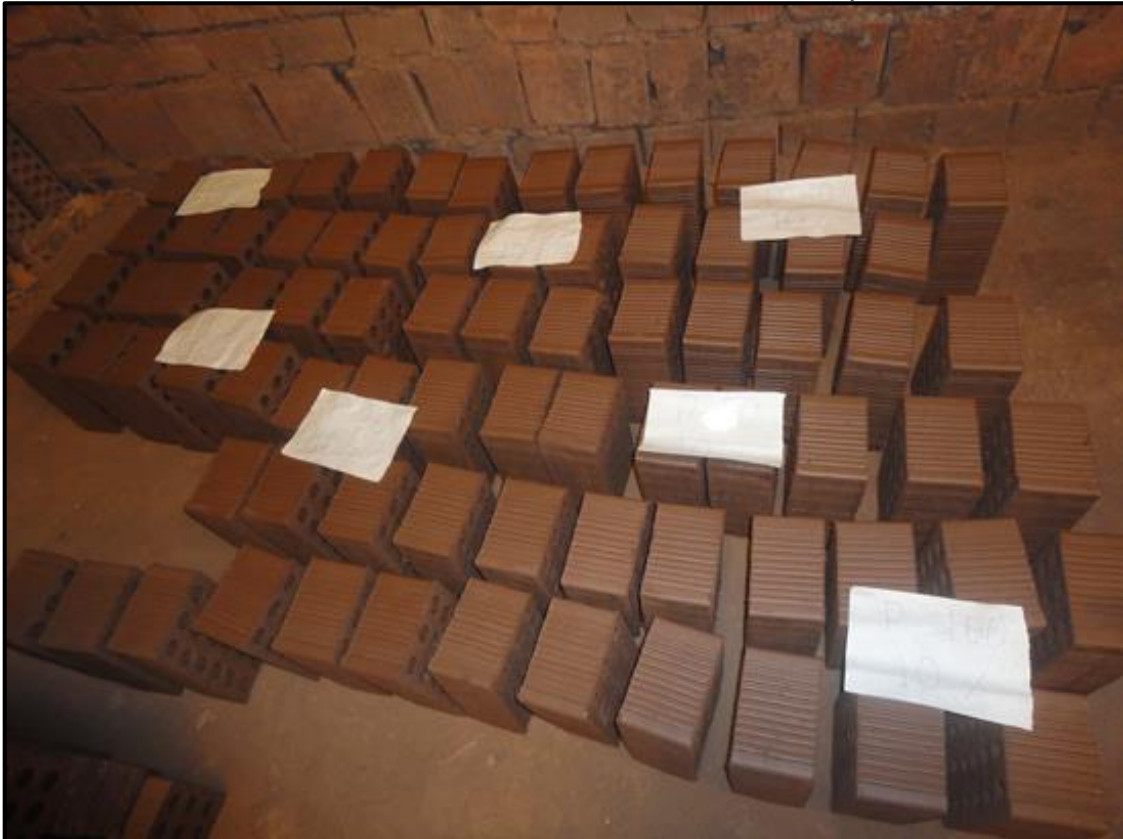
Foto N° 24: Secado de los ladrillos a la intemperie
