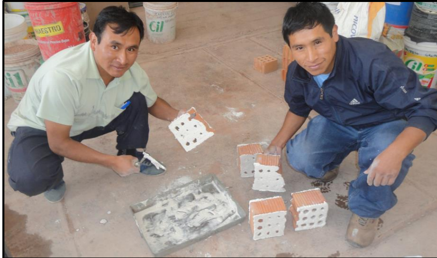
Foto N° 43: Colocado del capping al ladrillo
