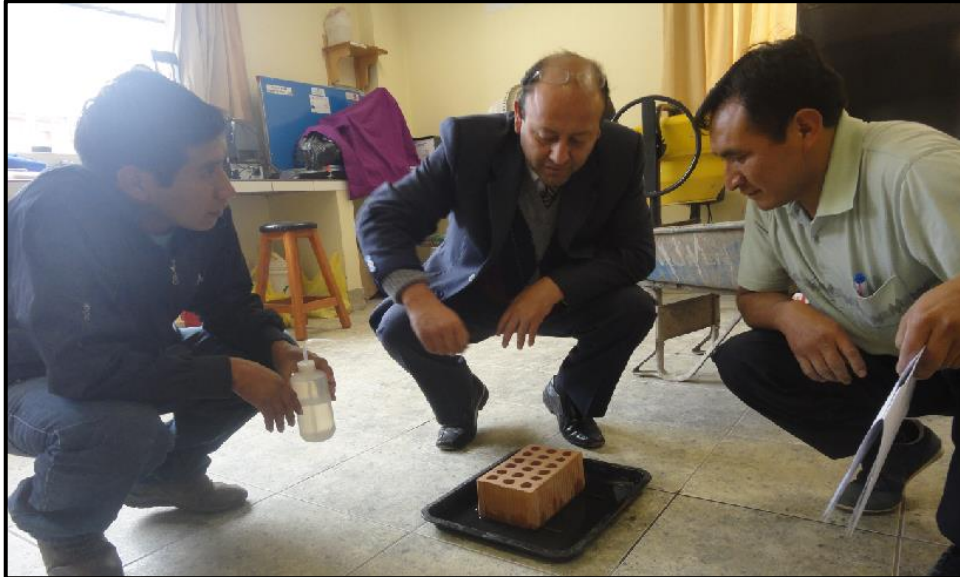
Foto N° 31: Colocación del ladrillo sobre los soportes
