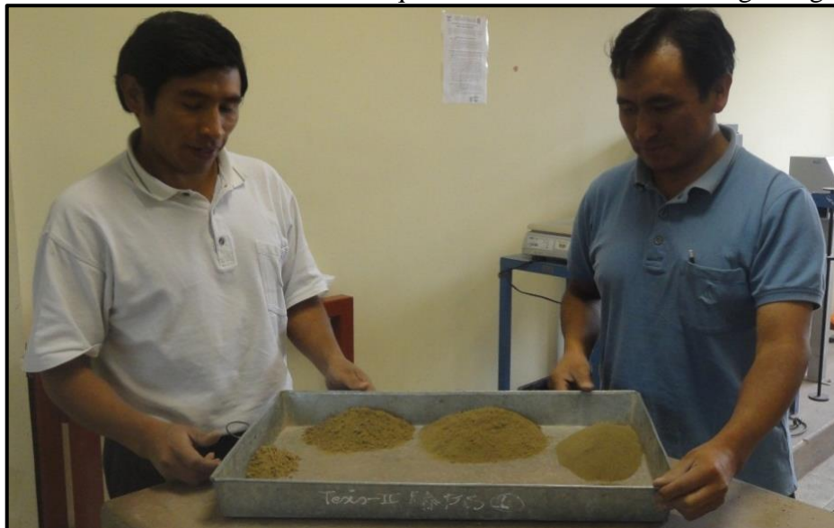
Foto N° 20: Puzolana tamizada que se adicionó al ladrillo King Kong
