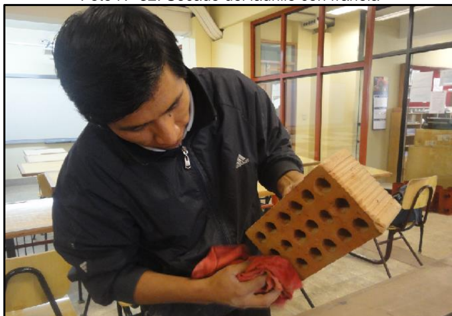
Foto N° 32: Secado del ladrillo con franela
