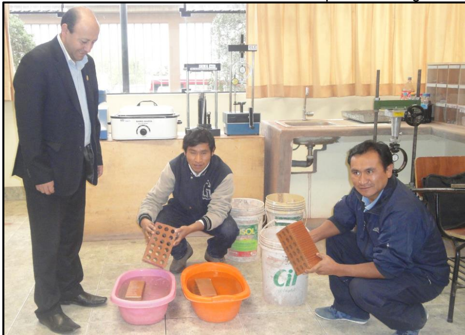
Foto N° 36: Colocación del ladrillo en recipientes de agua
