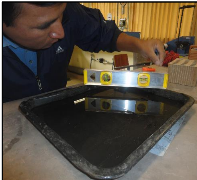
Foto N° 30: Control de la horizontalidad de la bandeja
