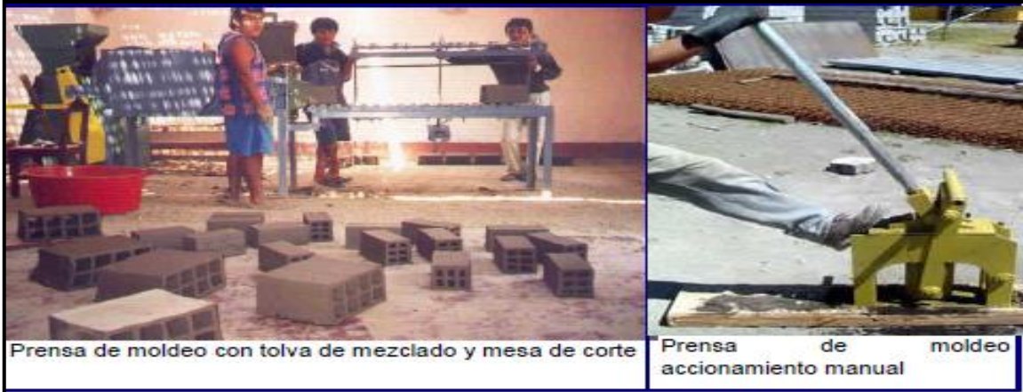
Ilustración 7: Proceso de elaboración y moldeo del ladrillo
