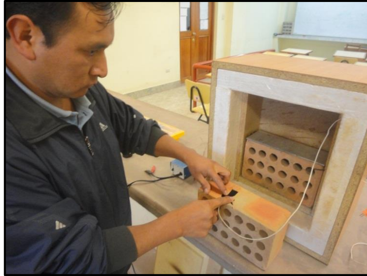
Foto N° 49: Colocación de los sensores
