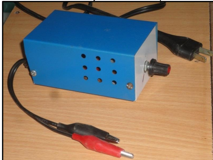
Foto N°3: Fuente de voltaje alterna de la placa de aluminio
