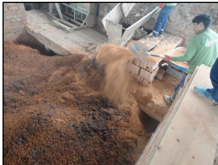
Foto N° 17: Adición de la arenilla a la arcilla
