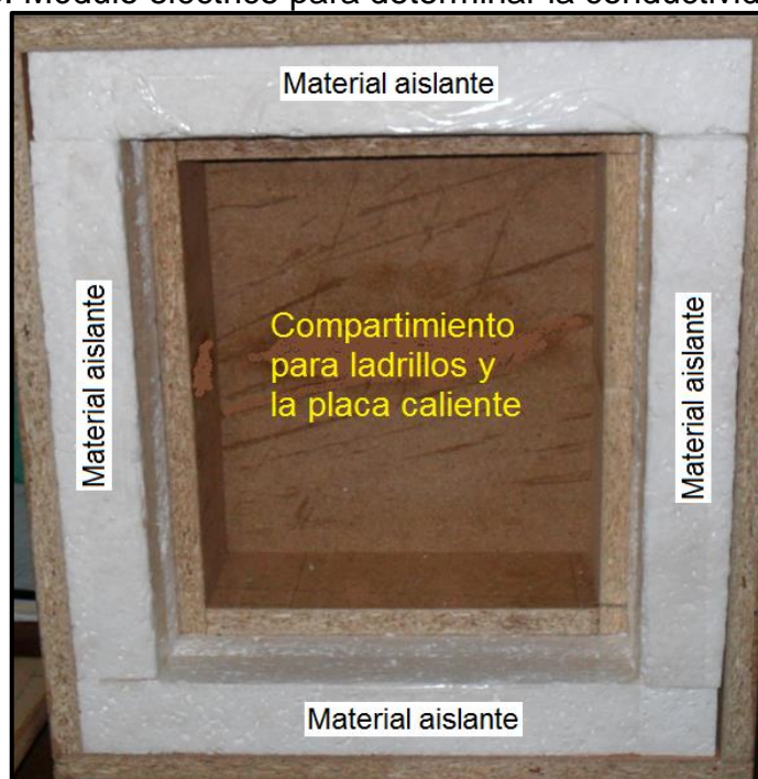
Foto N° 5: Módulo eléctrico para determinar la conductividad térmica
