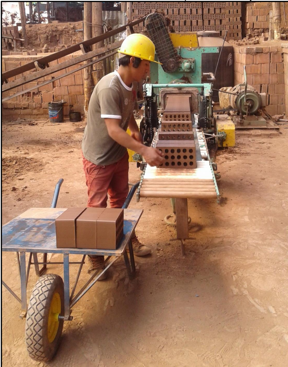
Foto N° 23: Extracción de los ladrillos de la máquina extrusora y moldeadora
