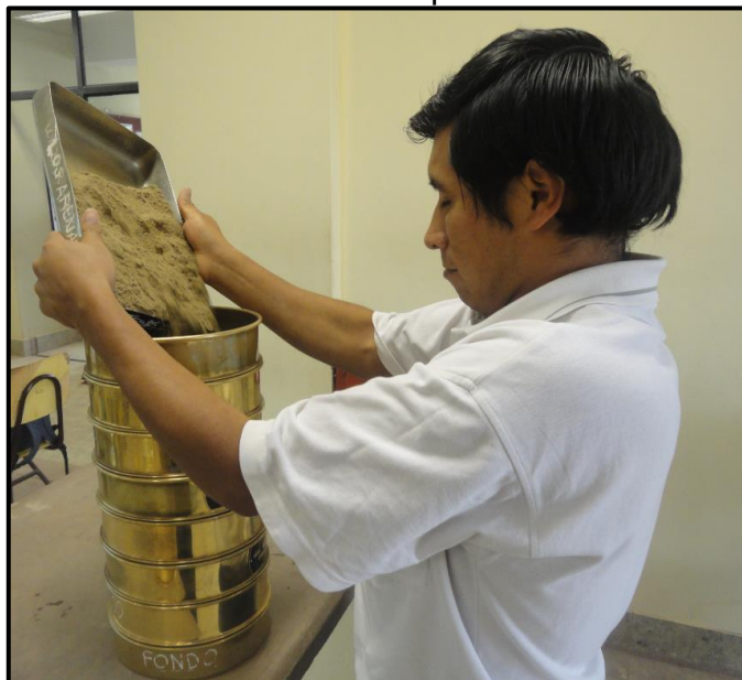
Foto N° 13: Colocacion de la puzolana a los tamices
