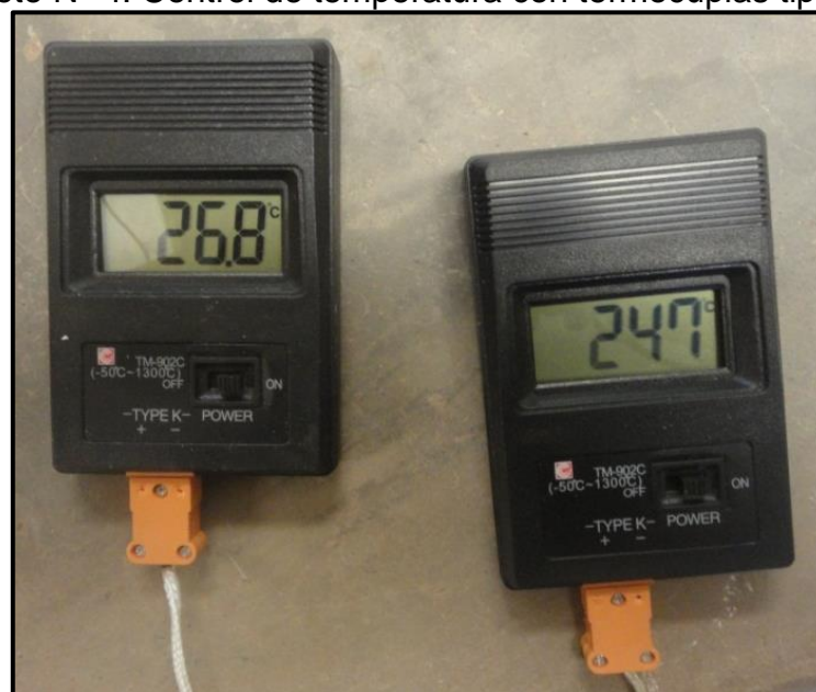
Foto N° 4: Control de temperatura con termocuplas tipo K
