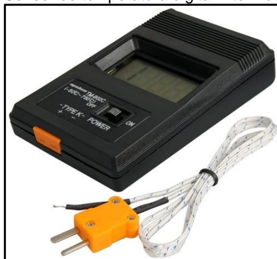
Foto N°1: Sensor de temperatura digital – termocupla tipo K
