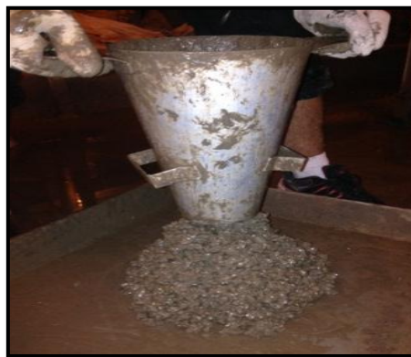
FIGURA N° 43: Ensayo de cono invertido
