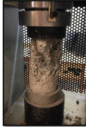
FIGURA N° 48: Falla de muestra, después de compresión
