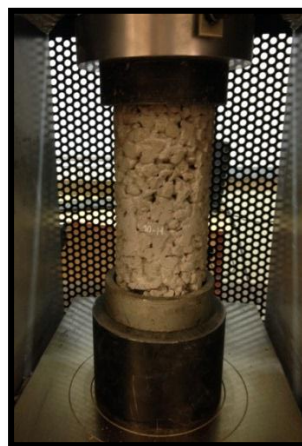
FIGURA N° 47: Briqueta colocada en máquina de compresión
