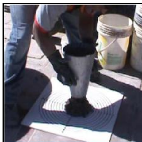
FIGURA N° 04: Ensayo de revenimiento
