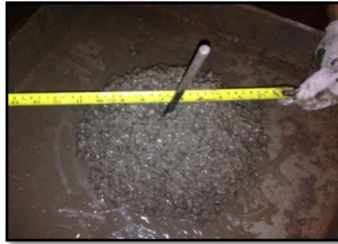
FIGURA N° 44: Determinación de revenimiento
