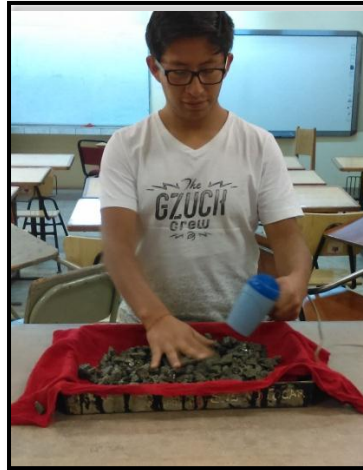
FIGURA N° 37: Secado de agregado para determinar saturado superficialmente seco
