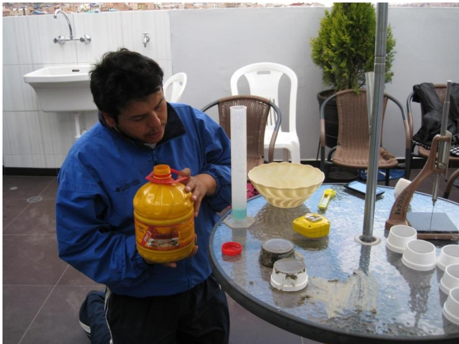
Dosificación del aditivo Sika para la preparación de la pasta de cemento para el ensayo de penetración con la aguja de Vicat
