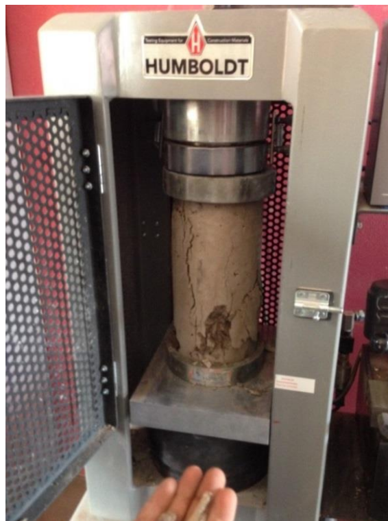
Se observa el comportamiento del testigo (rotura)
