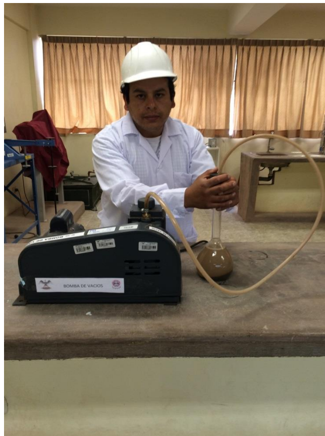
Extracción de aire atrapado del picnómetro con la bomba de vacíos
