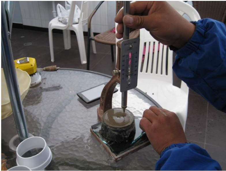
Se observa después de una hora la penetración de la aguja en la pasta
