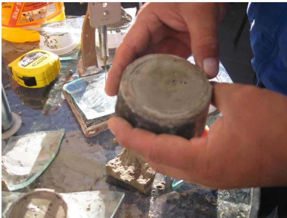
Aquí se observa la pasta ya fraguada en el molde
