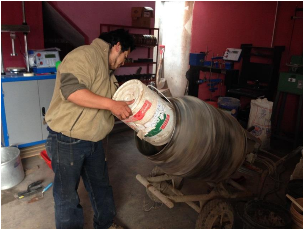
Adición de los agregados para la preparación del concreto
