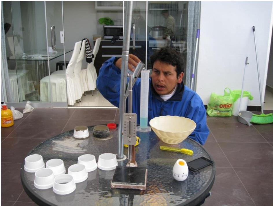
Adición de agua a la dosificación de aditivo para la preparación de la pasta de cemento para el ensayo de penetración con la aguja de Vicat
