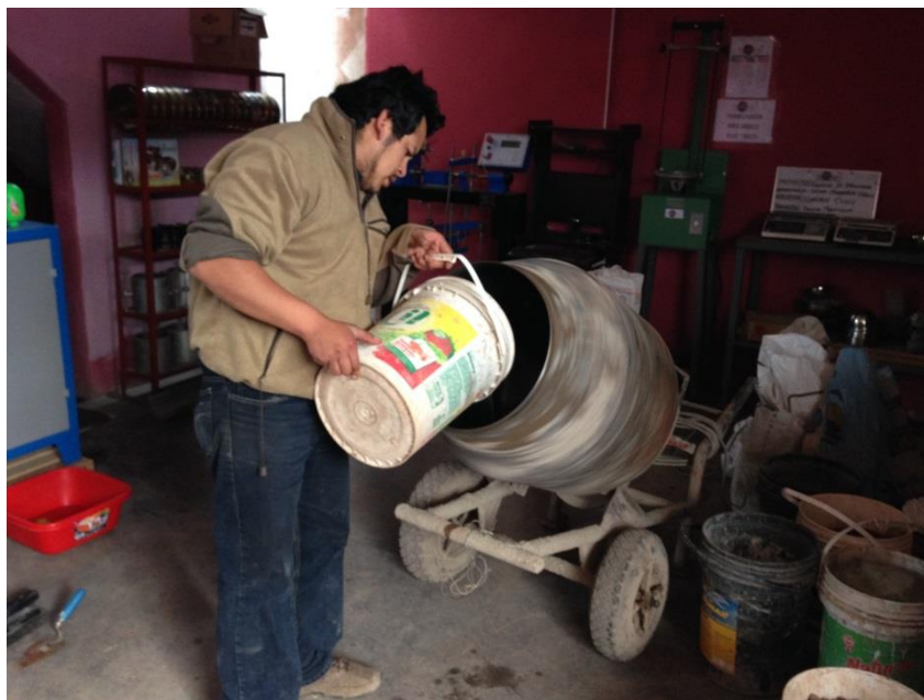
Adición de agua para la preparación de concreto
