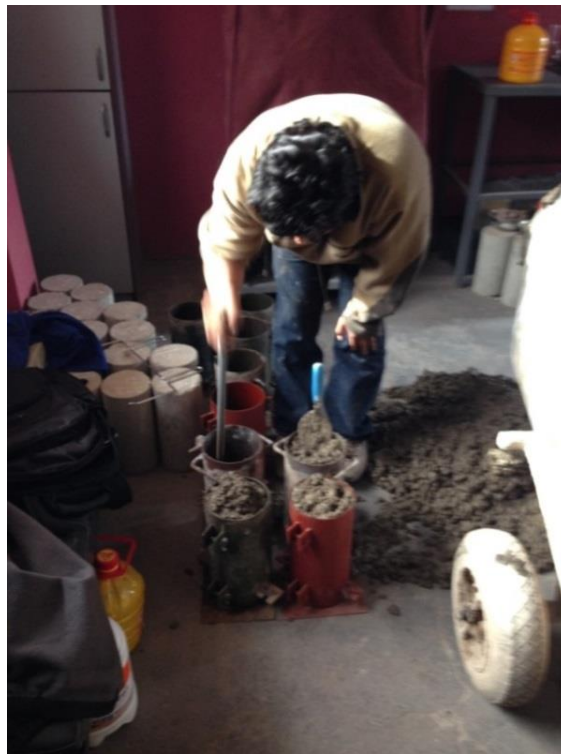
Colocación de la mezcla en los moldes (briquetas)
