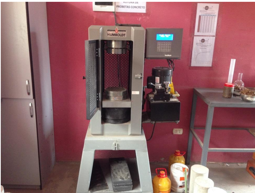
Prensa para ruptura de testigos de concreto (briquetas)
