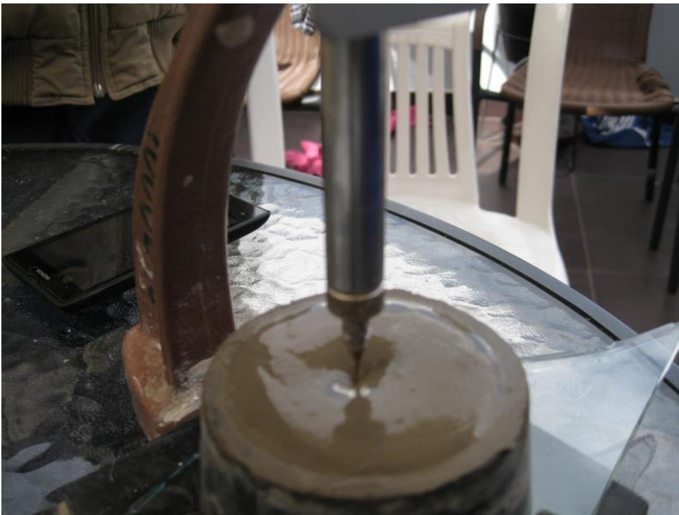
Se observa la penetración de la aguja de Vicat a la pasta
