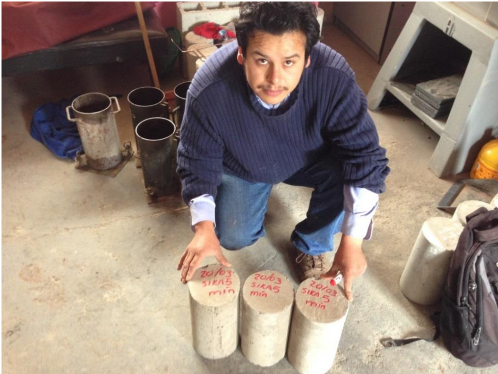
Desmoldado de los testigos de concreto
