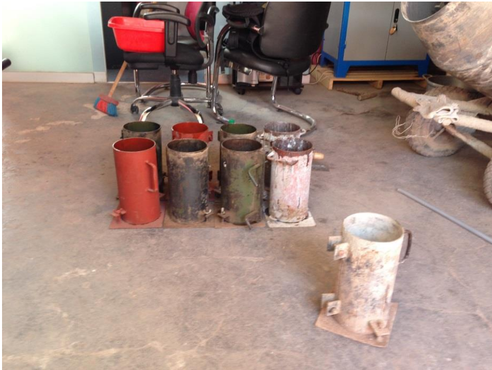
Preparación de moldes para testigos de concreto
