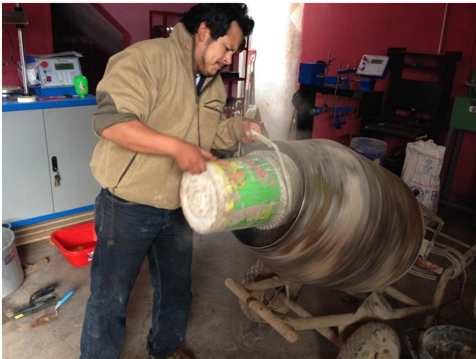
Adición del cemento al agua de amasado para la preparación del concreto
