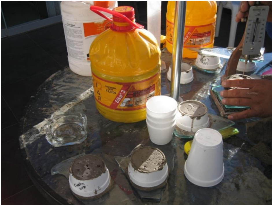
Aquí se observa los moldes con diferentes ensayos de penetración con la aguja de Vicat
