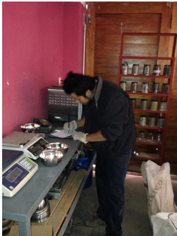
Toma de datos de humedad de los agregados
