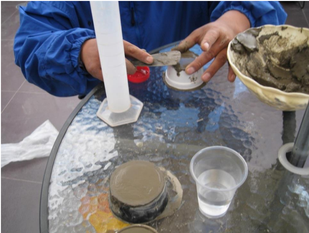
Colocación de la pasta de cemento a los molde de ensayo de penetración
