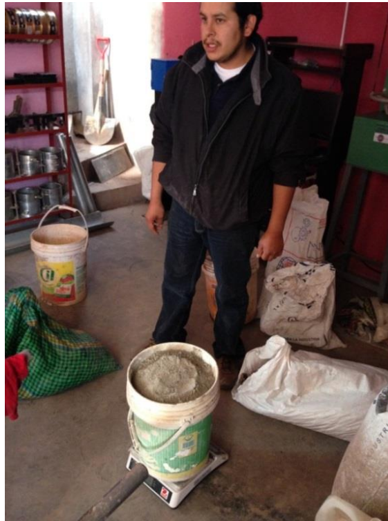
Pesaje de cemento para elaboración de concreto
