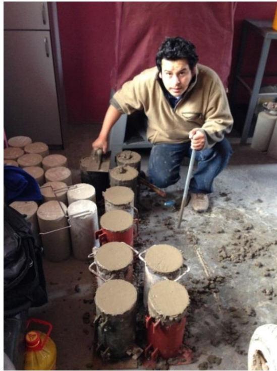
Moldeo del concreto fresco
