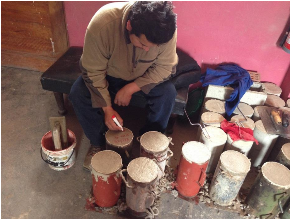
Identificación de los diferentes tipos de concreto
