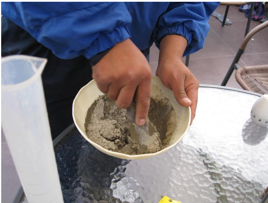
Amasado de la pasta de cemento con adición de aditivo acelerante
