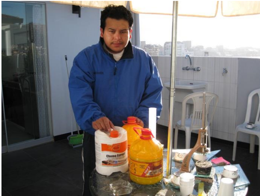
Tipos de aditivos acelerantes comerciales utilizados en el ensayo de penetración con la aguja de vicat
