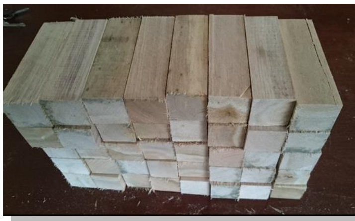
Figura N° 60: PROBETAS NORMALIZADAS DE MADERA DE EUCALIPTO GLOBULUS PARA EL ENSAYO DE DUREZA BRINELL
