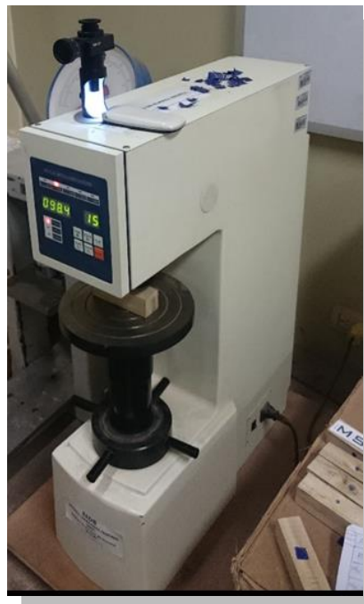
Figura N° 64: EQUIPO DE DUREZA BRINELL EN FUNCIONAMIENTO
