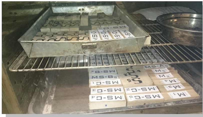
Figura N° 67: PROBETAS ENSAYADAS SECADAS EN EL HORNO ELÉCTRICO
