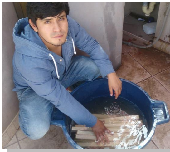
Figura N° 44: PROBETAS EN PROCESO DE SATURACIÓN PARA EL ENSAYO DE FLEXIÓN ESTÁTICA
