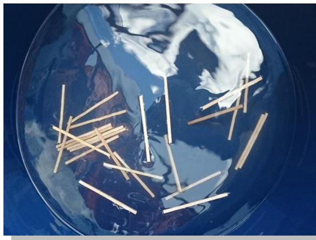
Figura N° 54: PROBETAS EN PROCESO DE SATURACIÓN PARA EL ENSAYO DE TRACCIÓN
