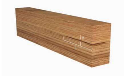
FIGURA N° 10: FORMA Y MEDICIÓN DE UNA ACEBOLLADURA.
