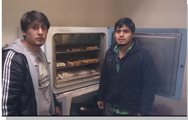
Figura N° 45: PROBETAS SECAS AL HORNO PARA EL ENSAYO DE FLEXIÓN ESTÁTICA
