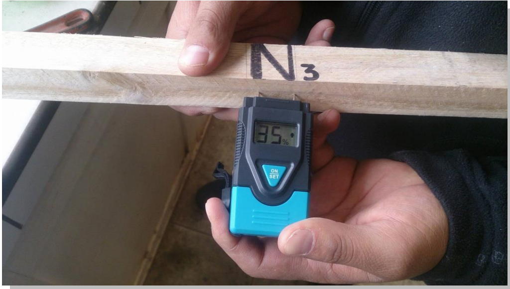
Figura N° 47: DETERMINACIÓN ELECTRÓNICA DEL CONTENIDO NATURAL DE HUMEDAD DE LA PROBETA
