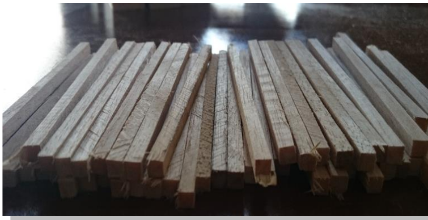
Figura N° 52: PROBETAS NORMALIZADAS PARA EL ENSAYO DE TRACCIÓN PARALELA AL GRANO
