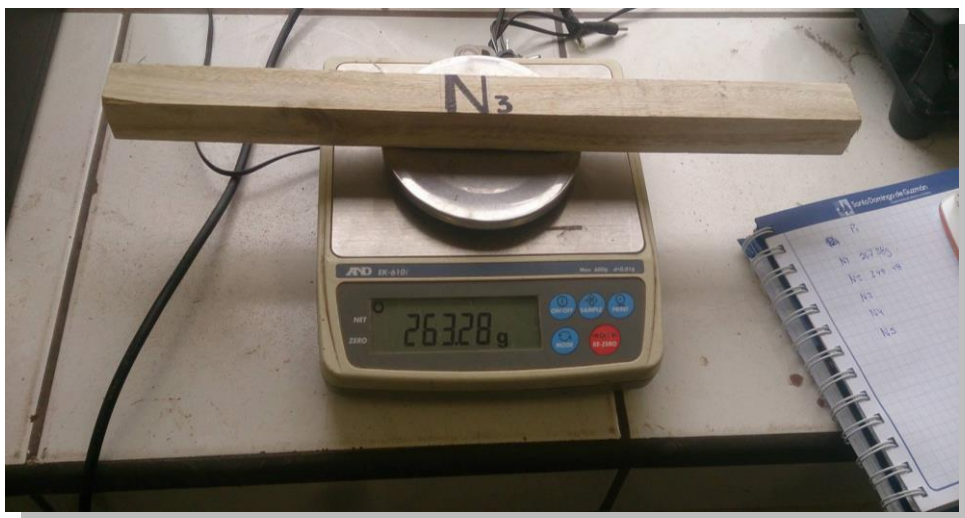
Figura N° 46: REGISTRO DEL PESO DE LA PROBETA
