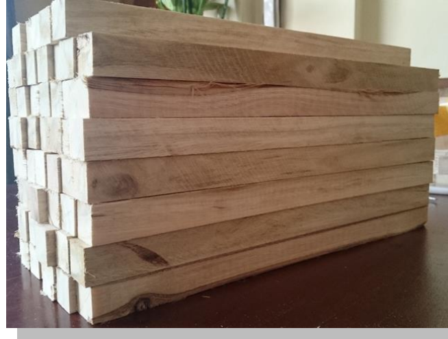
Figura N° 43: PROBETAS NORMALIZADAS PARA EL ENSAYO DE FLEXIÓN ESTÁTICA
