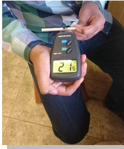
FIGURA N° 42: MEDICIÓN DEL PORCENTAJE DE HUMEDAD
