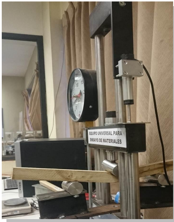
FIGURA N° 50: DEFLEXIÓN PRODUCIDA EN LA PROBETA
