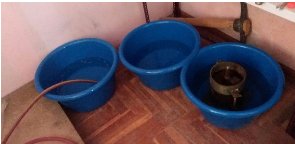
FIGURA N°34: Sumergido de los moldes de CBR
