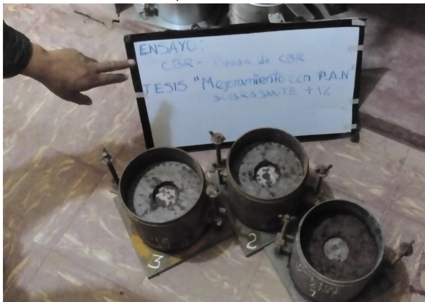
FIGURA N°37: Muestras de suelo de estrato arcilloso después del ensayo de penetración
