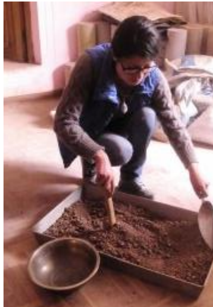
FIGURA N°29 Mezcla del suelo con de agua para ensayo de Proctor Modificado
