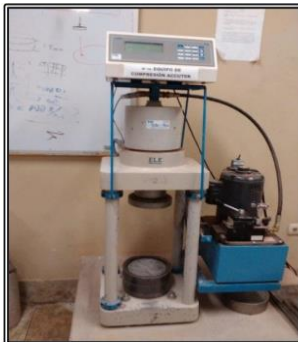
Fotografía 2: Equipo universal para ensayo a Compresión acondicionado para ensayos a flexión
