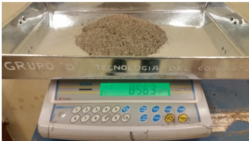
Fotografía 7: Peso de material retenido en los tamices
