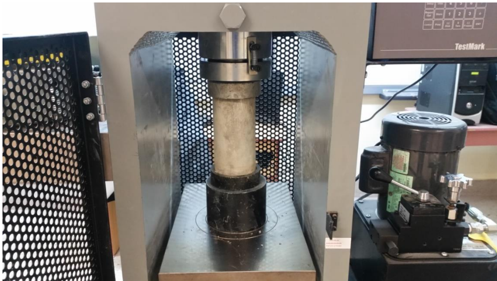
Fotografía 24: Rotura de especímenes cilíndricos de concreto (briquetas)
