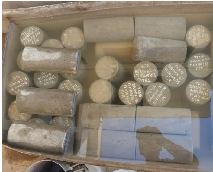
Fotografía 21: Curado de briquetas
