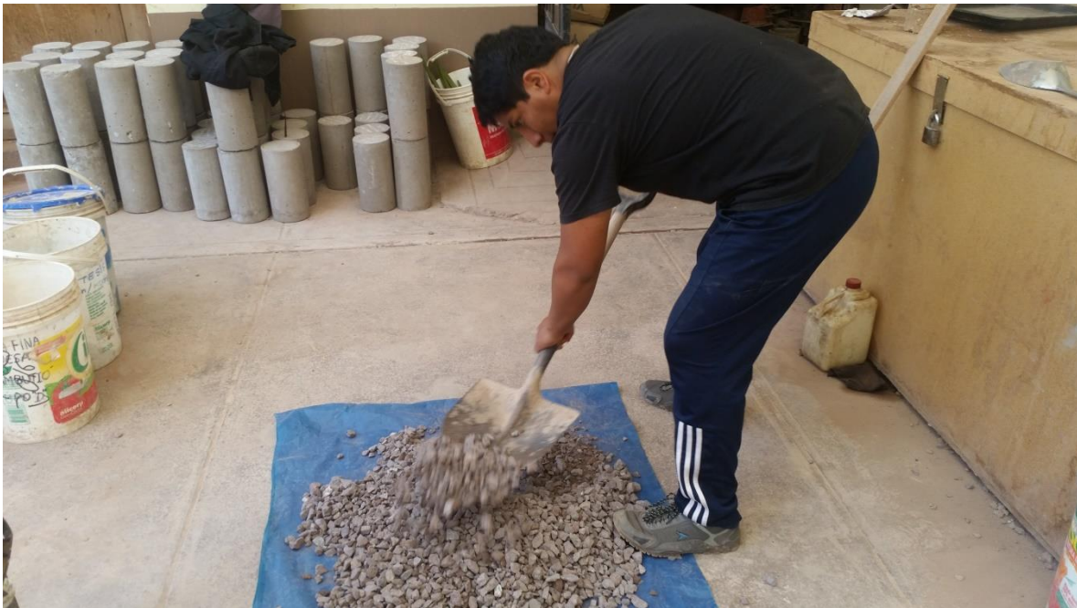
Fotografía 26: Cuarteo de material
