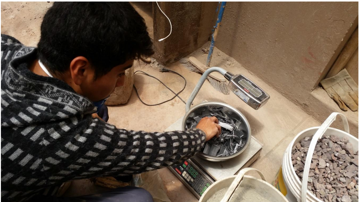
Fotografía 33: Preparado de materiales para vaciado – fibra de acero Dramix 3D
