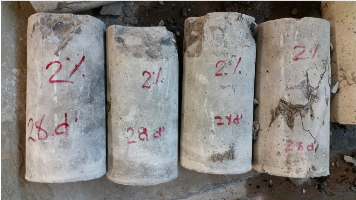
Fotografía 54: Fallas testigos cilíndricos con Dramix 3D al 2%
