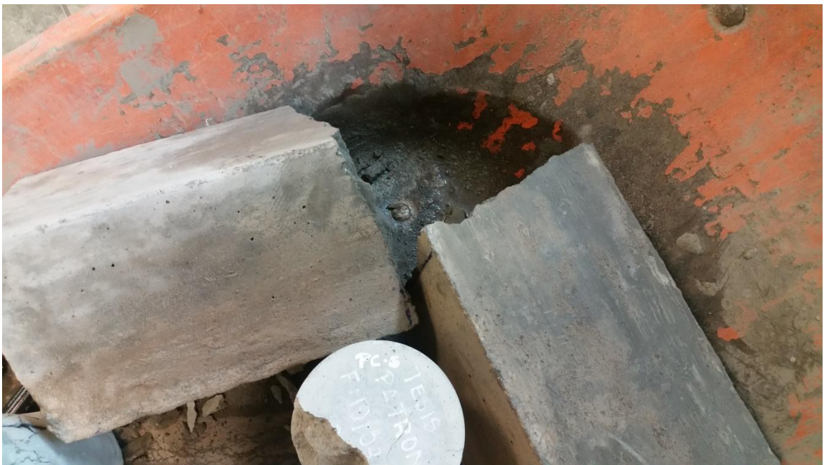
Fotografía 57: Falla a flexión concreto patrón
