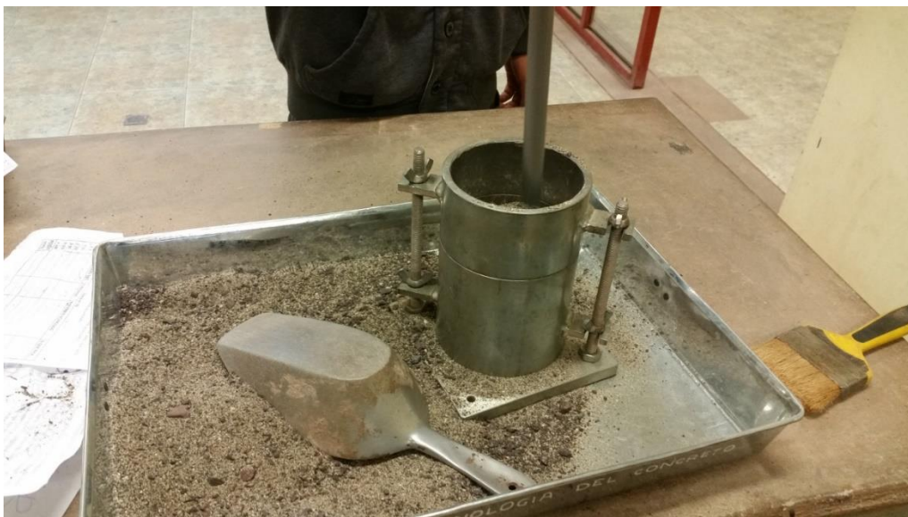
Fotografía 15: Compactado de material fino
