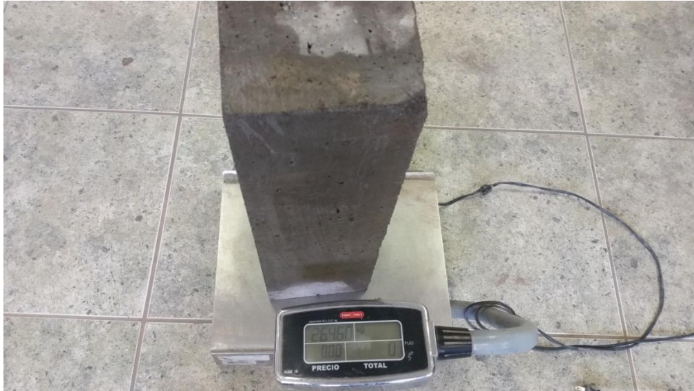
Fotografía 23: Pesado de viguetas
