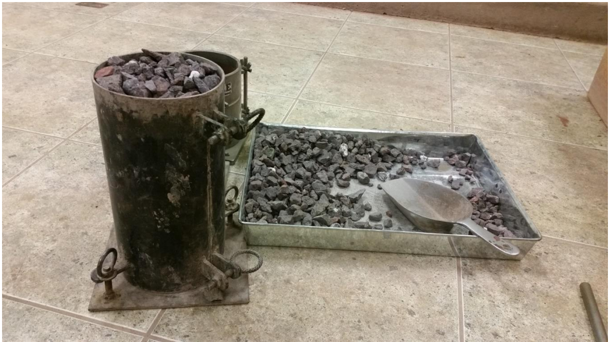
Fotografía 11: Enrasado de material grueso
