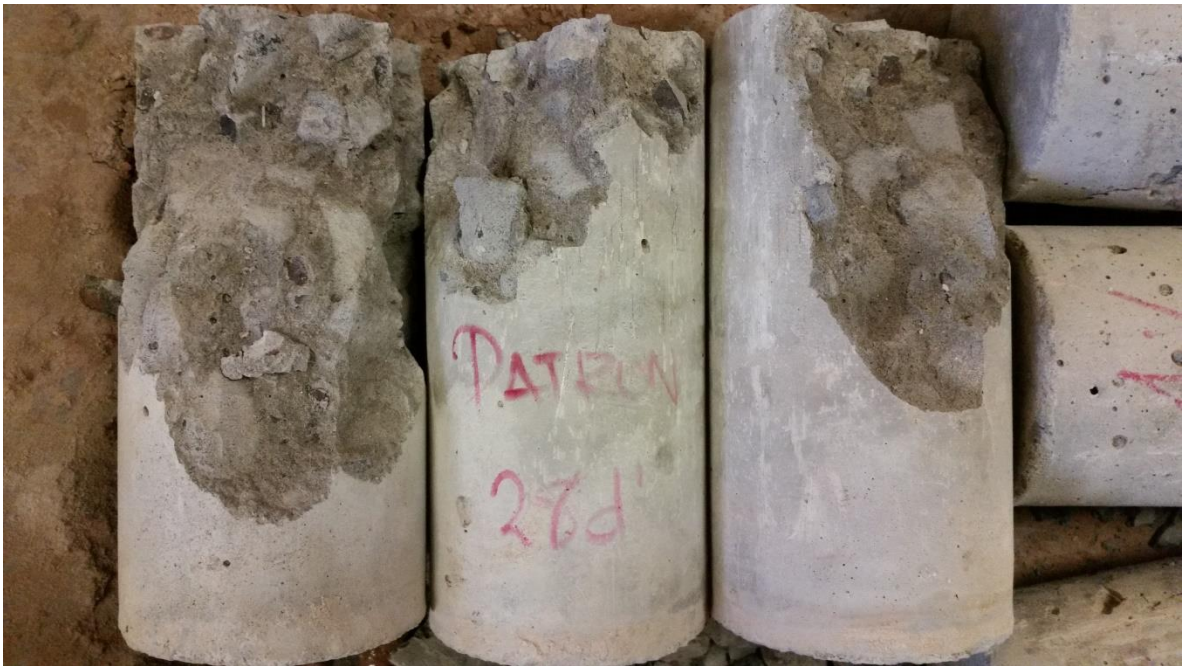
Fotografía 52: Fallas en testigos cilíndricos concreto Patrón
