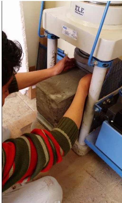
Fotografía 25: Rotura de especímenes prismáticos de concreto (viguetas)
