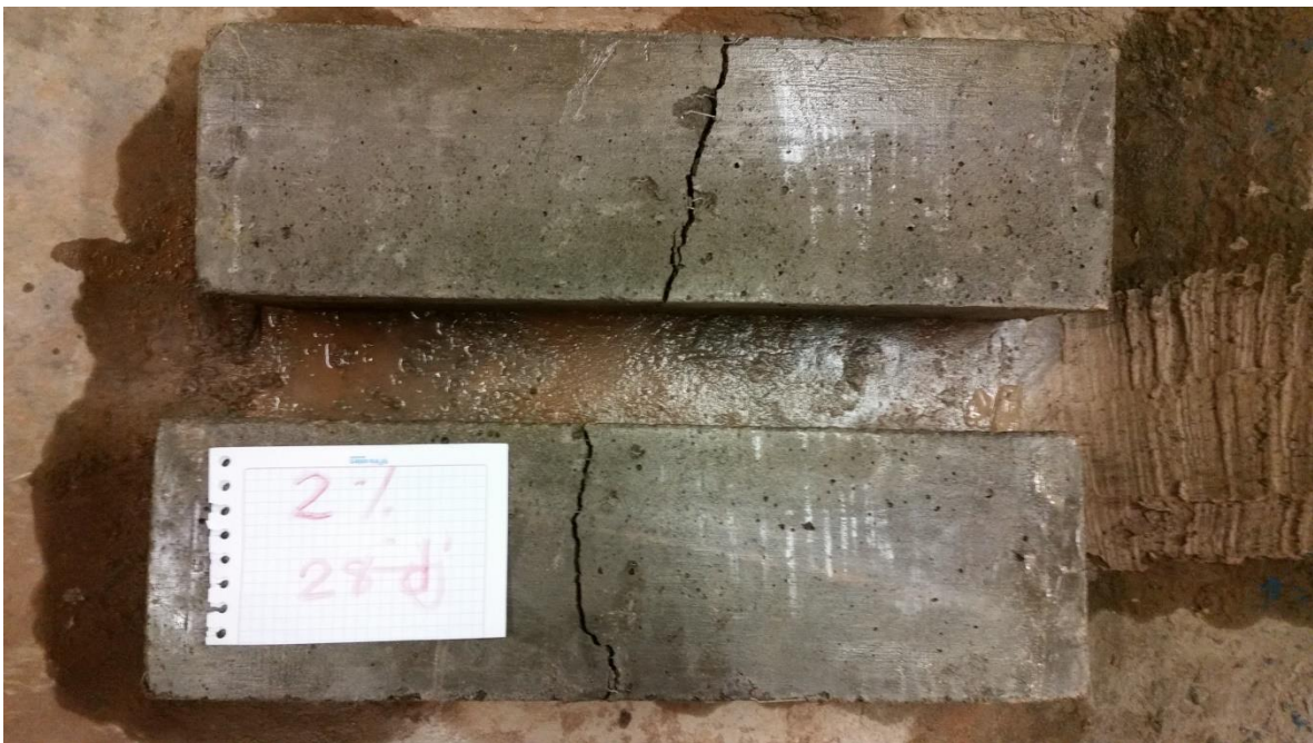
Fotografía 59: Falla a flexión concreto con Dramix 3D al 2%
