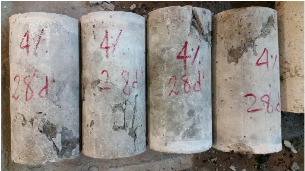
Fotografía 56: Fallas testigos cilíndricos con Dramix 3D al 4%
