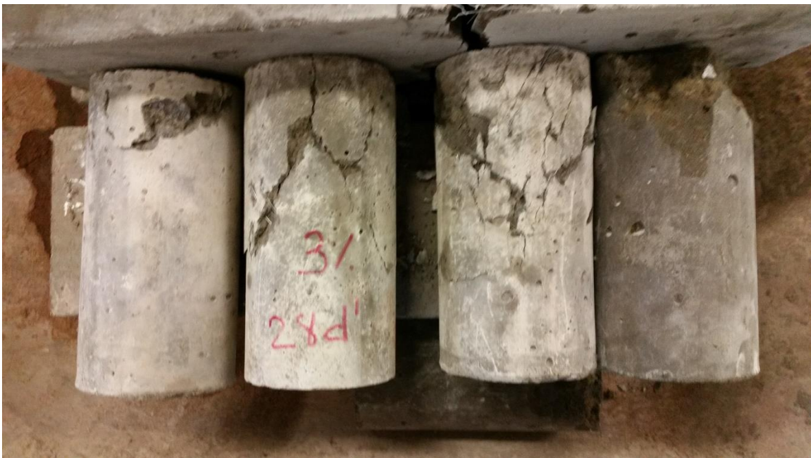
Fotografía 55: Fallas testigos cilíndricos con Dramix 3D al 3%
