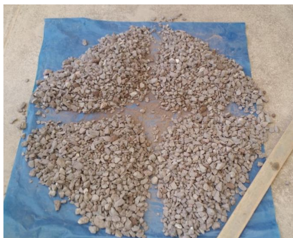
Fotografía 3: Cuarteo de material
