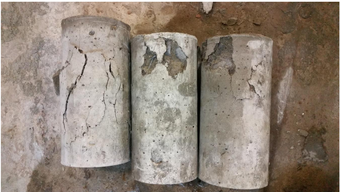
Fotografía 53: Fallas testigos cilíndricos con Dramix 3D al 1%
