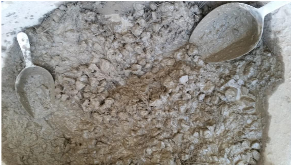
Fotografía 20: Elaboración concreto adicionado con fibras de acero Dramix 3D al 3%
