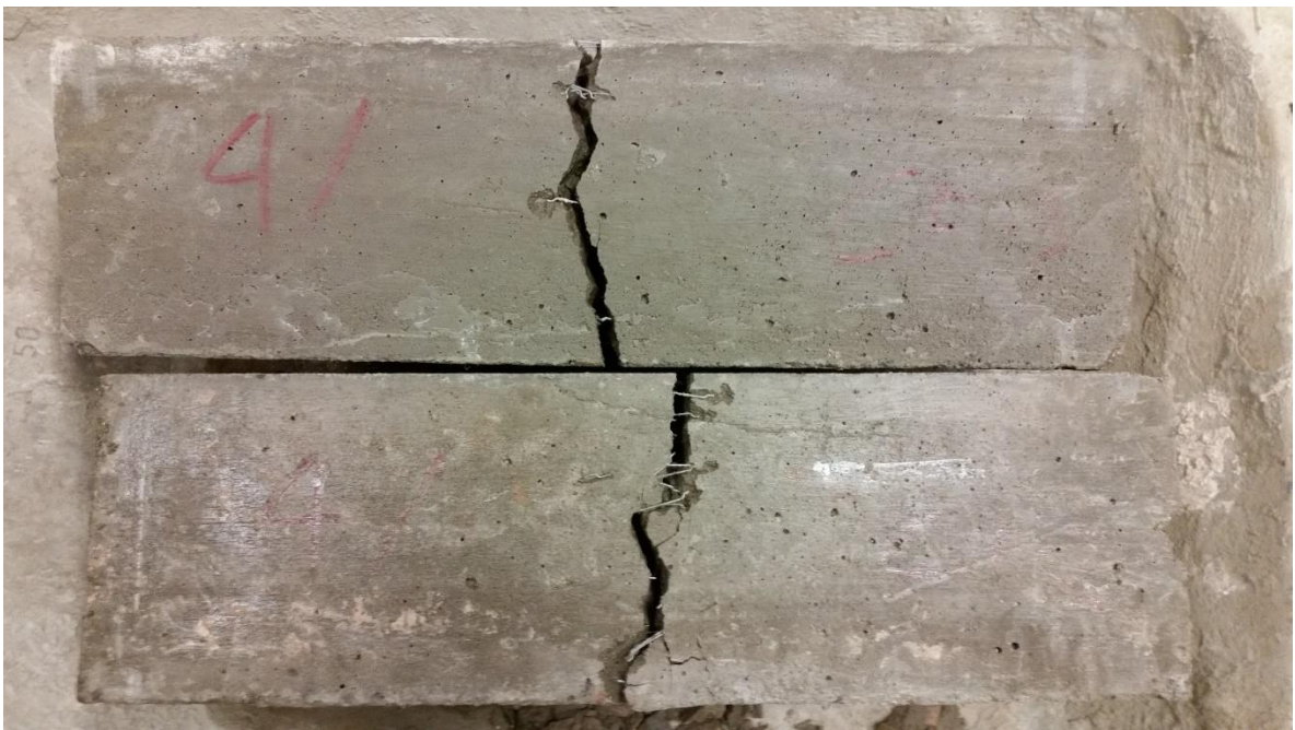
Fotografía 61: Falla a flexión concreto con Dramix 3D al 4%
