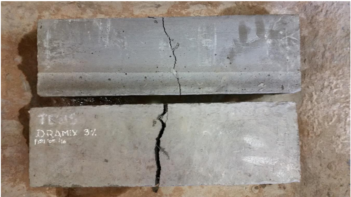
Fotografía 60: Falla a flexión concreto con Dramix 3D al 3%
