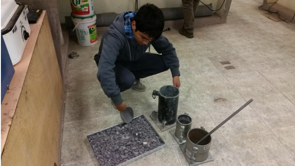
Fotografía 14: Compactado de material grueso
