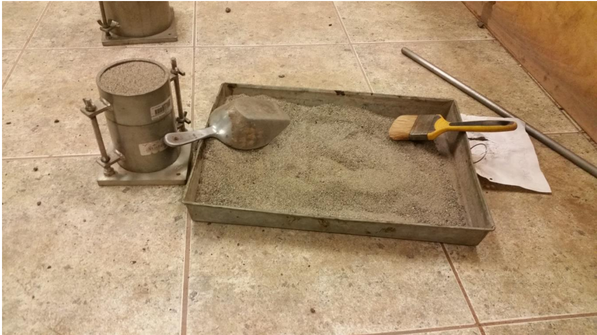
Fotografía 12: Preparado de material fino para enrase
