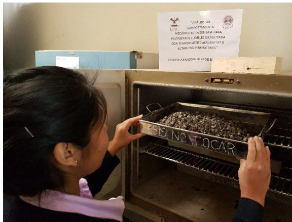
Figura 43: Ingreso del material lavado al horno
