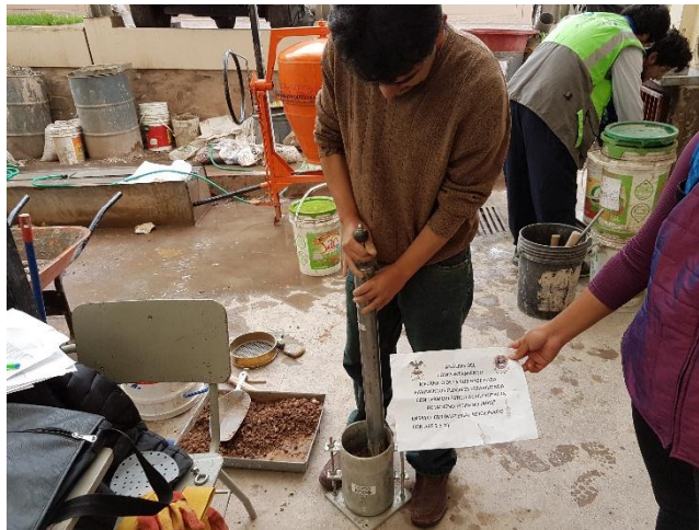
Figura 49: Compactación del material granular adicionado con el termoplástico ABS
