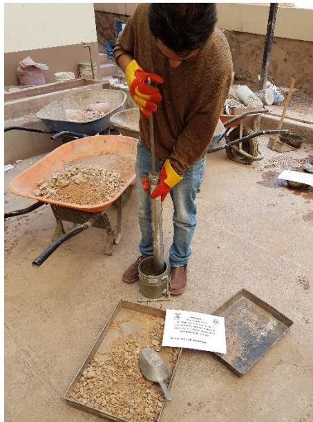
Figura 44: Compactación de las cinco capas, cada una por 56 golpes
