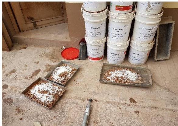
Figura 46: Material de granular adicionado con los porcentajes de 1.5%, 2.5% y 3.5% de ABS
