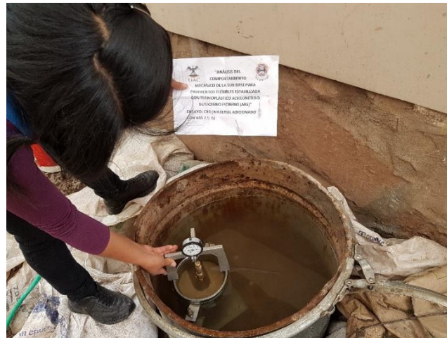
Figura 53: Colocación del dial (deformímetro) sobre los moldes CBR
