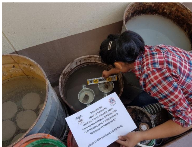
Figura 52: Nivelación de los moldes CBR después de su inmersión
