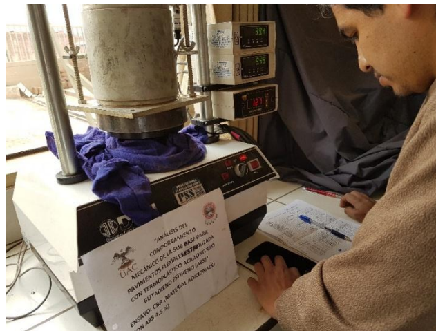
Figura 56: Penetración de los moldes CBR
