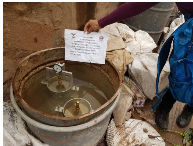
Figura 54: Moldes CBR sumergidos en agua
