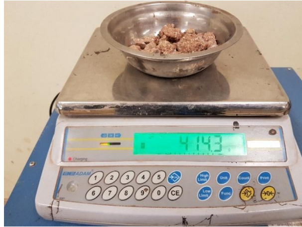
Figura 57: Registro de la muestra seca obtenida de los moldes penetrados
