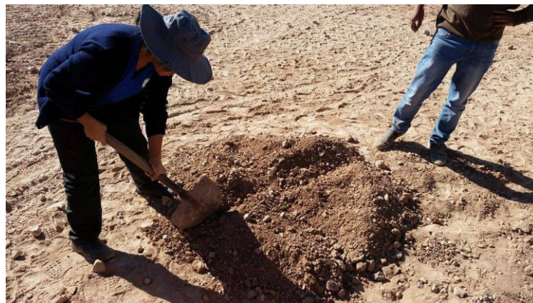
Figura 30: Cuarteo del material granular de la cantera de Quillahuata
