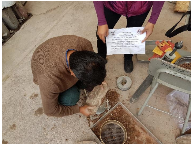
Figura 50: Enrasado de los moldes de CBR
