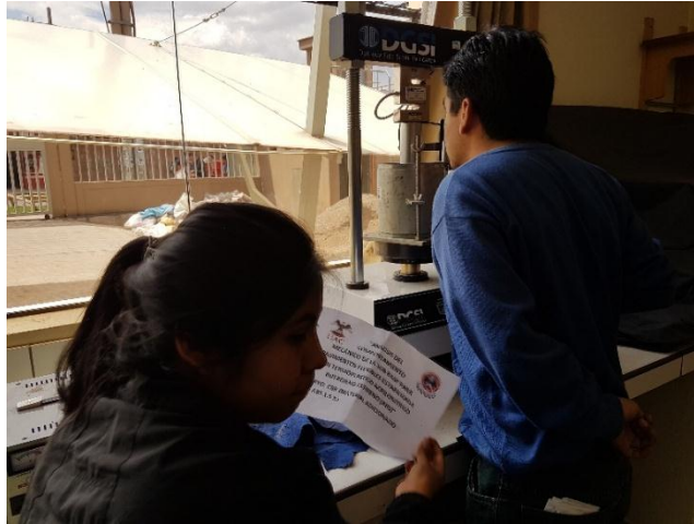
Figura 55: Colocación de los moldes CBR en la máquina de penetración
