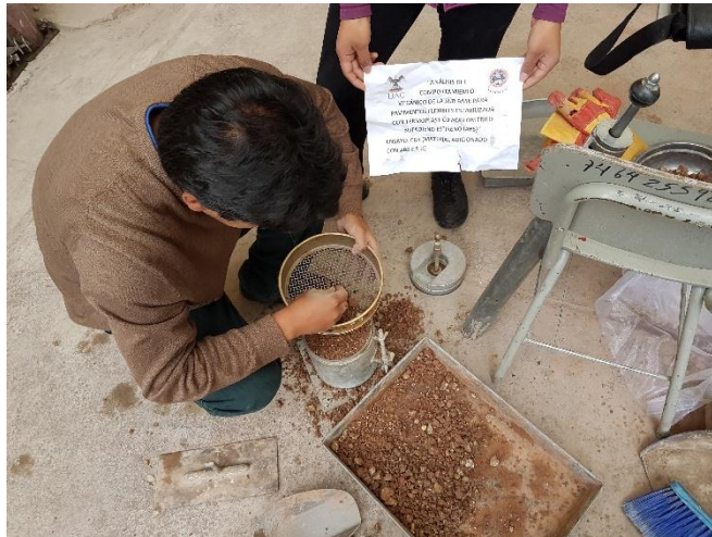
Figura 51: Tamizado del material sobrante para lograr una superficie uniforme
