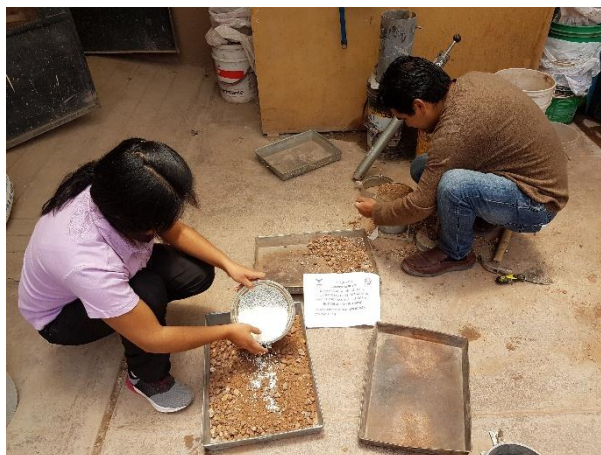
Figura 47: Adicionando 4.5% de ABS al material granular
