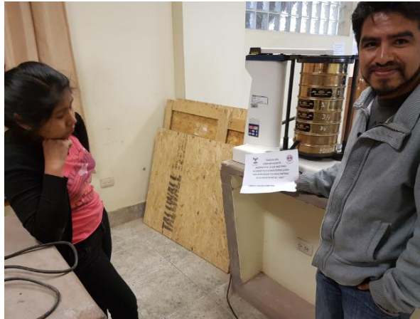
Figura 33: Tamizado mecánico del material
