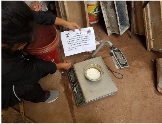
Figura 45: Registro del peso del termoplástico ABS que ingresará a cada molde
