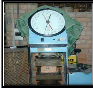
FIG. N° 23 DESCRIPCIÓN: Ensayo de compresión de unidades.
