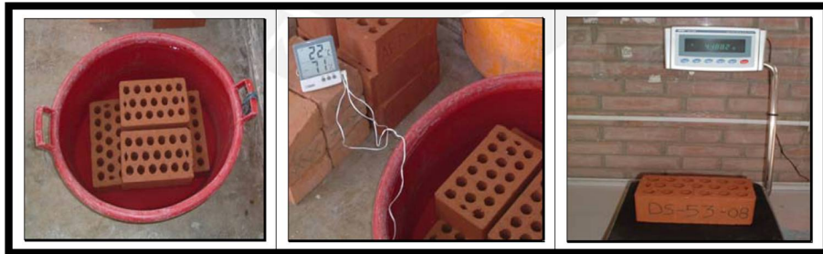
FIG. N° 27 DESCRIPCIÓN: Procedimiento de medición de absorción de las unds.
