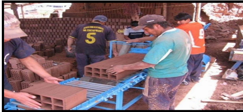
FIG. N° 18 DESCRIPCIÓN: Fabricación de unidades de arcilla.
