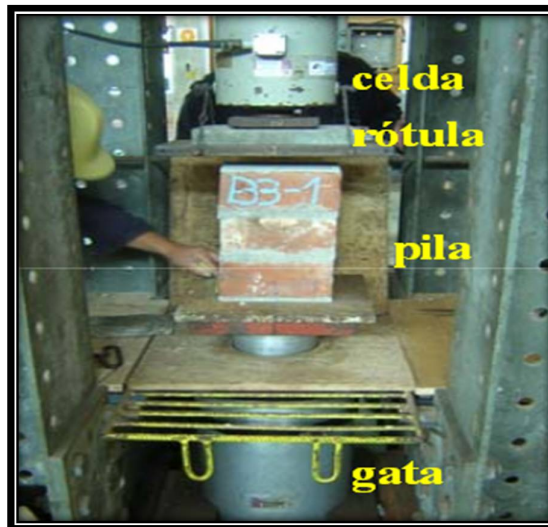
FIG. N° 32 DESCRIPCIÓN: Equipos en el ensayo de compresión.
