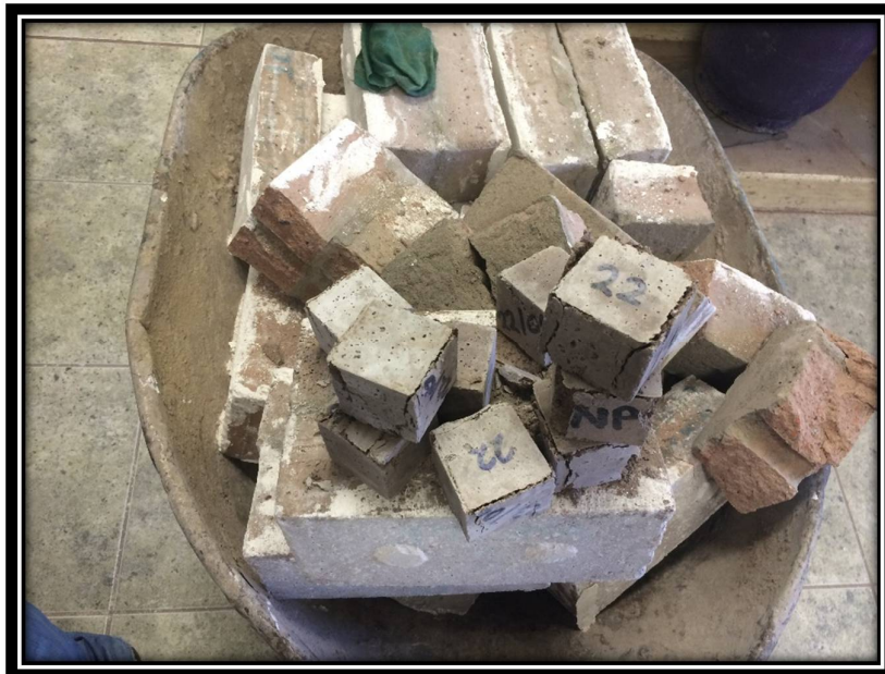
FOTOGRAFÍA N° 56: CUBOS DE MORTERO NP Y P2 DESPUES DE HABER SIDO ENSAYADOS A COMPRESIÓN
