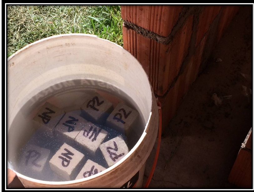
FOTOGRAFÍA N° 55: CURADO DE CUBOS DE MORTERO TIPO NP Y P2
