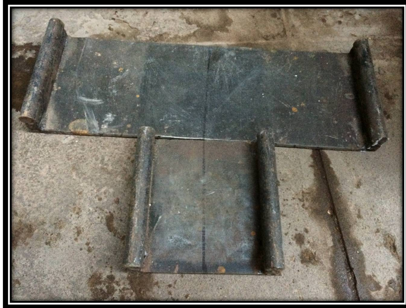
FOTOGRAFÍA N° 51: SOPORTE BASE Y SOPORTE DE CARGA PARA EL ENSAYO DE RESISTENCIA A FLEXIÓN POR ADHERENCIA
