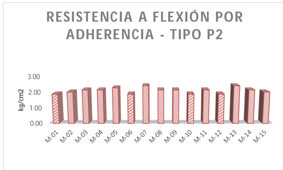
ILUSTRACIÓN N°13: DIAGRAMA DE LA RESISTENCIA A FLEXIÓN POR ADHERENCIA PARA MORTERO TIPO P2
