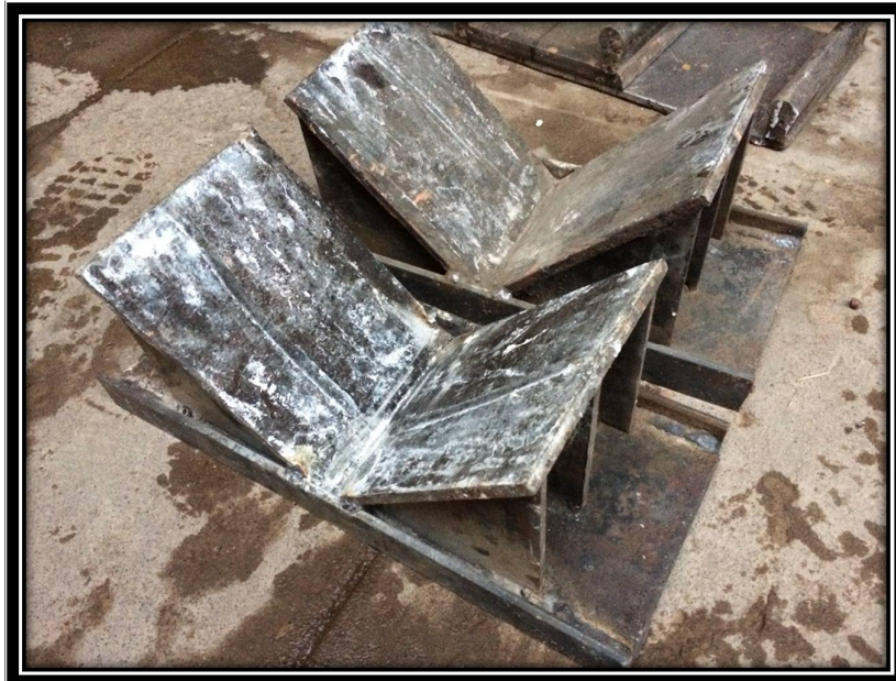
FOTOGRAFÍA N° 52: ESCUADRAS DE CARGA PARA EL ENSAYO DE RESISTENCIA A COMPRESIÓN DIAGONAL
