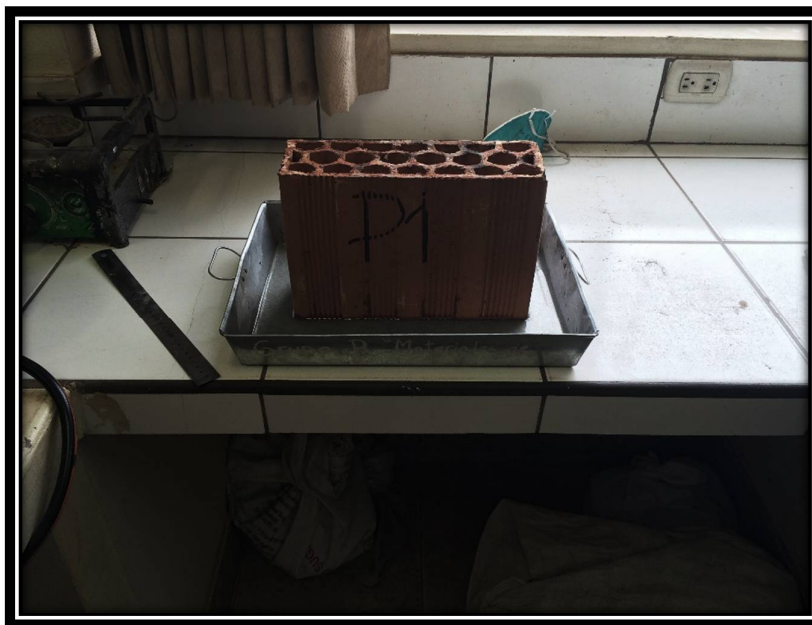
FOTOGRAFÍA N° 16: LADRILLO TIPO BLOCKER SUMERGIDO A UNA PROFUNDIDAD DE 3\text{MM} \pm 0.25\text{MM}
