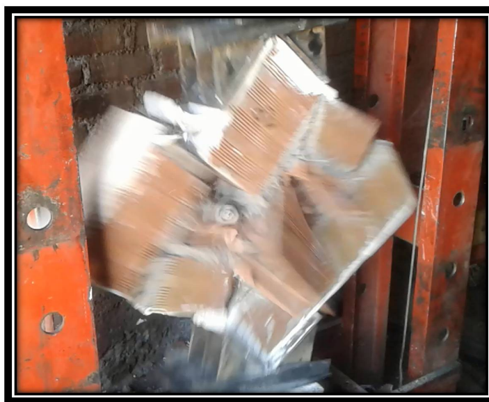
FOTOGRAFÍA N° 50: FALLA EN EL ESPÉCIMEN (MURETE DE ALBAÑILERIA), CON MORTERO TIPO P2, FALLA DE MANERA EXPLOSIVA
