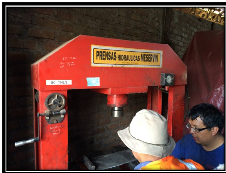
FOTOGRAFÍA N° 32: PREPARACIÓN DEL EQUIPO DE ENSAYO Y COLOCACIÓN DE SOPORTES DE APOYO
