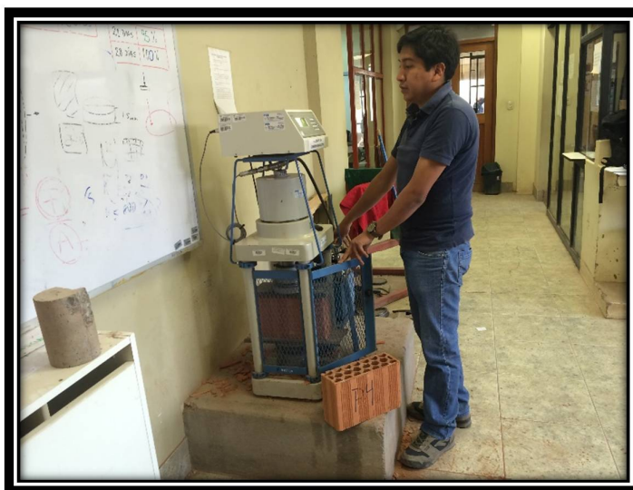
FOTOGRAFÍA N° 19: APLICACIÓN DE CARGA SOBRE EL PRISMA(Unidad de Albañilería)
