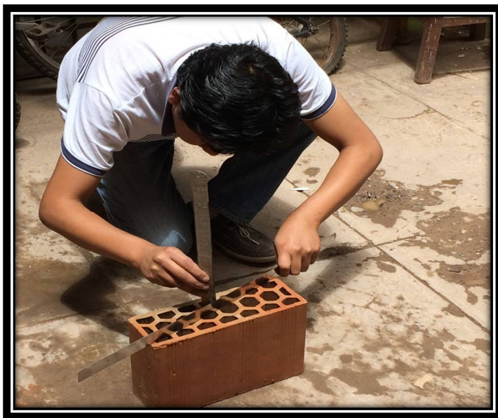
FOTOGRAFÍA N° 14: MEDICIÓN DE ALABEO DE LA UNIDAD (CONCAVIDAD)
