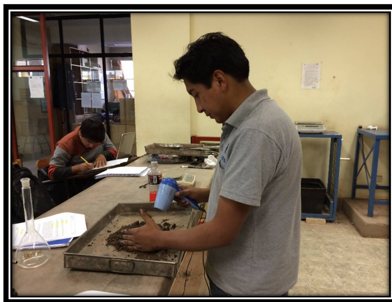
FOTOGRAFÍA N° 07: SECANDO LA MUESTRA SUPERFICIALMENTE SECO
