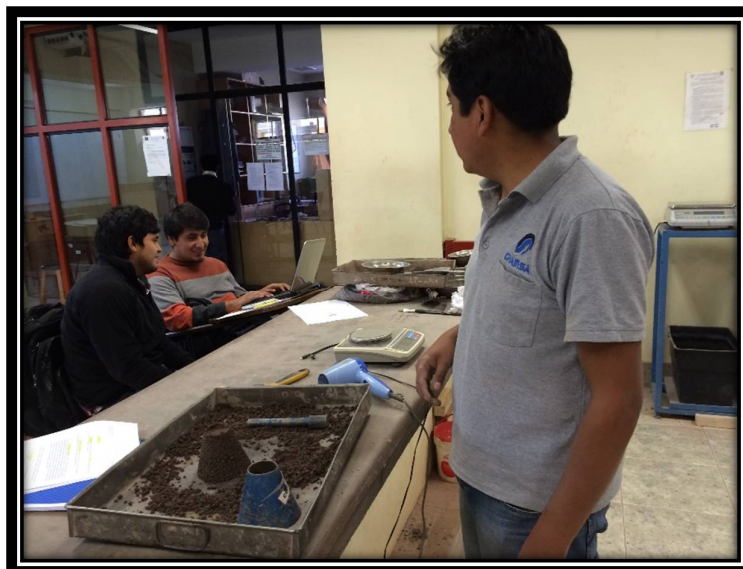
FOTOGRAFÍA N° 09: DESPUÉS DE HABER APISONADO LA MUESTRA CON 25 GOLES, RETIRAMOS EL CONO Y VERIFICAMOS QUE TAN HUMEDO ESTA LA MUESTRA
