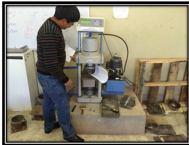
FOTOGRAFÍA N° 26: VERIFICANDO QUE EL ESPECIMEN DE MORTERO ESTE BIEN UBICADO
