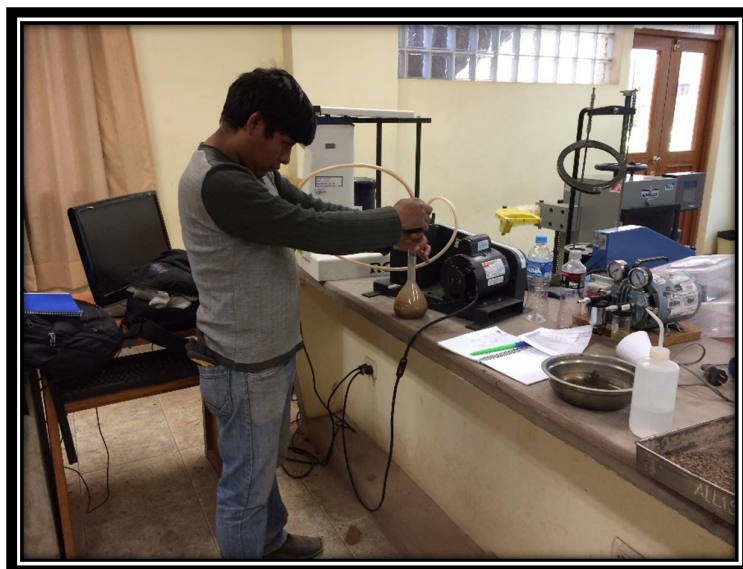
FOTOGRAFÍA N° 10: EXTRAYENDO EL AIRE ATRAPADO EN LA FIOLA QUE ESTA CON MATERIAL Y AGUA.
