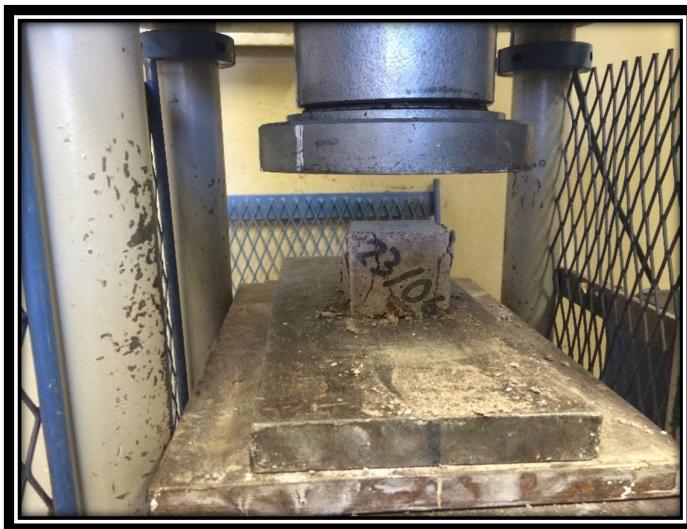
FOTOGRAFÍA N° 27: ESPÉCIMEN DE MORTERO DESPUES DE REALIZADO LA PRUEBA
