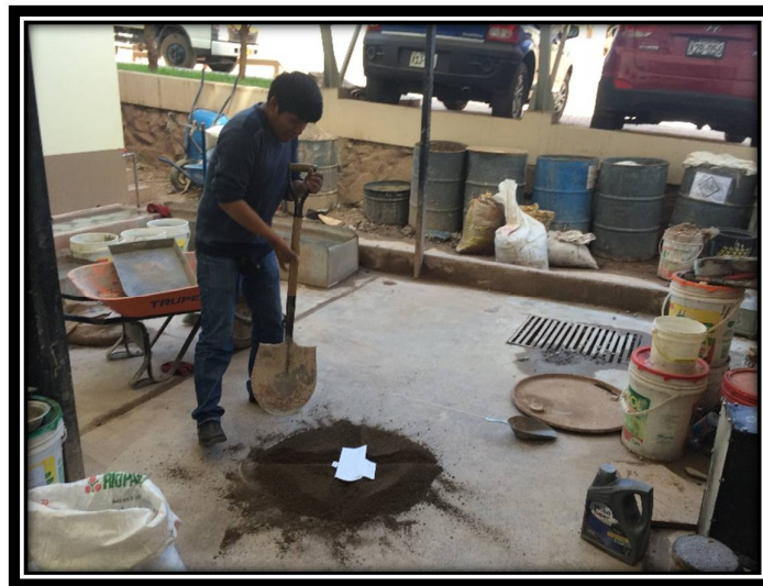
FOTOGRAFÍA N° 01: CUARTEANDO EL AGREGADO FINO (CANTERA HUILLQUE)
