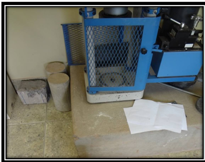
FOTOGRAFÍA N° 18: PREPARANDO LA MÁQUINA DE COMPRESIÓN AXIAL
