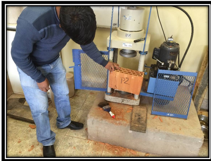
FOTOGRAFÍA N° 20: RETIRANDO EL PRISMA DESPUES DE REALIZADO EL ENSAYO Y REGISTRANDO LA FALLA EN LA UNIDAD
