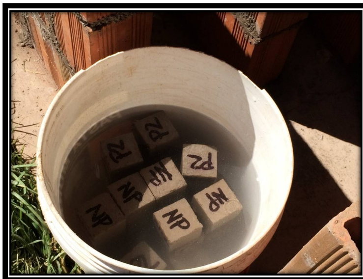
FOTOGRAFÍA N° 23: PROCESO DE CURADO DE CUBOS DE MORTERO
