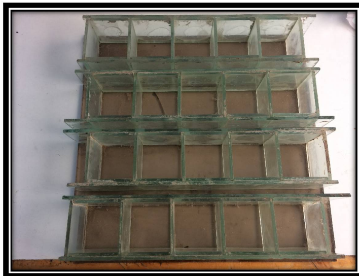
FOTOGRAFÍA N° 22: PREPARACIÓN DE LOS MOLDES DE CUBOS DE MORTERO
