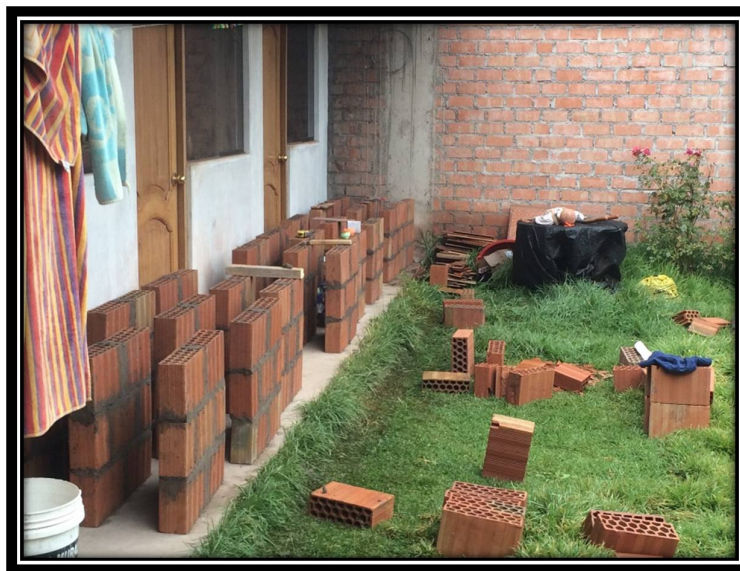
FOTOGRAFÍA N° 46: VISTA DE UNA PARTE DE LOS ESPECÍMENES (MURETES DE ALBAÑILERIA)
