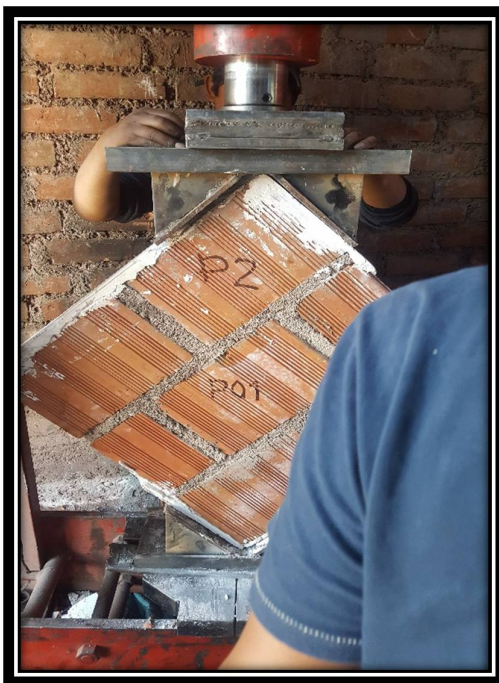
FOTOGRAFÍA N° 47: PREPARACIÓN DEL ESPECIMEN (MURETE DE ALBAÑILERIA), COLOCADO AMBAS ESCUADRAS Y CENTRANDO HACIA EL EJE QUE EJERCERA FUERZA
