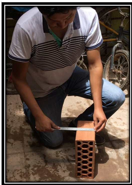
FOTOGRAFÍA N° 12: MEDICIÓN DE LA BASE O ESPESOR DE LA UNIDAD
