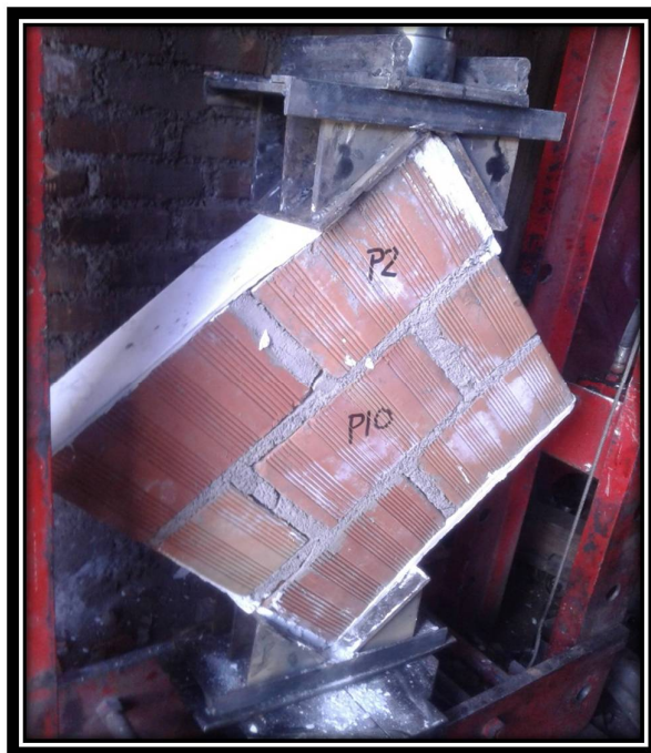
FOTOGRAFÍA N° 48: ESPÉCIMEN DESPUES DE HABER SIDO ENSAYADO, FALLA EN LA JUNTA
