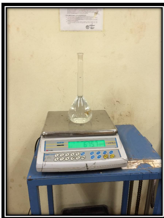
FOTOGRAFÍA N° 08: PESANDO DEL AGUA LUEGO DE HABER SIDO SACADO EL AIRE ATRAPADO
