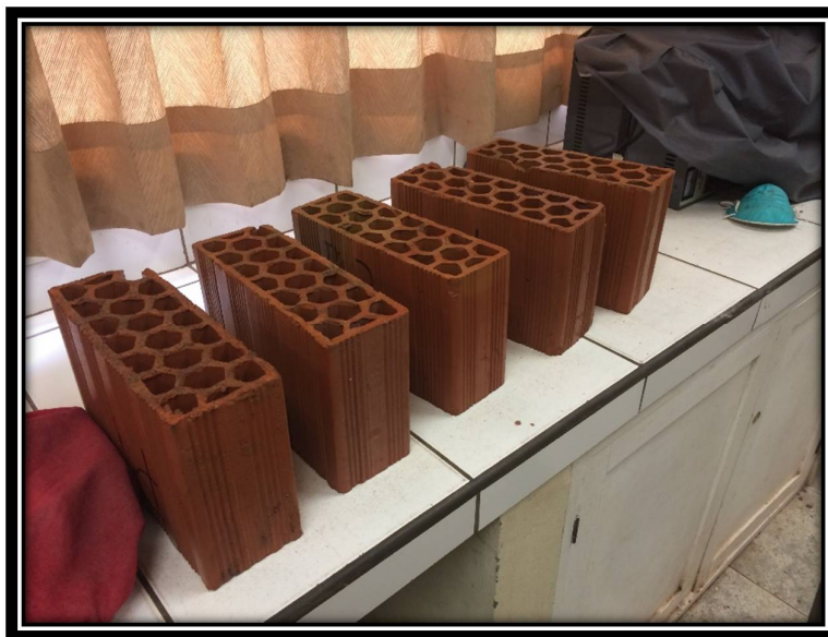
FOTOGRAFÍA N° 17: LADRILLO TIPO BLOCKER LUEGO DE HABER SIDO SUMERGIDO DURANTE 24 HRS
