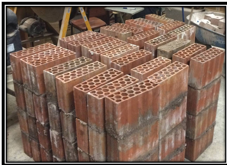
FOTOGRAFÍA N° 31: PREPARACIÓN DE ESPECIMENES DE ENSAYO (PRISMAS), PARA EL ENSAYO DE FLEXIÓN POR ADHERENCIA
