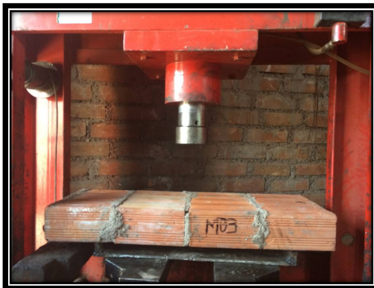
FOTOGRAFÍA N° 33: COLOCACIÓN DEL ESPÉCIMEN (PRISMA) SOBRE LOS RODOS DE APOYO, PREVIO A SER SOMETIDO A CARGA
