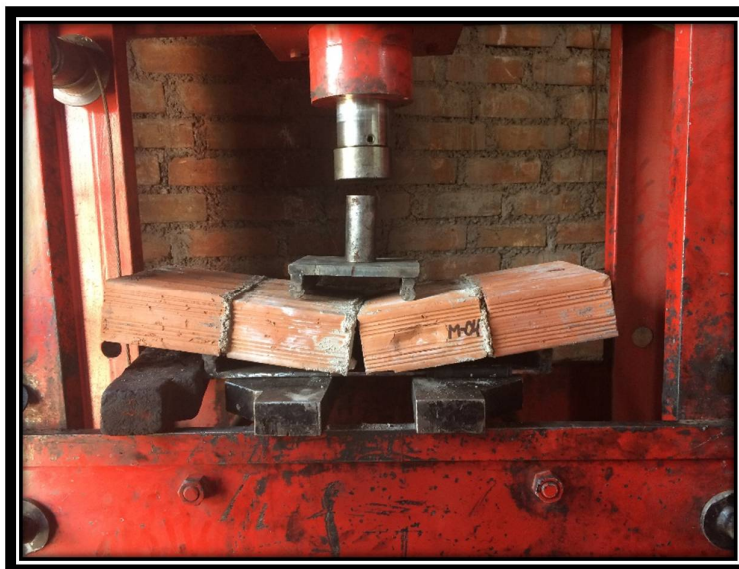
FOTOGRAFÍA N° 34: OBTENCIÓN DEL ESPECIMEN (PRISMA) DESPUES DE HABER SIDO SOMETIDO A CARGA
