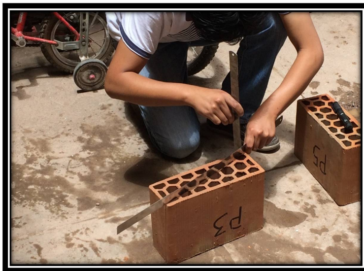
FOTOGRAFÍA N° 15: MEDICIÓN DE ALABEO DE LA UNIDAD (CONVEXIDAD)
