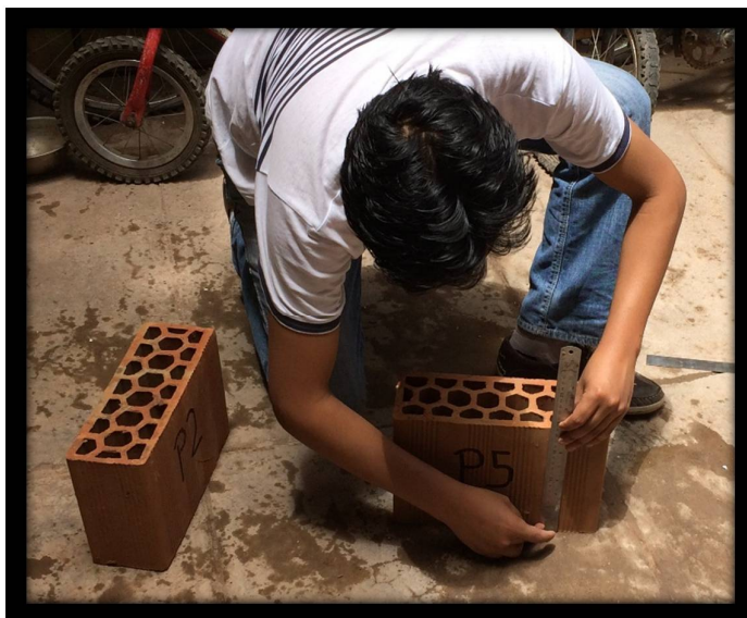
FOTOGRAFÍA N° 11: MEDICIÓN DE LA ALTURA DE LA UNIDAD
