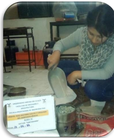
Figura 76 . Llenado correcto del material grueso
