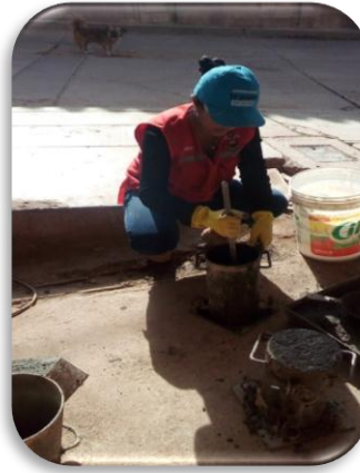
Figura 97. Proceso de moldeo de concreto con agregado hormigón
