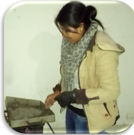
Figura 52. Proceso de secado de muestras mediante calentador para obtener masa constante.
