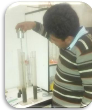
Figura 86. Proceso de colocación del sobrepeso
