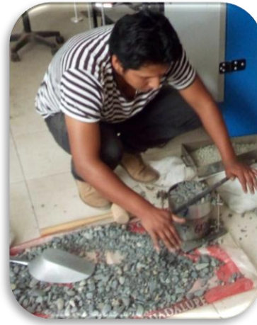
Figura 77 . Enrasado del material grueso
