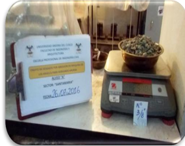
Figura 65. Registro inicial de muestra seca
