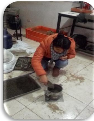
Figura 78. Llenado de material fino
