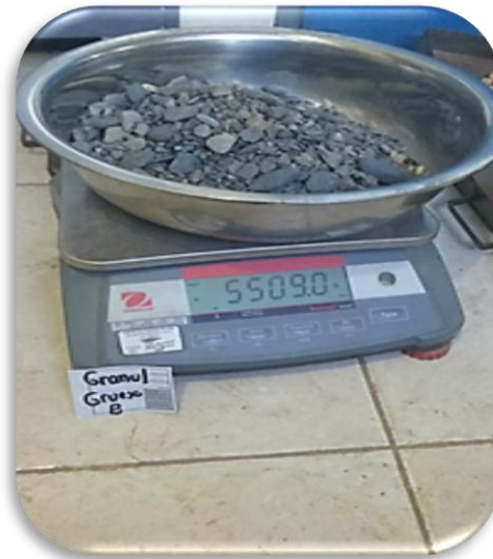
Figura 54. Muestra seca antes de ser tamizado del agregado grueso álveo “P” Paqcha Uchumayo.
