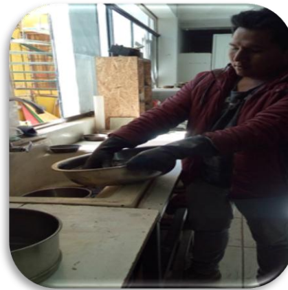
Figura 53 . Proceso de lavado de muestras mediante tamiz n° 200
