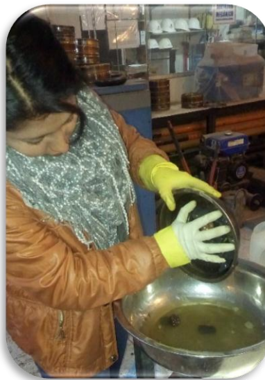
Figura 90 : Proceso de decantación del sulfato de magnesio
