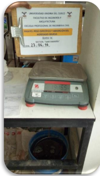
Figura 75. Muestra sumergida del agregado grueso
