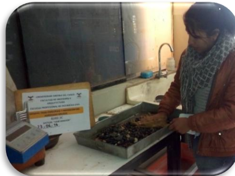
Figura 74. Proceso de secado superficial del agregado grueso
