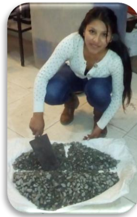
Figura 72. Cuarteo del material
