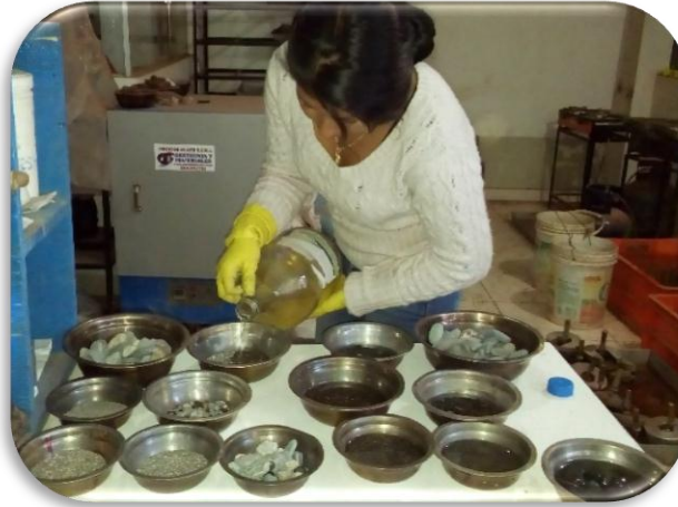
Figura 89 . Sumersión de la solución a las muestras
