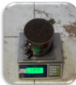
Figura 79. Peso de muestra final
