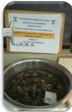
Figura 73 : Muestra sumergida del agregado grueso
