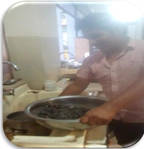
**Figura 46 .** Proceso de lavado de muestra seca final agregado grueso
