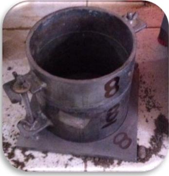
**Figura 15.** Molde cilíndrico
