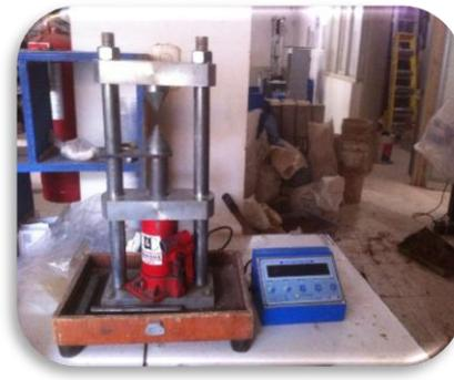
*Figura 22:* Máquina de compresión manual
