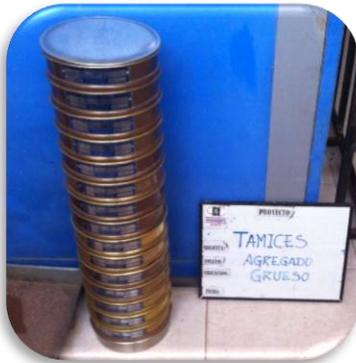
**Figura 35 .** Tamices de tamices para el agregado grueso
