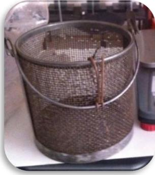
**Figura 26 :** Cesta con malla de alambre con abertura correspondiente al tamiz nro. 4
