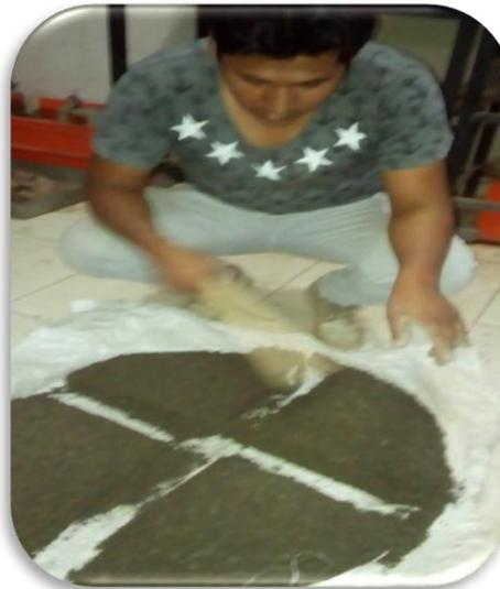
*Figura 51*. Proceso de cuarteo en cuatro partes iguales del agregado fino
