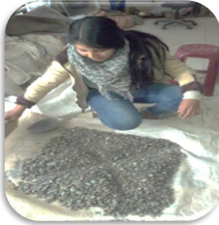
*Figura 50* . Proceso de cuarteo en cuatro partes iguales del agregado grueso
