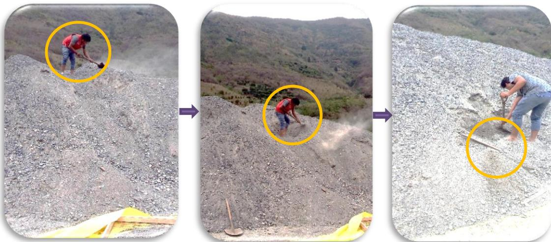
**Figura 42** : Proceso de muestreo de agregados en campo
