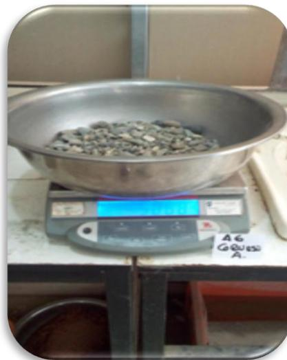
**Figura 47 .** Proceso de pesado de muestra seca final agregado grueso
