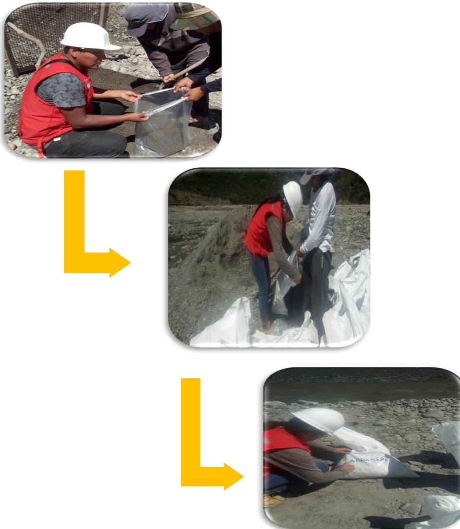
**Figura 43 :** Proceso de almacenamiento de muestra de campo para el envío al laboratorio.
