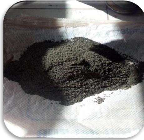
**Figura 48 .** Muestra de agregado fino en lugar limpio
