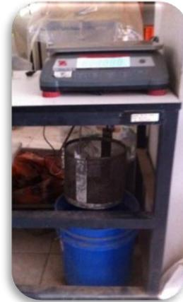
**Figura 18.** Equipo para peso específico
