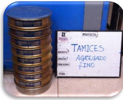
**Figura 32 .** Tamices del agregado fino
