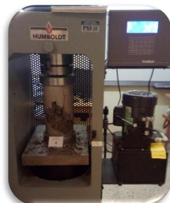
**Figura 37 .** Máquina compresora
