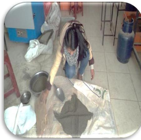
*Figura 45.* Proceso de cuarteo muestra agregado fino
