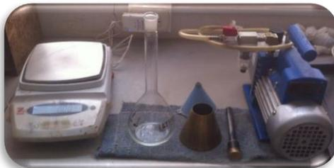
**Figura 29 .** Materiales para ensayo de peso específico agregado fino
