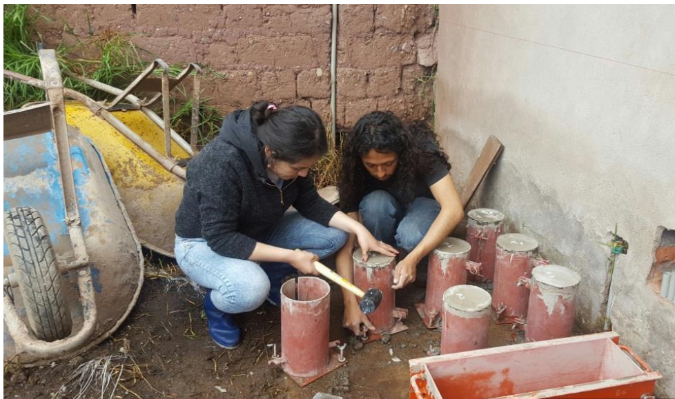
ENCOFRADO Y DESENCOFRADO DE BRIQUETAS
