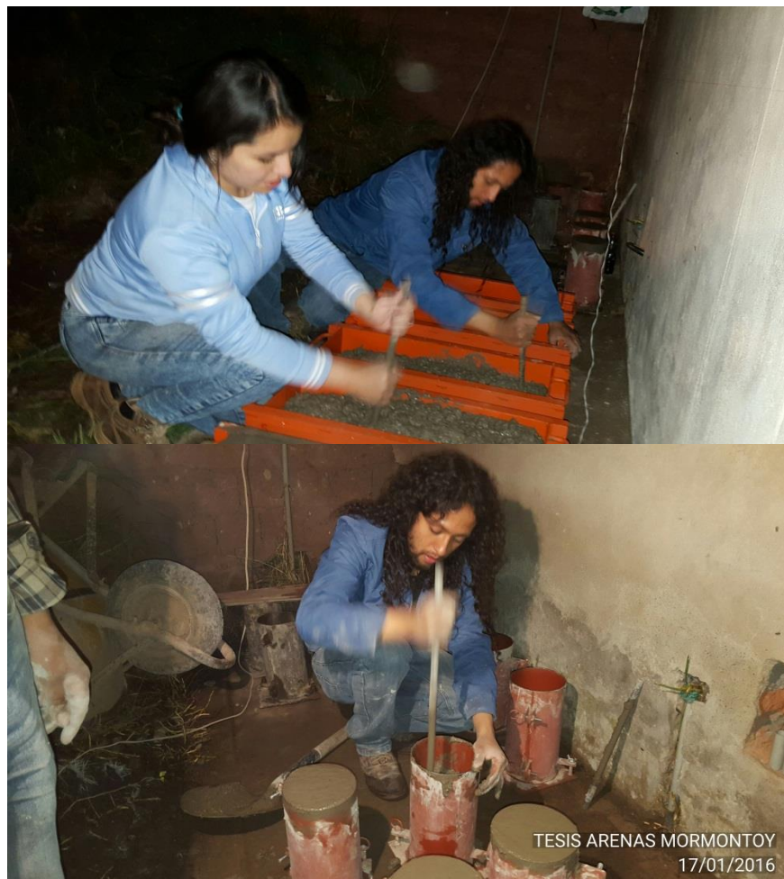
VARILLADO DE BRIQUETAS Y VIGUETAS DE CONCRETO
