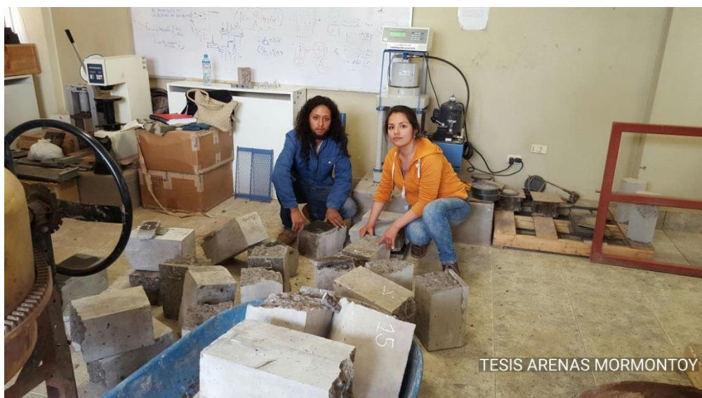
VIGUETAS CON PIEDRA EMBEBIDA DE 1 1/2", SOMETIDAS AL ENSAYO A FLEXIÓN
