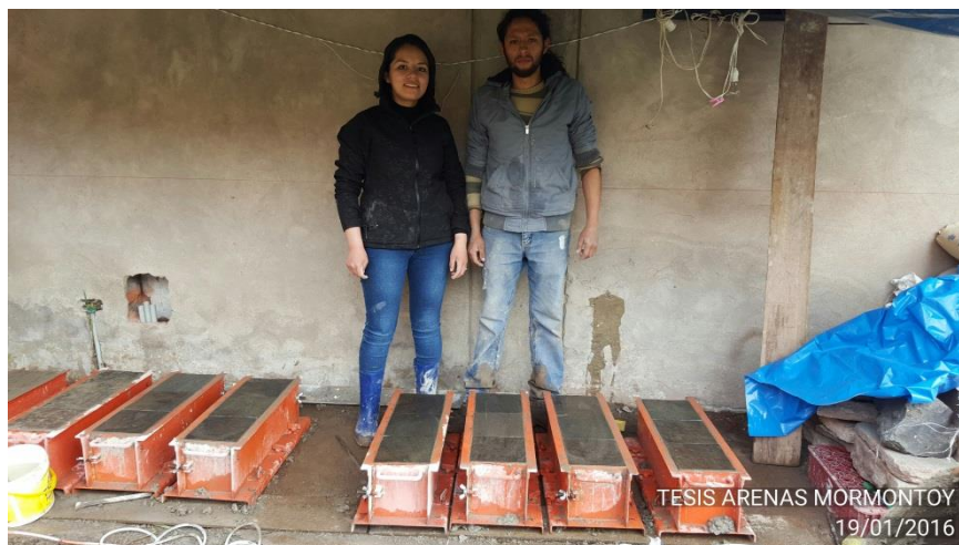
VIGUETAS CON PIEDRA LAJA EMBEBIDA VACIADAS
