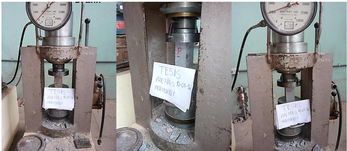
FIGURA N° 70 COLOCACION DE LAS MUESTRAS DE PIEDRA LAJA EN LA MAQUINA DE COMPRESION SIMPLE
