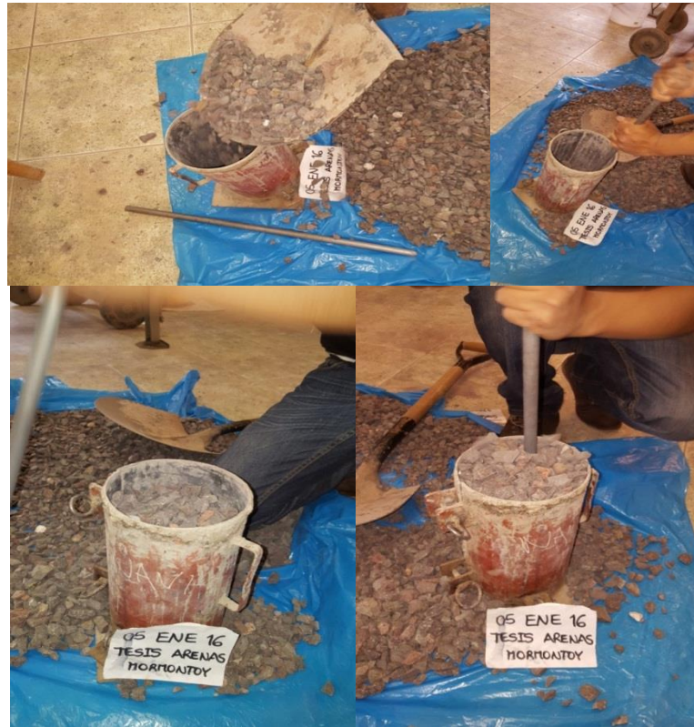
FIGURA Nº 59 RELLENO DEL MOLDE CON MATERIAL
