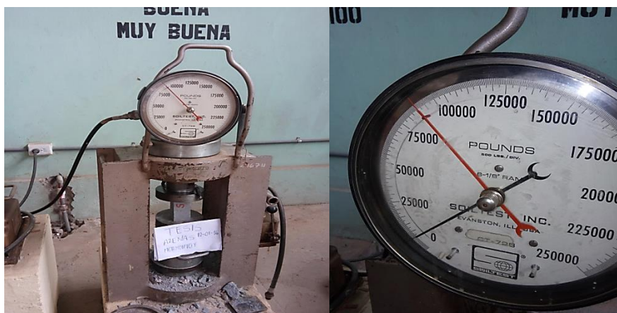
FIGURA Nº 72 RESISTENCIA A LA CARGA DE LA MUESTRA TALLADA DE LA CANTERA SANTA BARBARA – AREQUIPA
