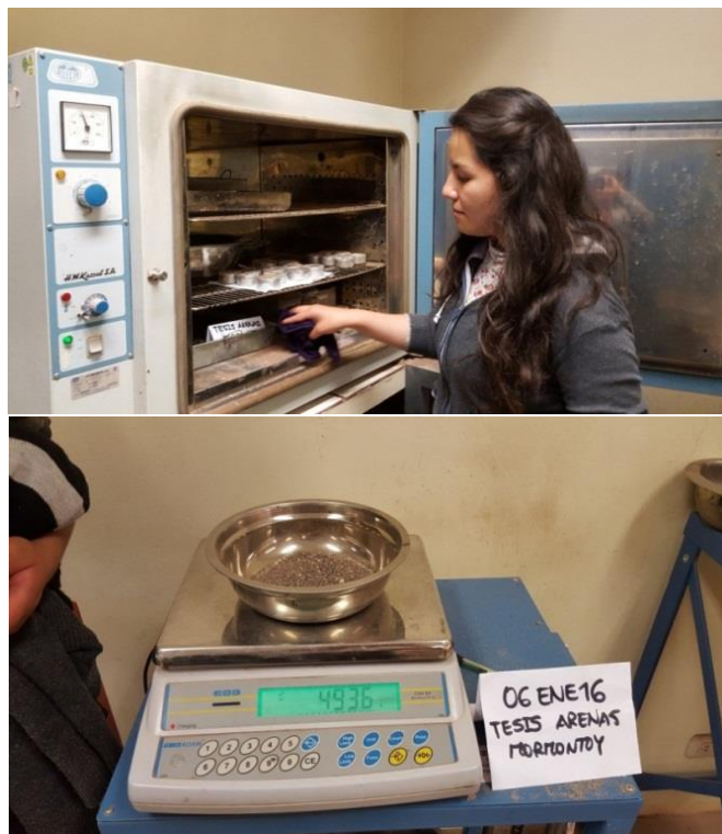
FIGURA Nº 46 PESAJE DE LA MUESTRA SECADA EN EL HORNO
