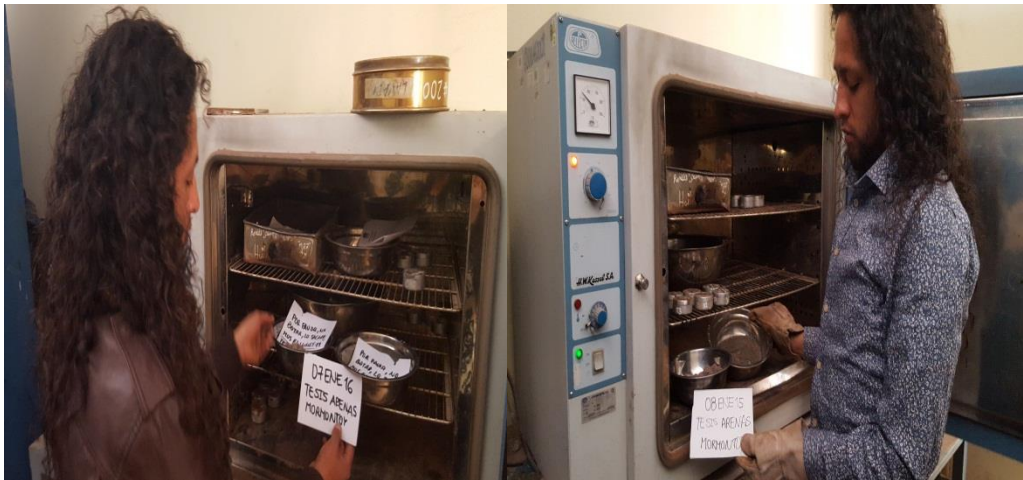
FIGURA Nº 65 SECADO Y EXTRACCIÓN DE LA MUESTRA DEL HORNO
