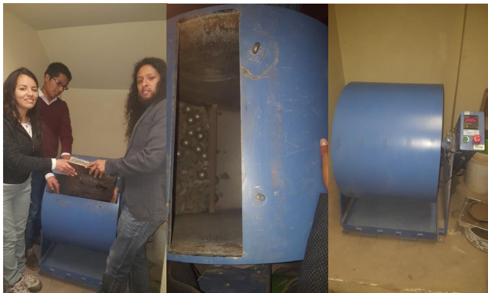
FIGURA N° 76 COLOCACIÓN DE LA MUESTRA EN LA MÁQUINA DE LOS ÁNGELES
