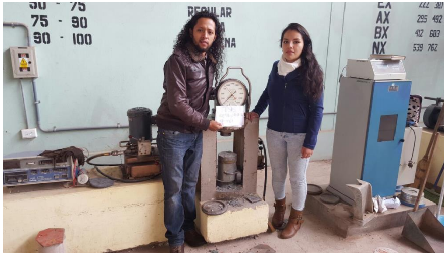
FIGURA N° 69 MAQUINA DE COMPRESIÓN PARA ENSAYO DE RESISTENCIA DE PIEDRA LAJA
