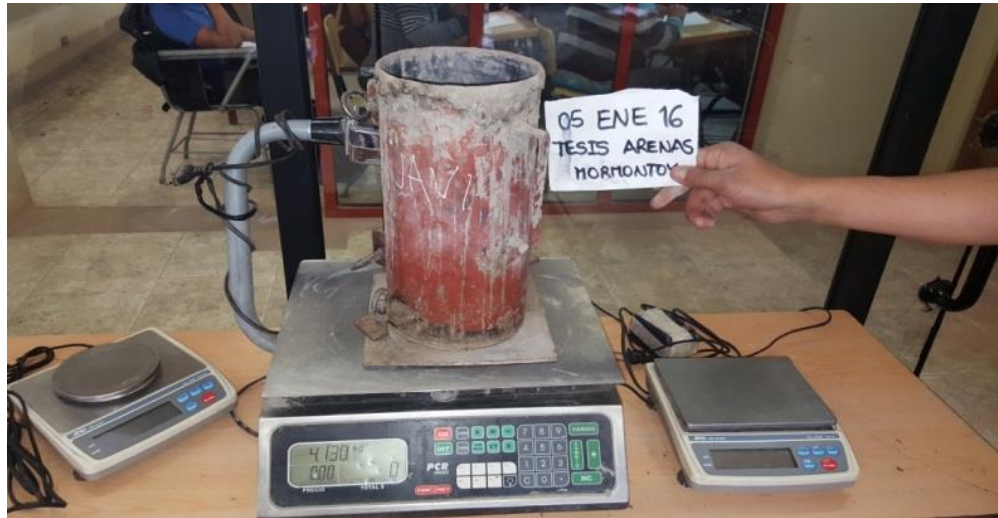
FIGURA Nº 54 DETERMINACIÓN DEL PESO DEL MOLDE
