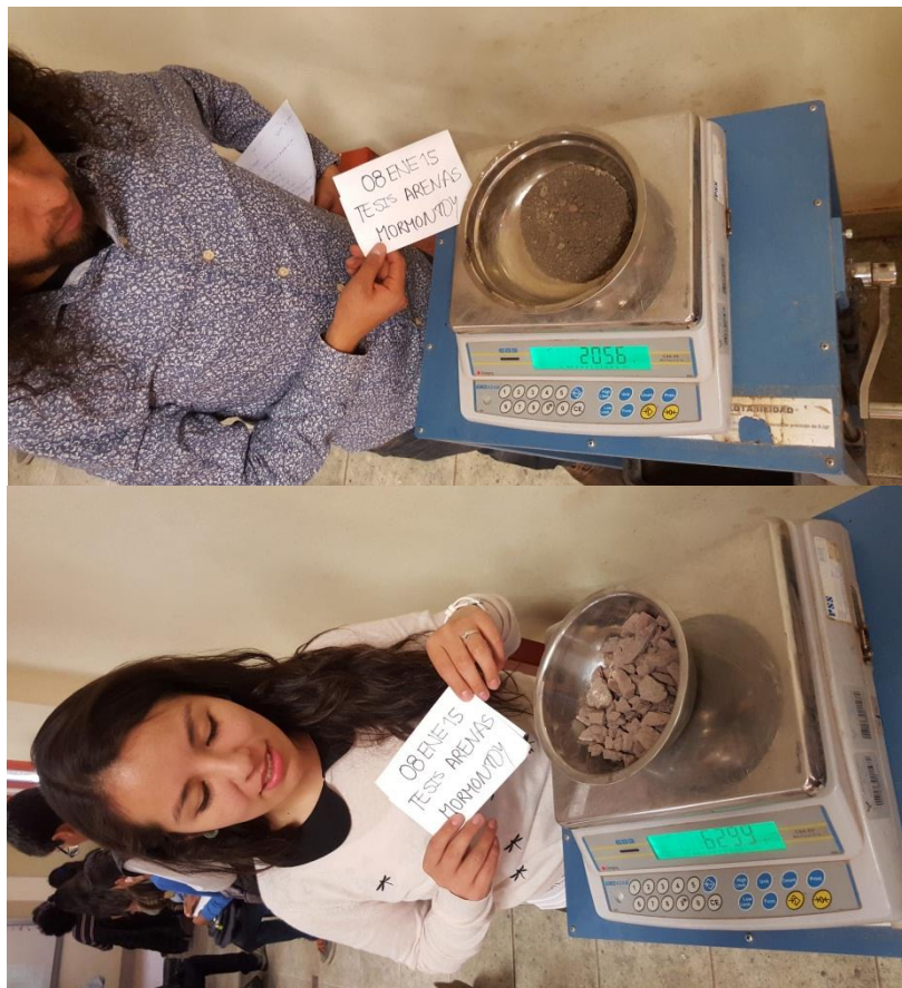
FIGURA Nº 66 PESAJE FINAL DE LA MUESTRA EN LAS CÁPSULAS
