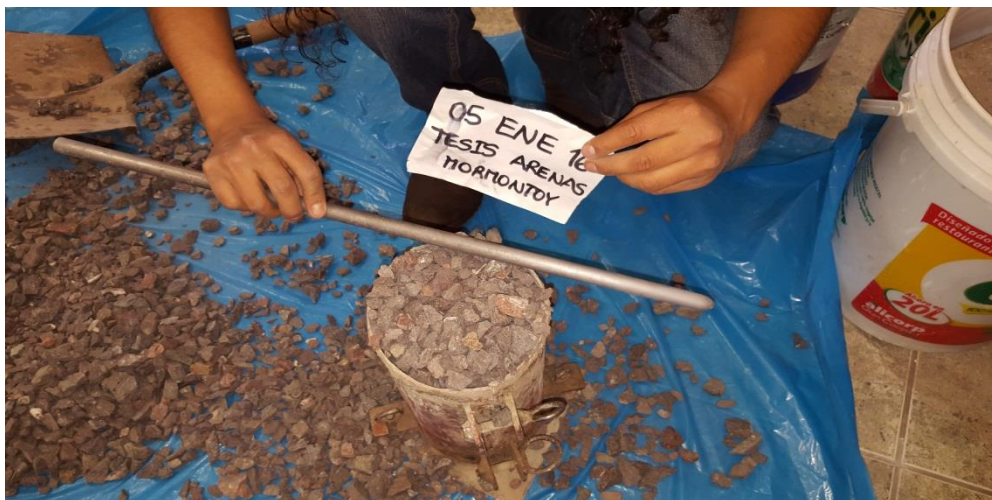
FIGURA N° 57 RELLENO Y ENRASAMIENTO DEL MOLDE CON MATERIAL SIMPLEMENTE COLOCADO
