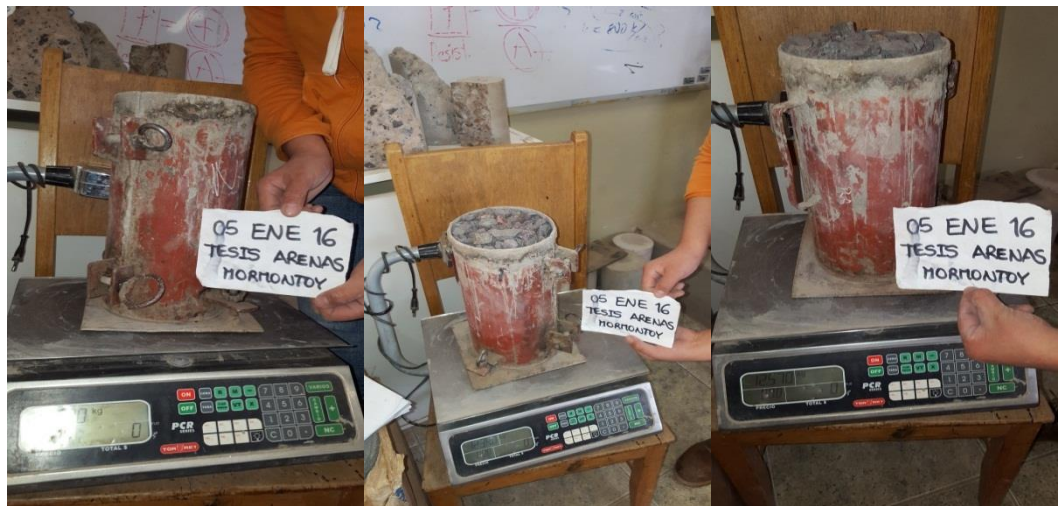
FIGURA Nº 62 PESAJE DEL MOLDE CON MATERIAL COMPACTADO
