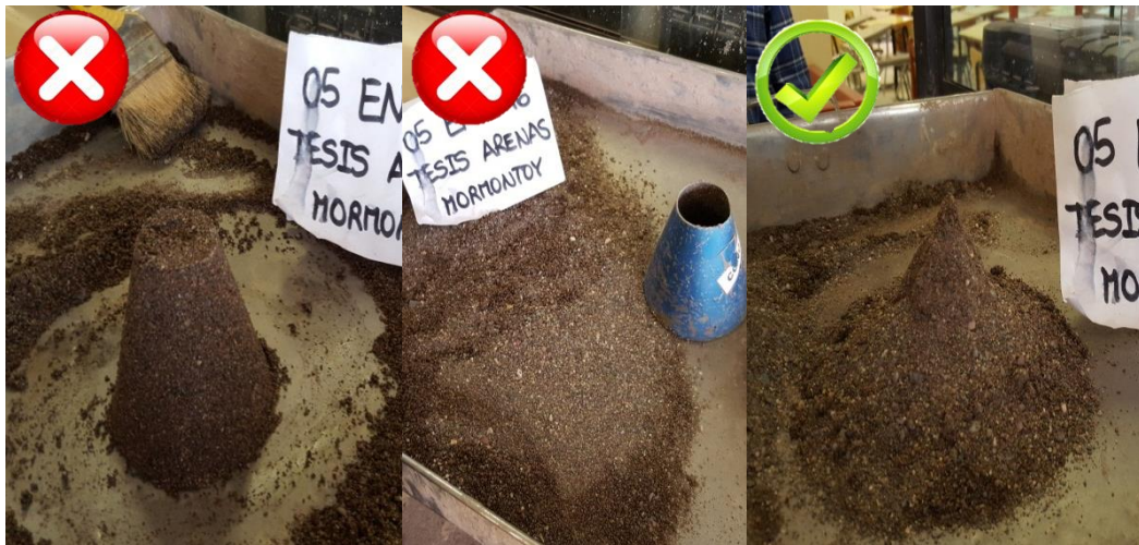
FIGURA Nº 42 COMPROBACIÓN DEL ESTADO SUPERFICIALMENTE SECO DE LA MUESTRA
