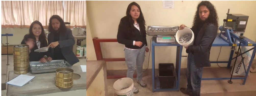
FIGURA N° 75 TAMIZADO Y PESAJE INICIAL DE LA MUESTRA
