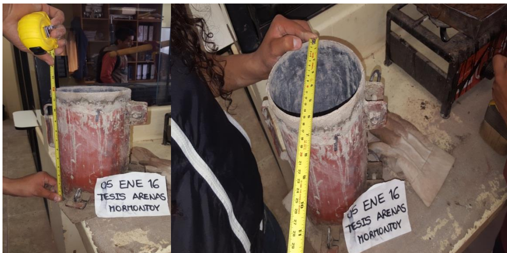
FIGURA Nº 55 DETERMINACIÓN DEL VOLUMEN DEL MOLDE
