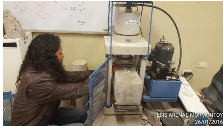
FIGURA Nº 83 COLOCACIÓN DEL PRISMA
