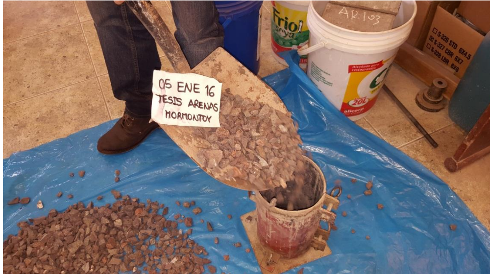
FIGURA N° 56 RELLENO DEL MOLDE CON MATERIAL SIMPLEMENTE COLOCADO
