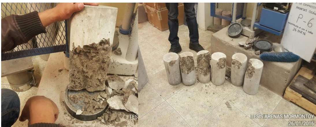
FIGURA Nº 81 PROBETAS YA SOMETIDAS A COMPRESIÓN
