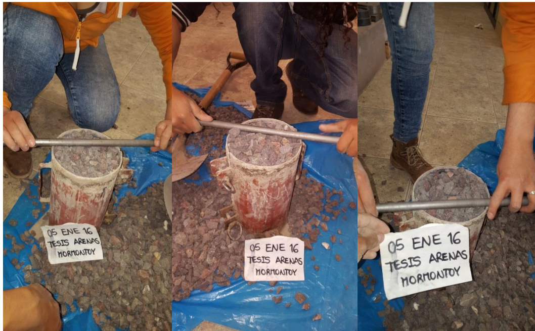
FIGURA Nº 61 RELLENO Y ENRASAMIENTO DEL MOLDE CON MATERIAL COMPACTADO
