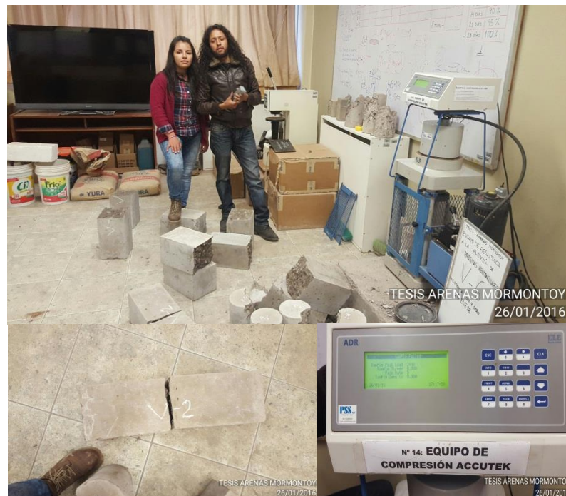
FIGURA Nº 84 PRISMAS YA SOMETIDOS A FLEXIÓN
