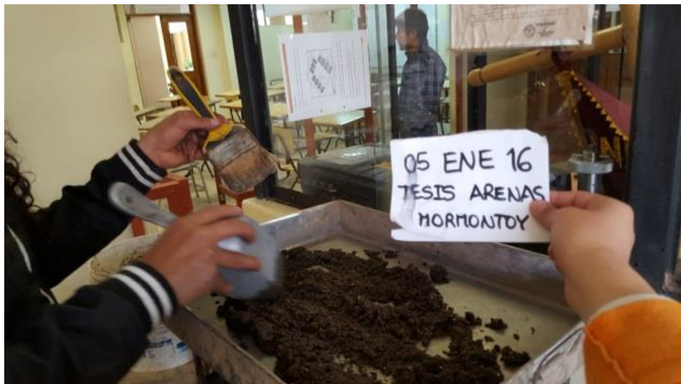
FIGURA Nº 39 SECADO SUPERFICIAL DE LA MUESTRA
