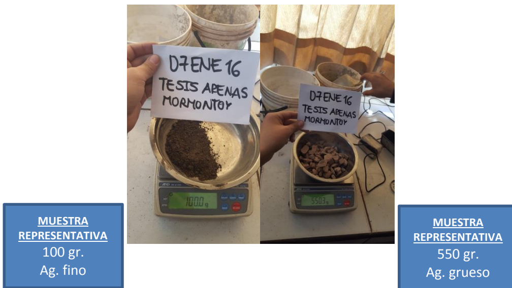
FIGURA N° 64 PESAJE INICIAL DE LA MUESTRA EN LAS CÁPSULAS
