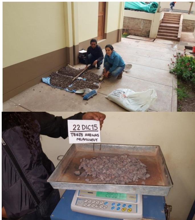
FIGURA N° 32 MUESTREO Y PESAJE DE LA MUESTRA
