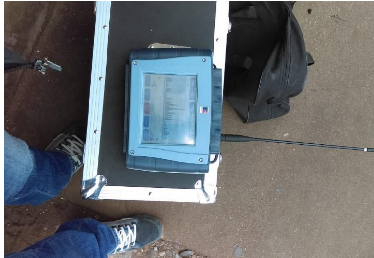
Figura N° 32: EQUIPO CORRELADOR DE FUGAS PARA LA DETECCIÓN DE FUGAS.
