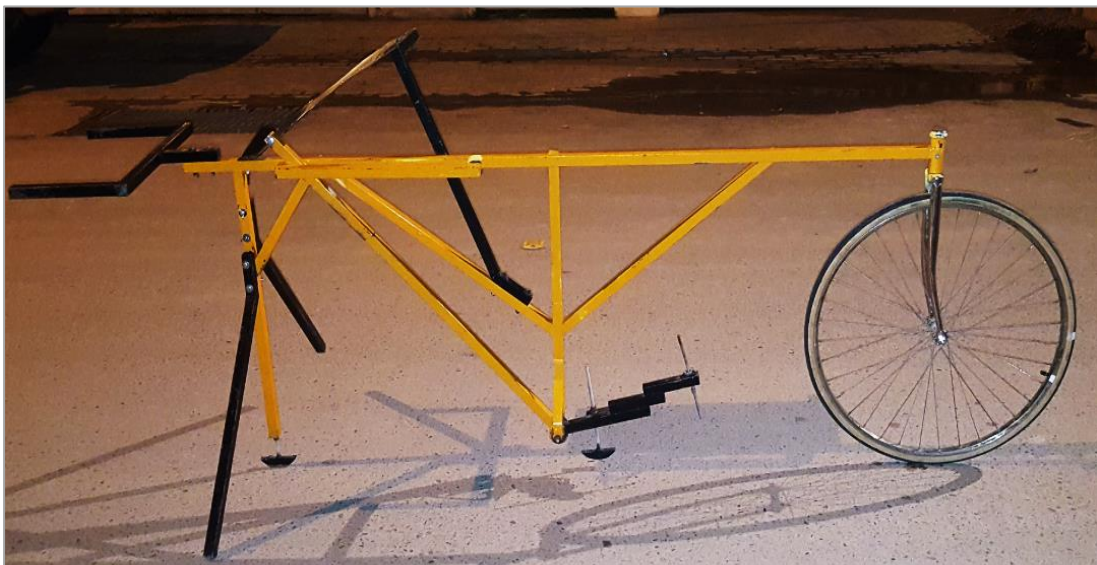
Figura 19: Rugosímetro de MERLIN empleado para los ensayos en esta tesis.
