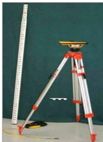
Figura 10: Nivel y mira topográfica.
