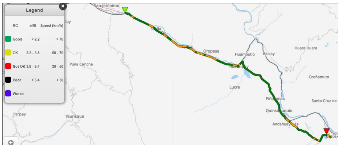
Figura 55: Visualización del estado de la carretera.
