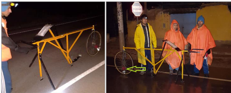
Figura 63: Izquierda, toma de datos con el Rugosímetro de MERLIN. Derecha, marca visible en la llanta.
