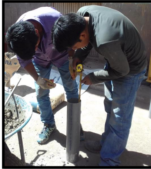
Figura 76. Apisonado del concreto en el molde de tubo PVC de 4”.
