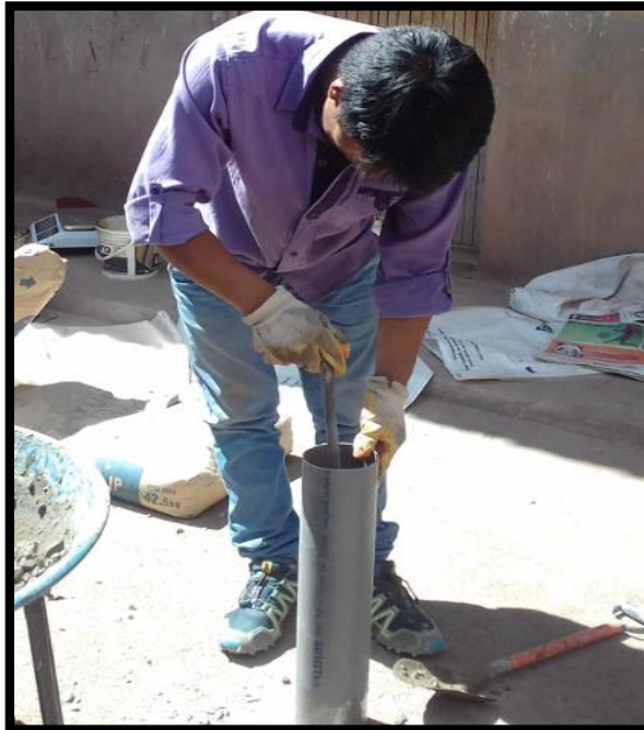
Figura 75. Apisonado del concreto en el molde de tubo PVC de 4".
