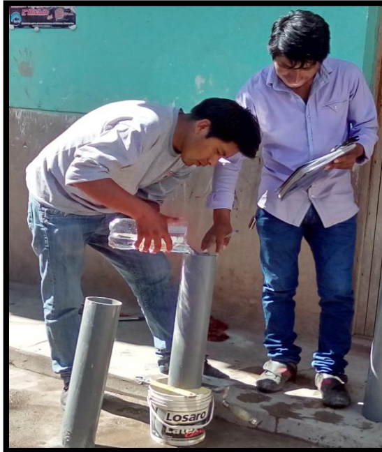
Figura 78. Suministro del agua en el Concreto Poroso.
