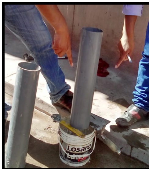
Figura 79. Tiempo de paso del agua por el Concreto Poroso.
