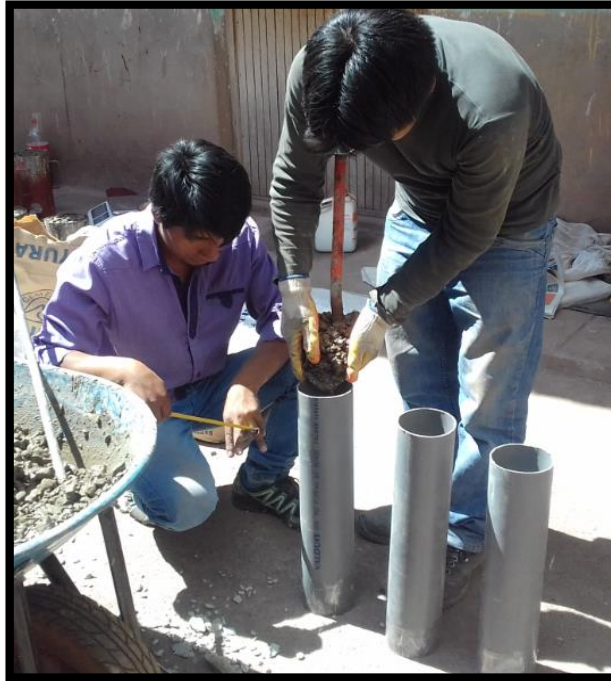
Figura 74. Concreto en el molde de tubo PVC de 4" y 50 cm de longitud.
