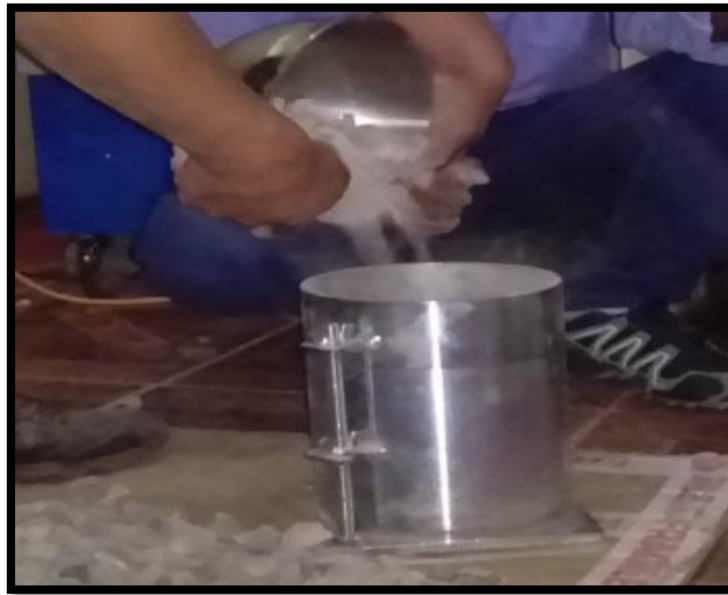
Figura 22. Caída del agregado grueso.
