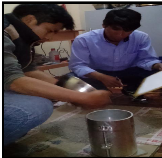
Figura 29. Agregado fino, puesto en el recipiente.
