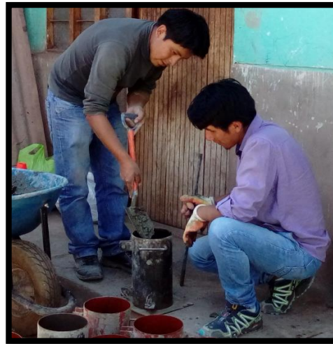
Figura 55. Colocado de concreto al molde.
