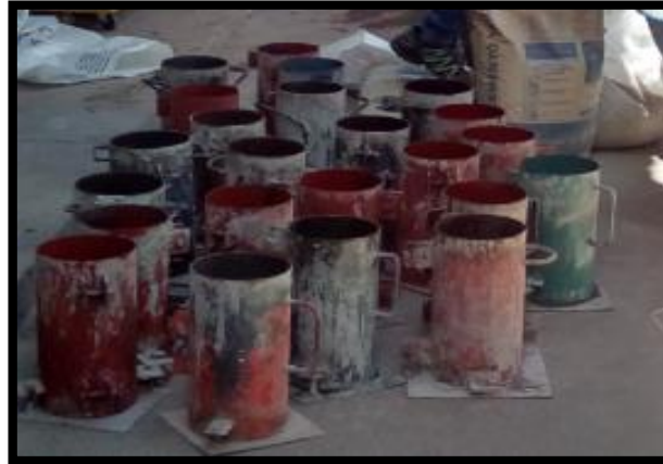
Figura 45. Moldes debidamente engrasadas.
