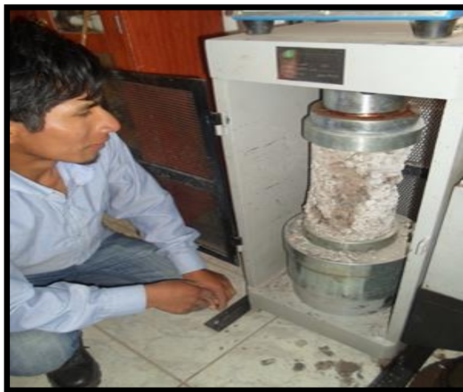
Figura 70. Momento en que fallo la briqueta de Concreto Poroso.
