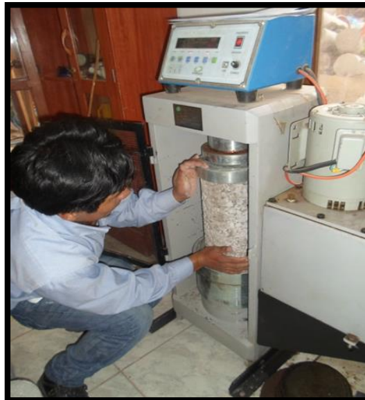
Figura 68. Testigo de concreto colocado en la maquina compresora.
