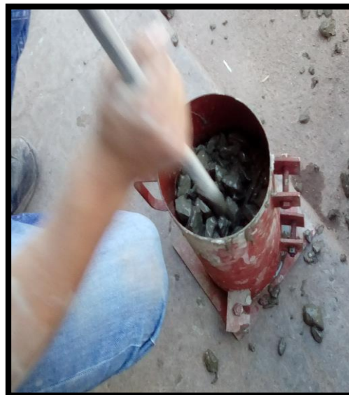
Figura 56. Apisonado de las tres capas del concreto en el molde.
