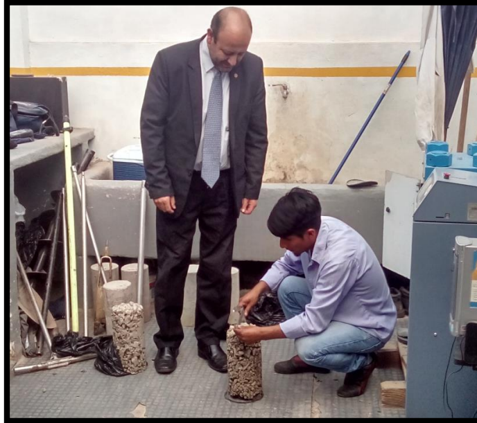
Figura 67. Medición del diámetro del Concreto Poroso.
