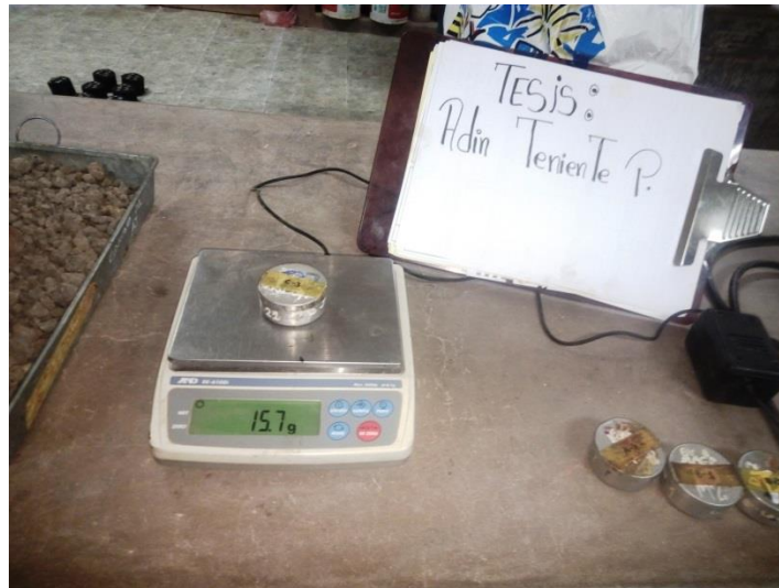
FIGURA N° 34: PESADO DE LAS TARAS EN SECO
