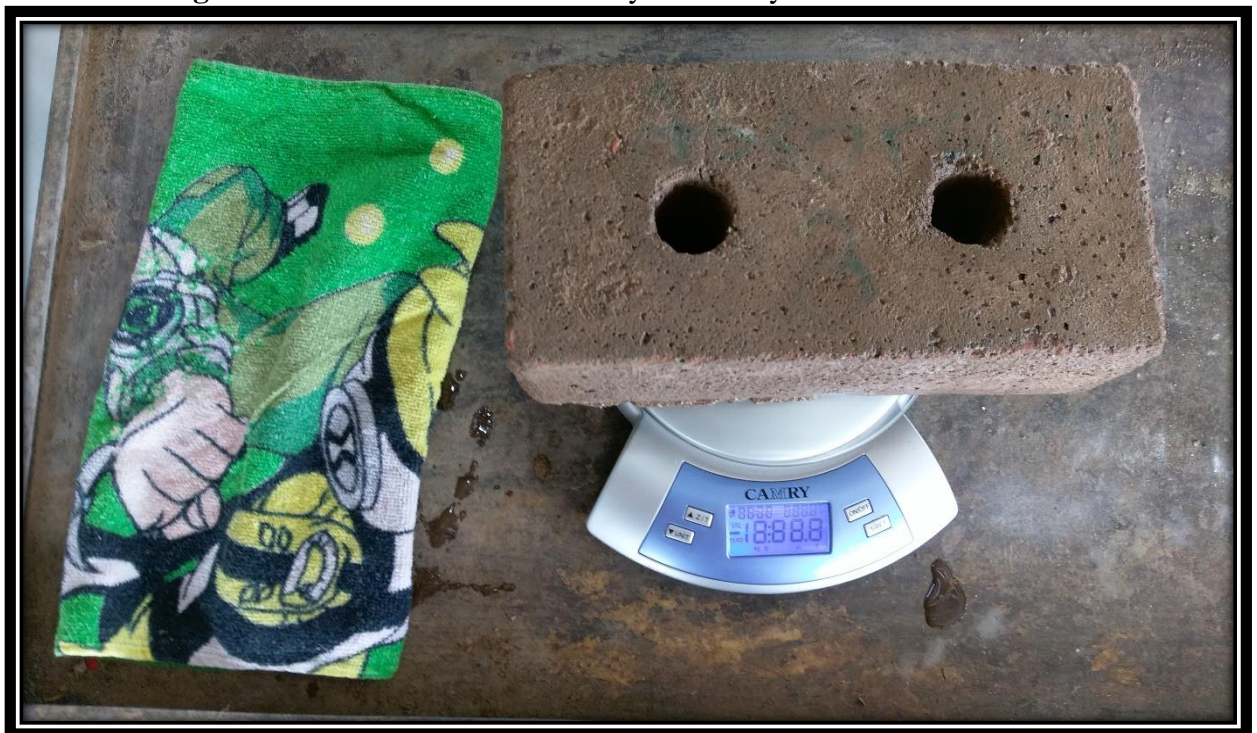
Figura 70: Procedimiento del Ensayo de Ensayo de Absorción
