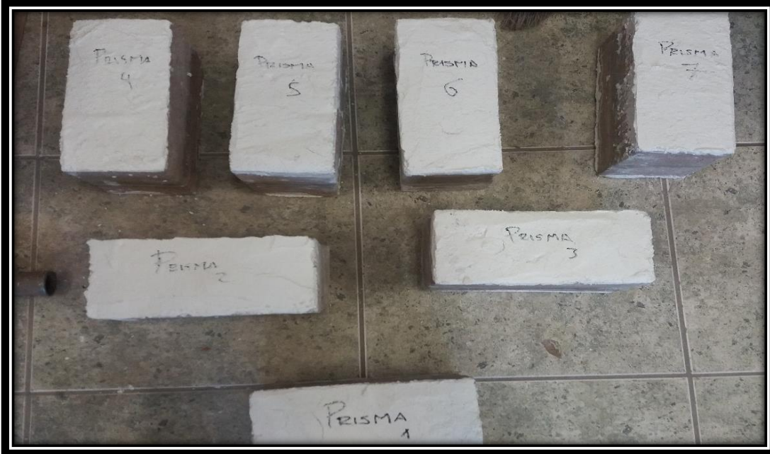
Figura 60: Procedimiento del Ensayo de Ensayo de Resistencia en Compresión de Prismas
