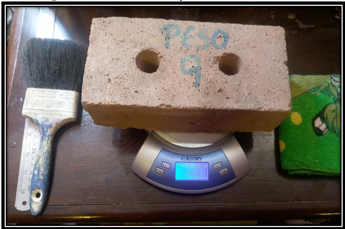
Figura 40: Procedimiento del Ensayo de Determinación del Peso
