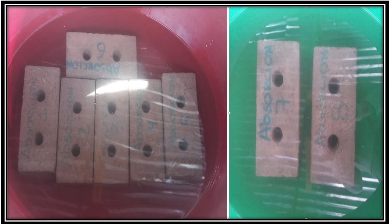
Figura 69: Procedimiento del Ensayo de Ensayo de Absorción
