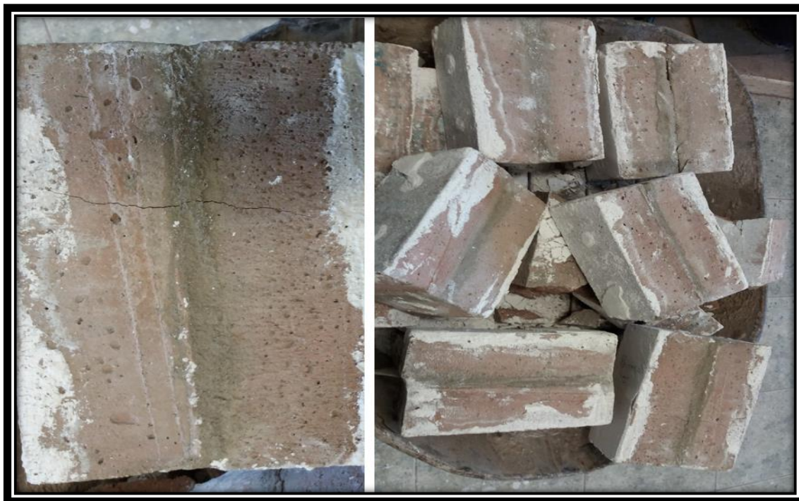
Figura 63: Procedimiento del Ensayo de Ensayo de Resistencia en Compresión de Prismas
