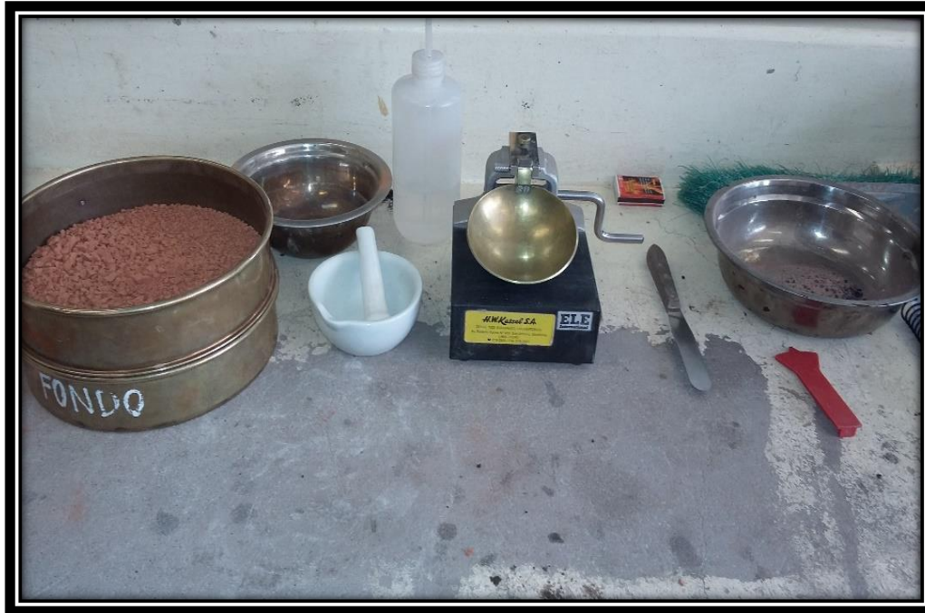
Figura 16: Instrumentos del Ensayo de Límite Líquido
