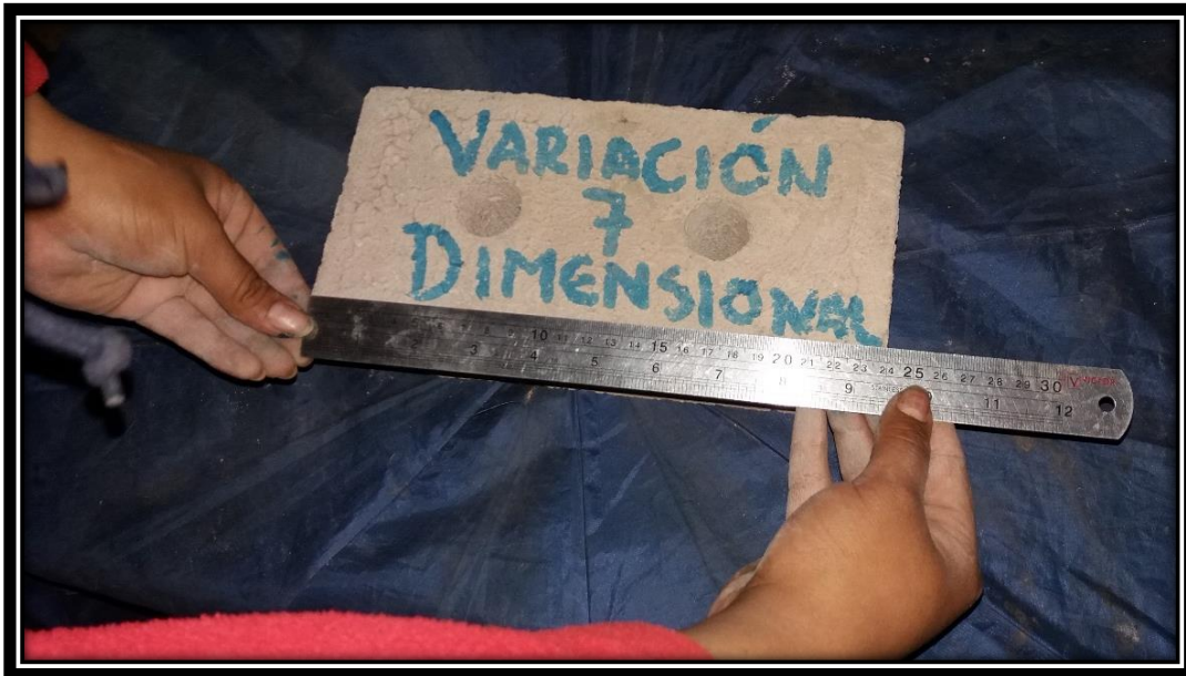
Figura 44: Procedimiento del Ensayo de Variación Dimensional
