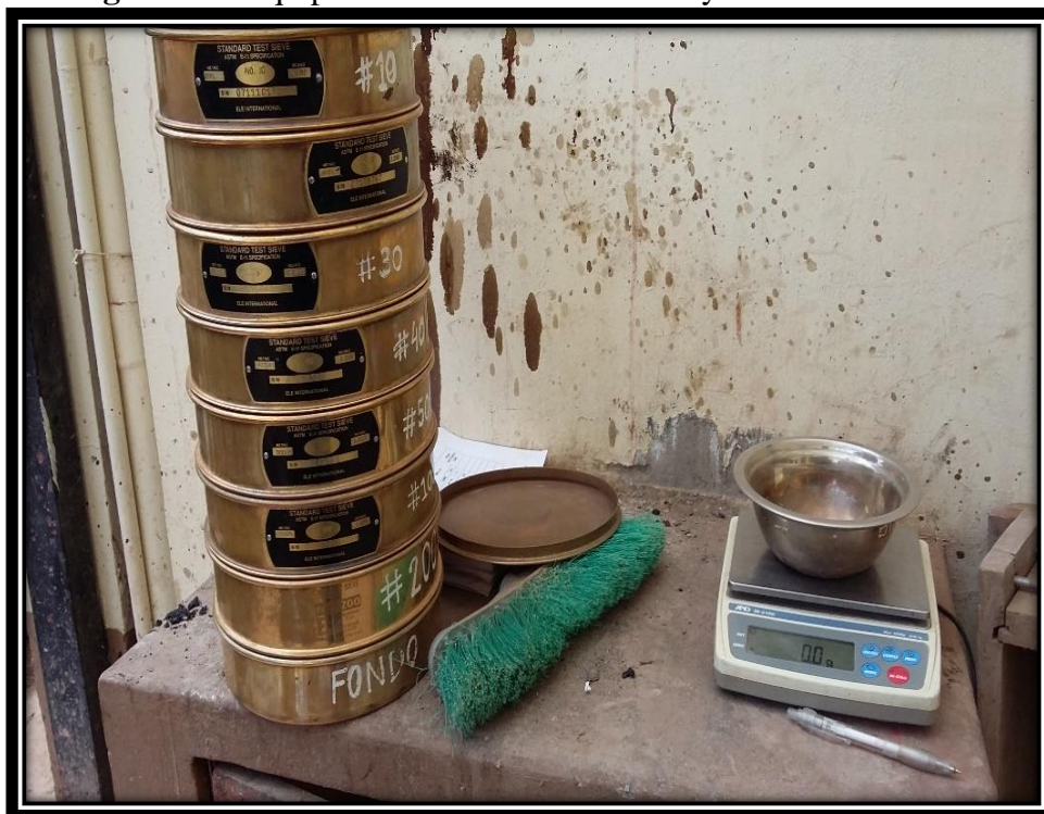
Figura 23: Equipos e Instrumentos del Ensayo de Granulometría
