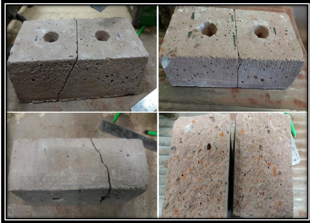
Figura 66: Procedimiento del Ensayo de Ensayo de Módulo de Rotura
