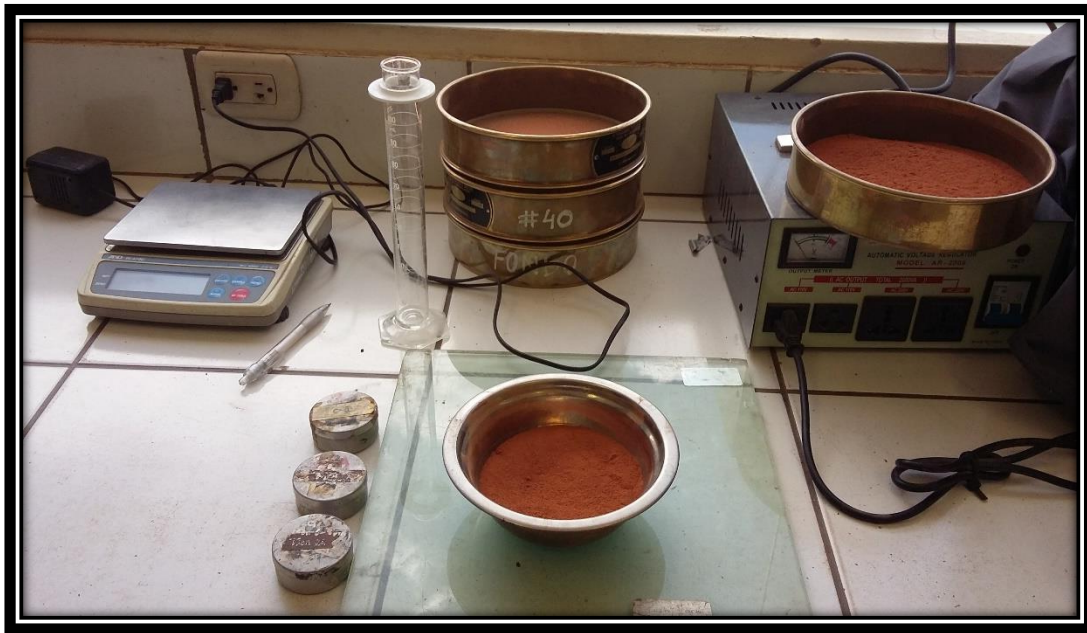
Figura 20: Instrumentos del Ensayo de Límite Plástico
