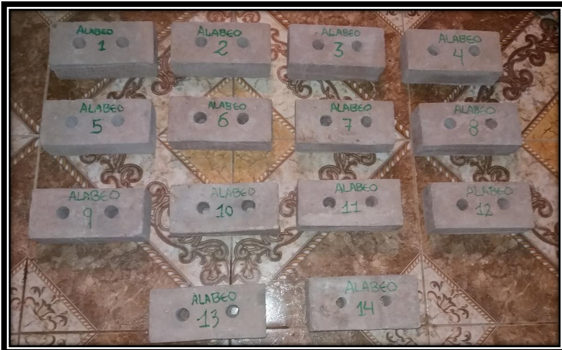
Figura 51: Procedimiento del Ensayo de Alabeo
