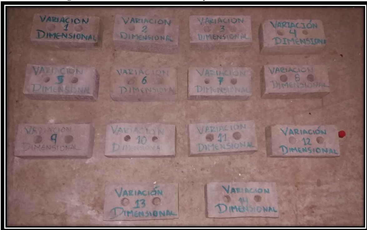
Figura 47: Procedimiento del Ensayo de Variación Dimensional
