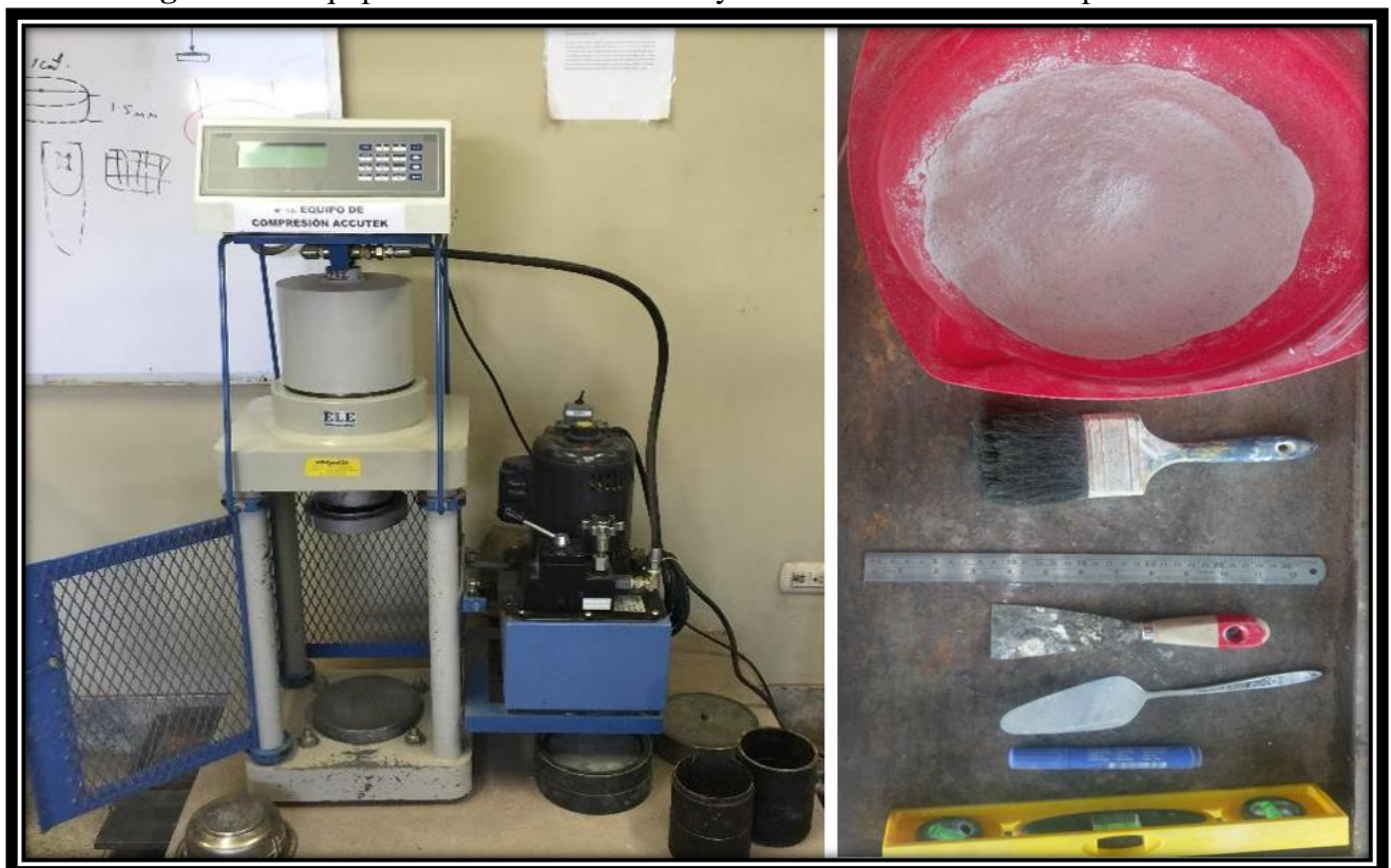
Figura 52: Equipo e Instrumento del Ensayo de Resistencia a la Compresión
