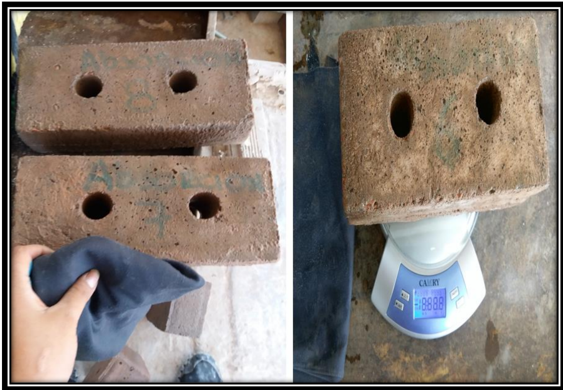
Figura 73: Procedimiento del Ensayo de Ensayo de Absorción Máxima
