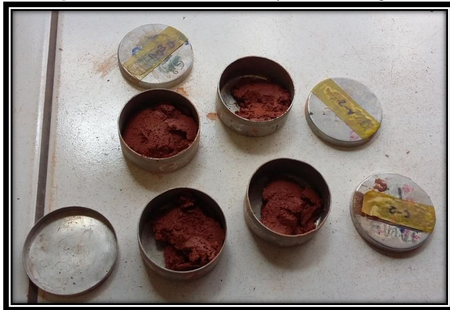
Figura 18: Procedimiento del Ensayo de Límite Líquido
