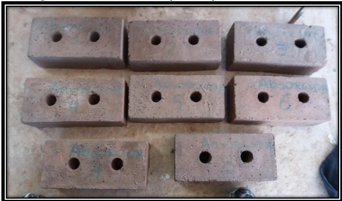
Figura 74: Procedimiento del Ensayo de Ensayo de Absorción Máxima
