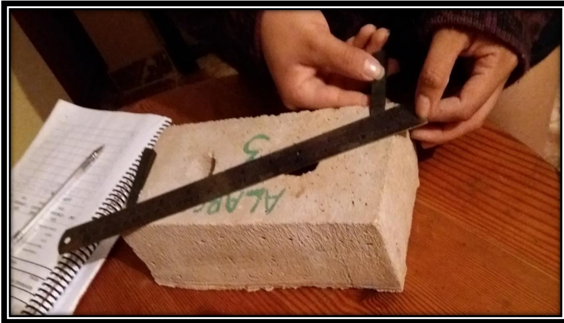
Figura 50: Procedimiento del Ensayo de Alabeo
