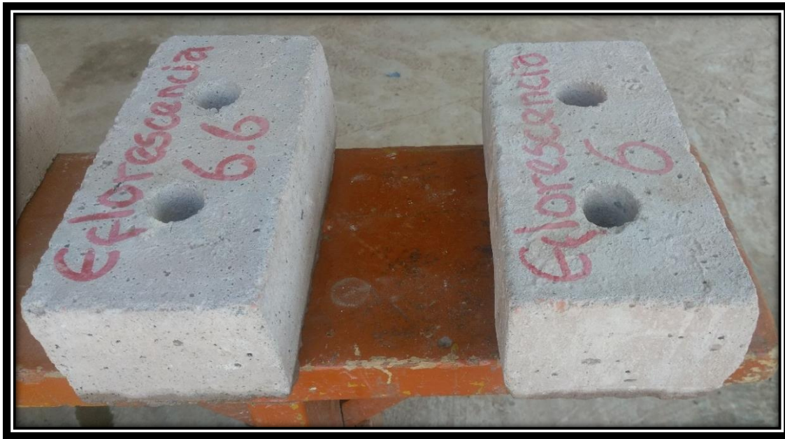
Figura 81: Procedimiento del Ensayo de Ensayo de Eflorescencia
