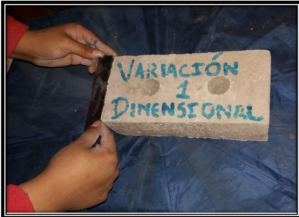
Figura 45: Procedimiento del Ensayo de Variación Dimensional
