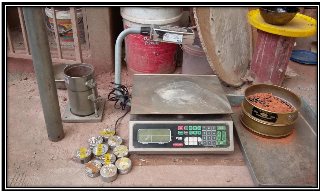
Figura 27: Equipos e Instrumentos del Ensayo de Proctor Modificado
