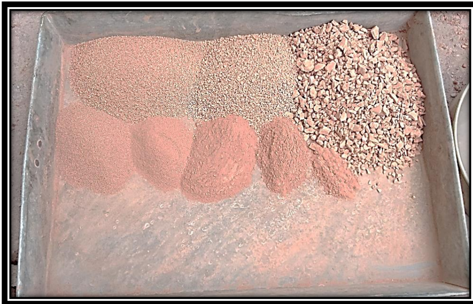
Figura 26: Procedimiento del Ensayo de Granulometría
