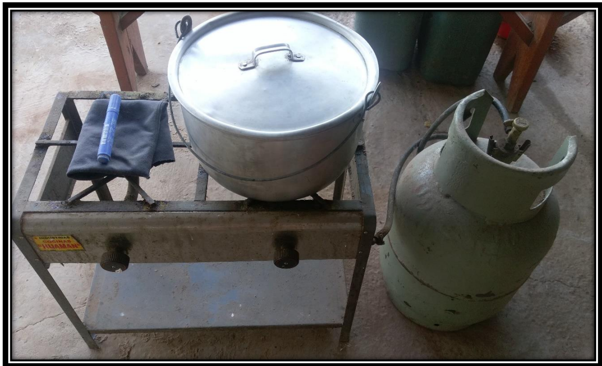
Figura 71: Equipos e Instrumentos del Ensayo de Absorción Máxima
