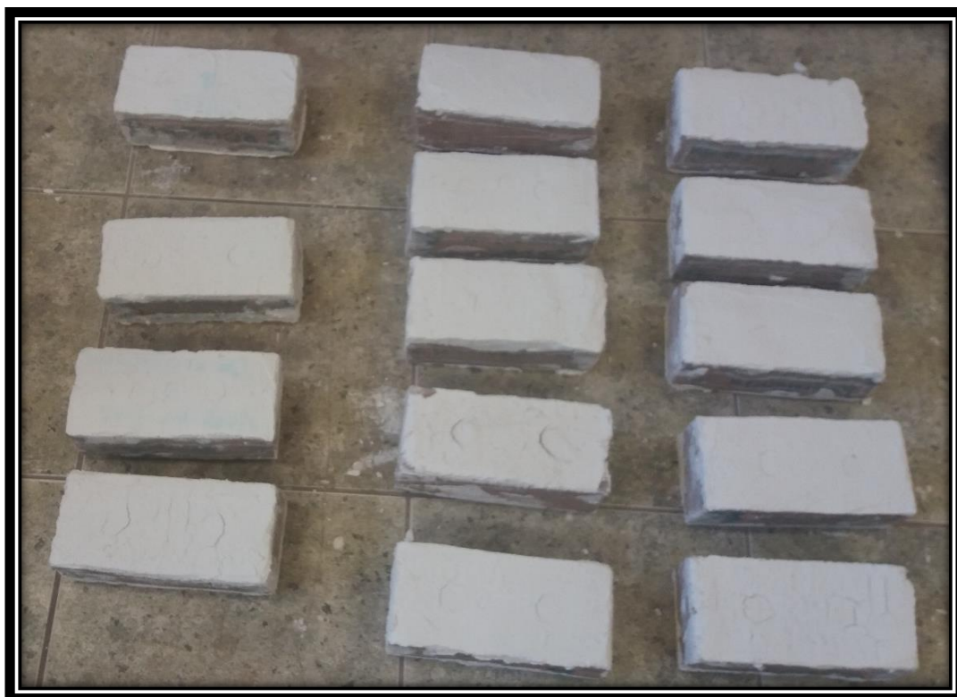
Figura 53: Procedimiento del Ensayo de Resistencia a la Compresión
