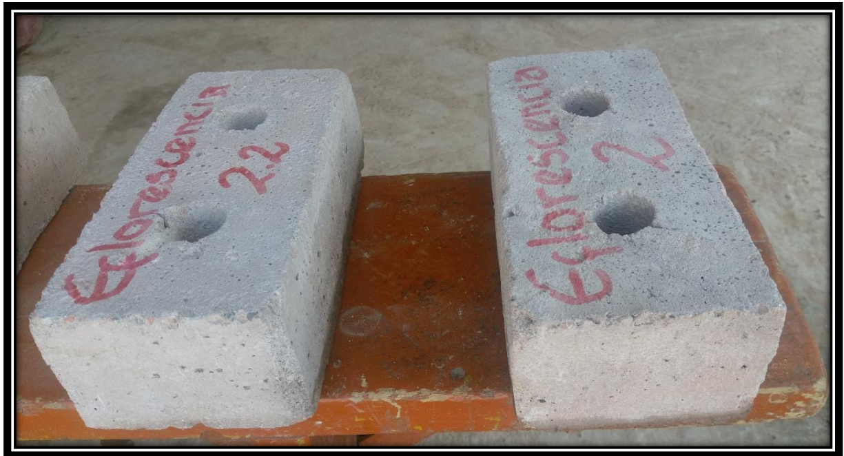
Figura 80: Procedimiento del Ensayo de Ensayo de Eflorescencia
