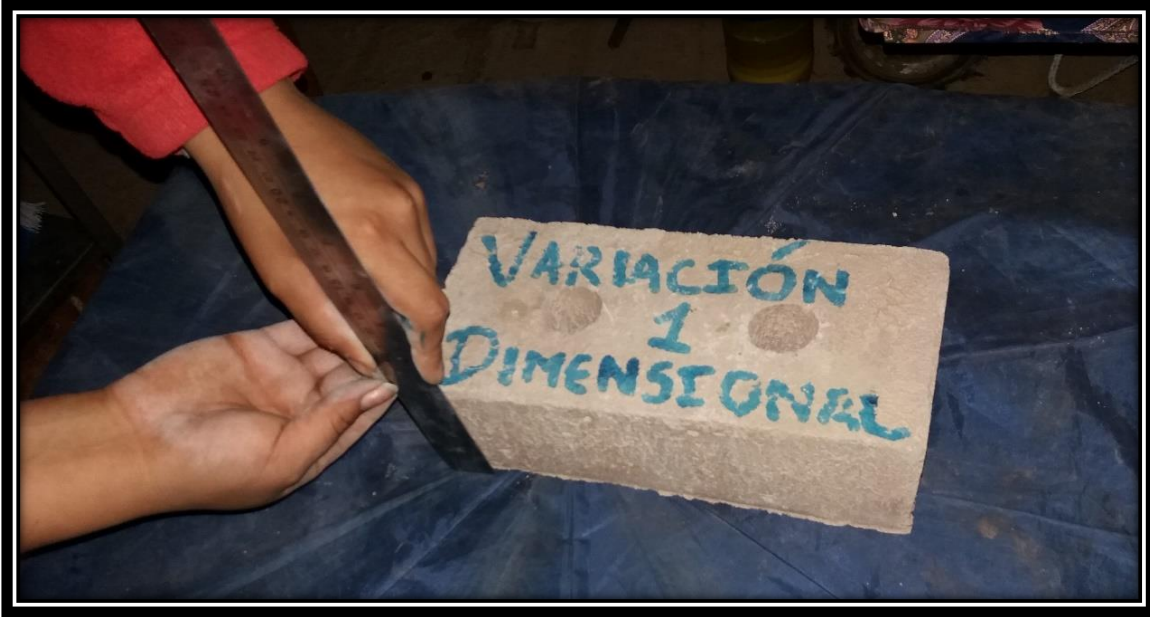
Figura 46: Procedimiento del Ensayo de Variación Dimensional
