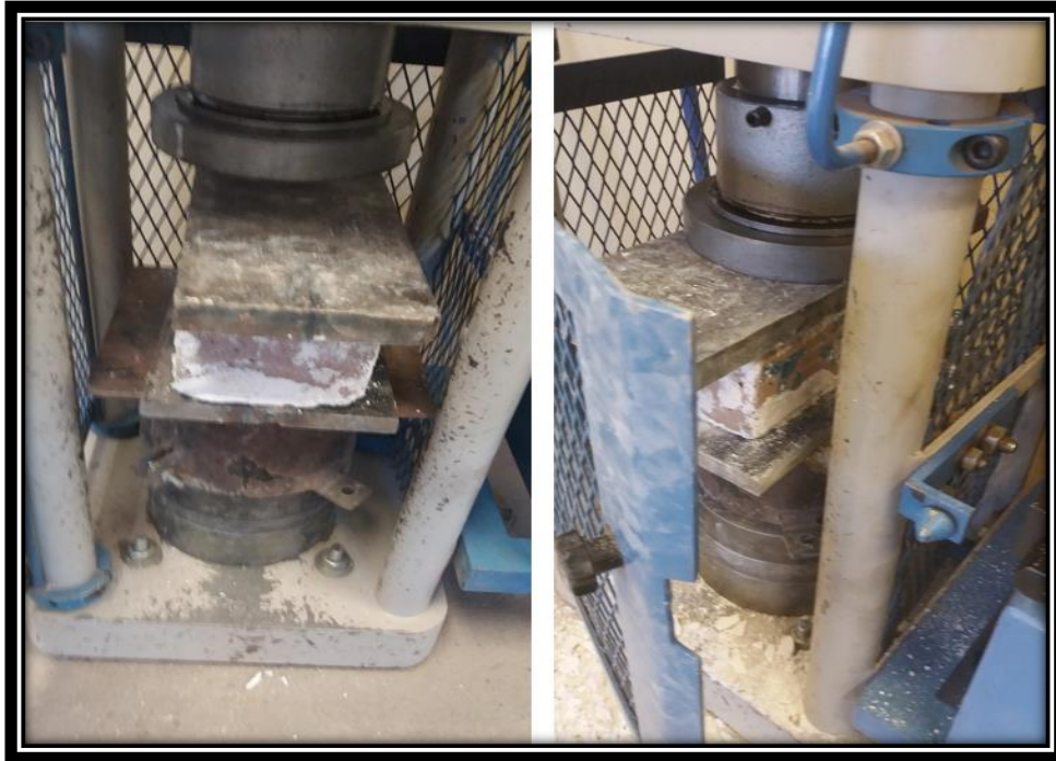
Figura 54: Procedimiento del Ensayo de Resistencia a la Compresión
