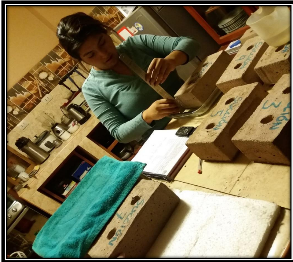
Figura 77: Procedimiento del Ensayo de Ensayo de Succión
