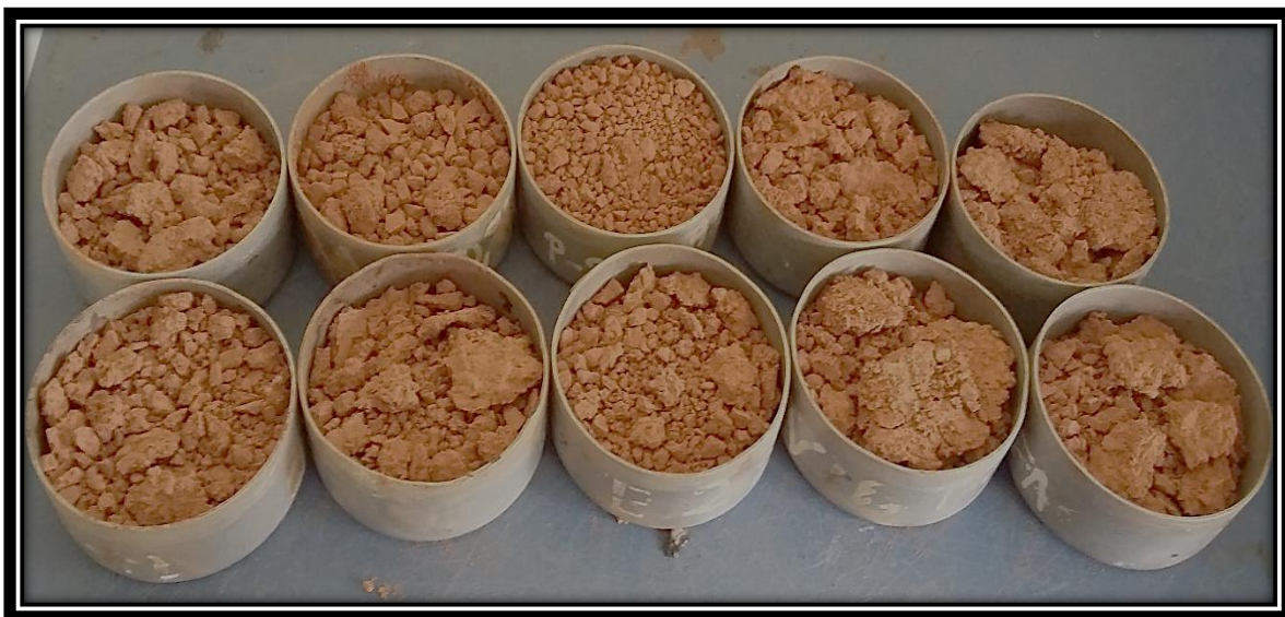
Figura 30: Procedimiento del Ensayo de Proctor Modificado
