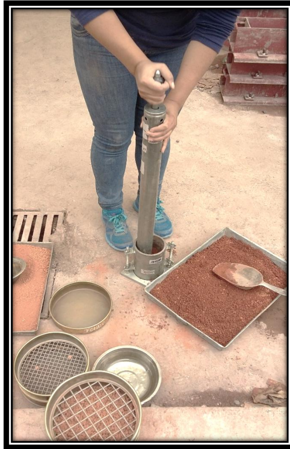
Figura 29: Procedimiento del Ensayo de Proctor Modificado
