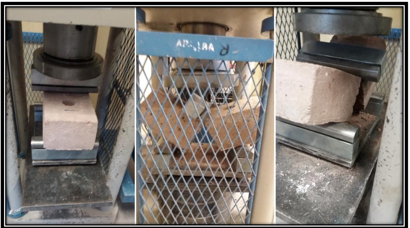
Figura 65: Procedimiento del Ensayo de Ensayo de Módulo de Rotura
