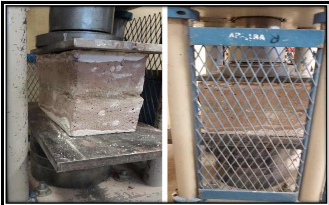
Figura 61: Procedimiento del Ensayo de Ensayo de Resistencia en Compresión de Prismas
