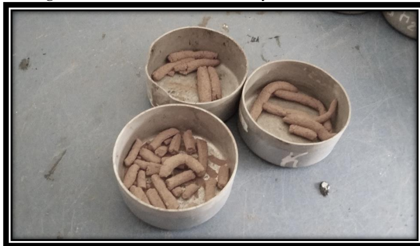
Figura 22: Procedimiento del Ensayo de Límite Plástico
