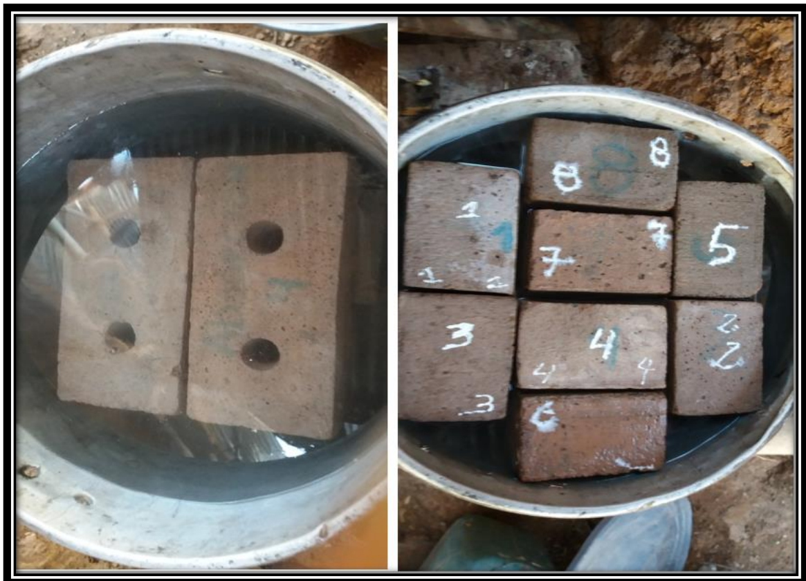
Figura 72: Procedimiento del Ensayo de Ensayo de Absorción Máxima
