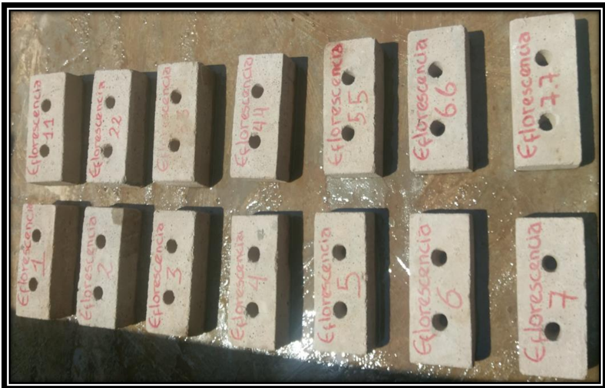
Figura 82: Procedimiento del Ensayo de Ensayo de Eflorescencia
