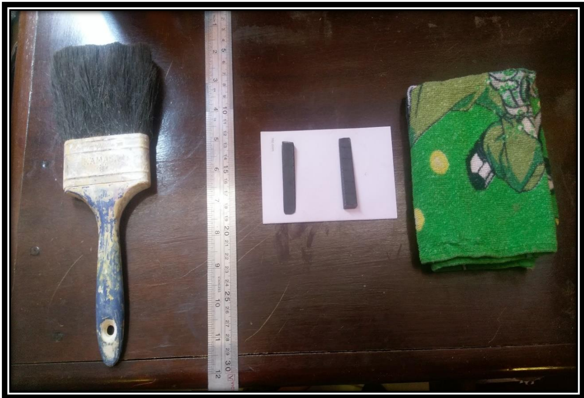
Figura 48: Equipos e Instrumentos del Ensayo de Alabeo
