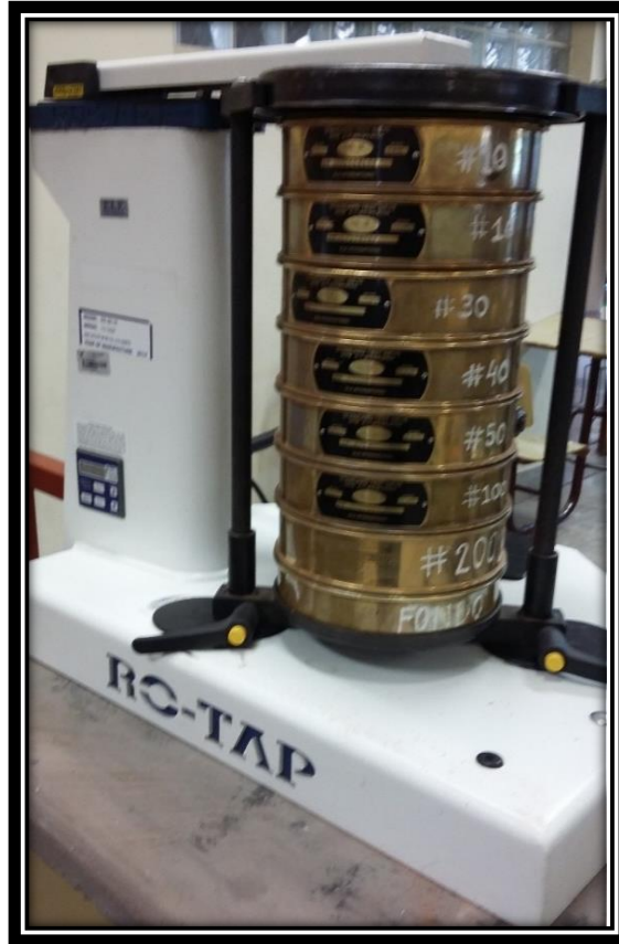
Figura 25: Procedimiento del Ensayo de Granulometría
