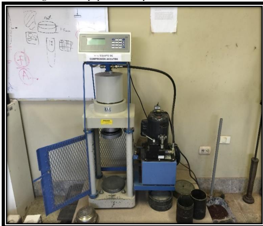
Figura 64: Equipo del Ensayo de Modulo De Rotura
