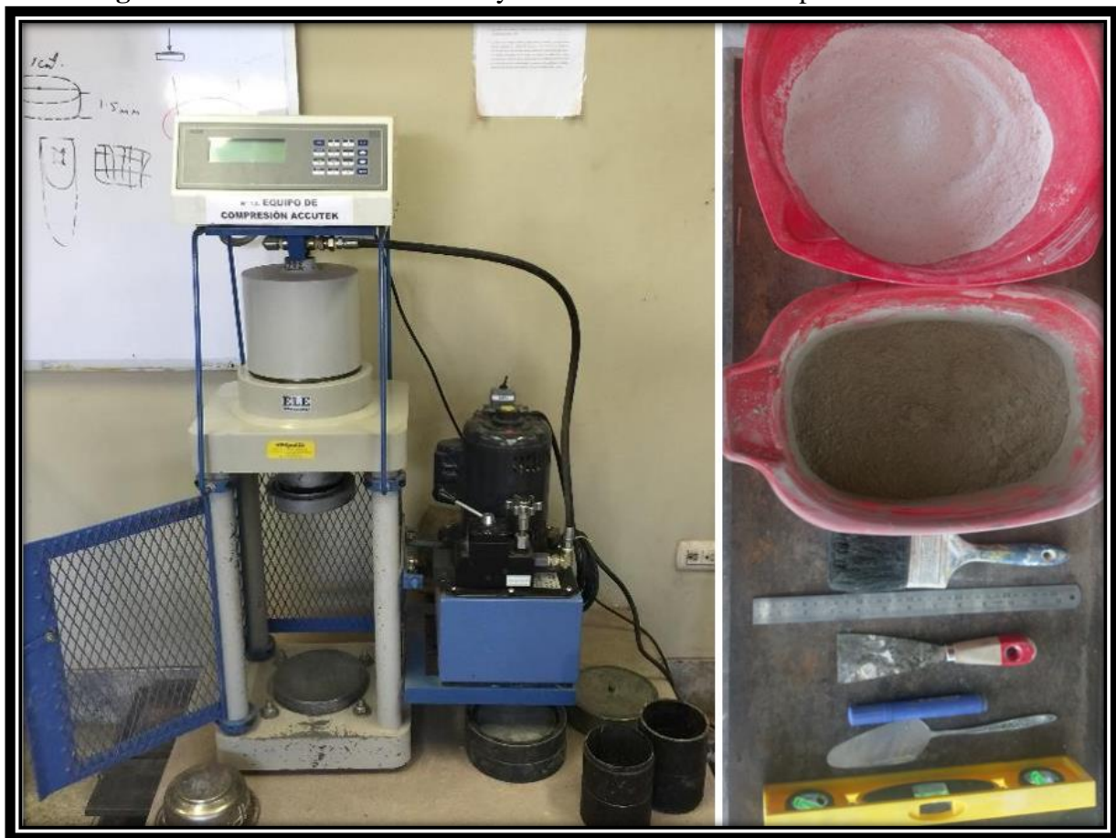
Figura 58: Instrumentos del Ensayo de Resistencia en Compresión de Prismas
