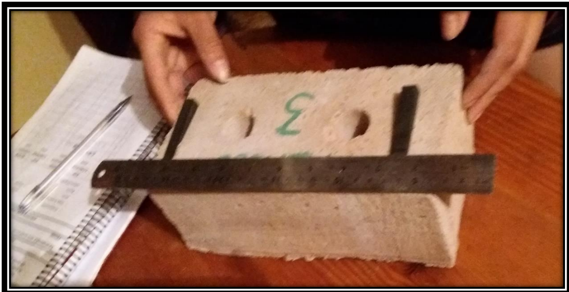
Figura 49: Procedimiento del Ensayo de Alabeo
