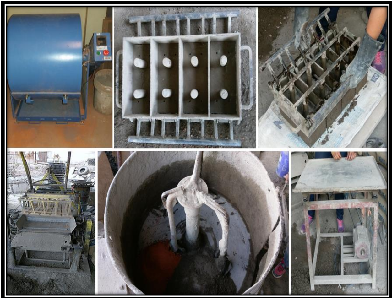
Figura 31: Equipos e Instrumentos Para la Elaboración de Unidades de Albañilería
