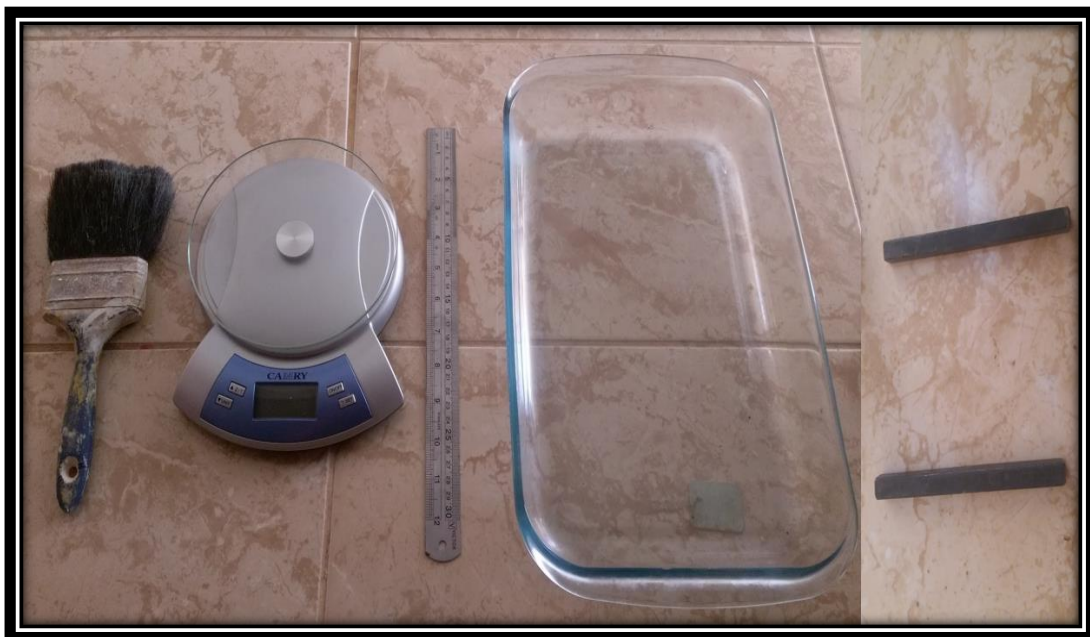
Figura 75: Equipos e Instrumentos del Ensayo de Succión
