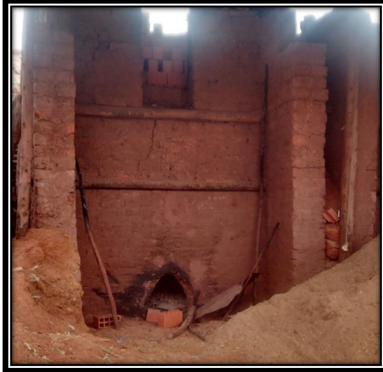
Figura 03: Horno Artesanal para la Producción de Ladrillos
