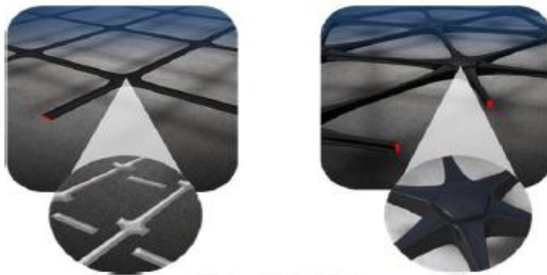
FIGURA 10 FORMA DE LAS JUNTAS EN LAS GEOMALLAS BIAXIALES Y MULTIAXIALES
