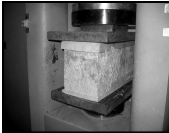
FIGURA 15: BLOQUE DE CONCRETO SOMETIDO A COMPRESIÓN
