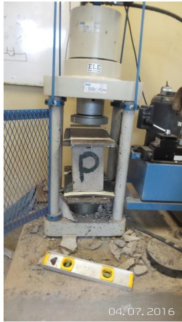
FIGURA 85: ENSAYO DE RESISTENCIA A COMPRESIÓN DE LAS UNIDADES
