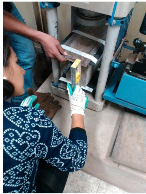
FIGURA 85: ENSAYO DE RESISTENCIA A COMPRESIÓN DE LAS UNIDADES
