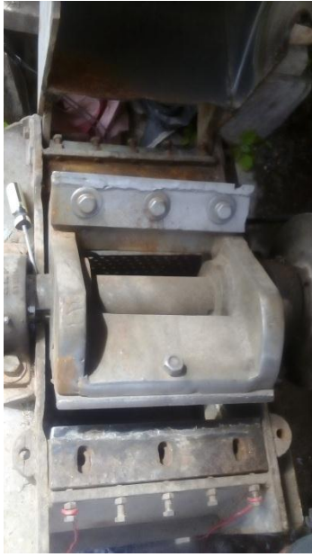
FIGURA 75: MOLINO MECÁNICO PARA EL PICADO DEL PET
