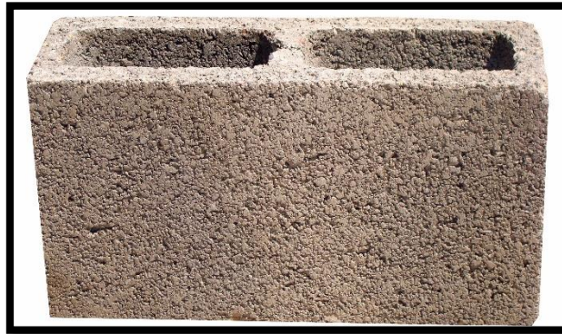
FIGURA 5: BLOQUE DE CONCRETO
