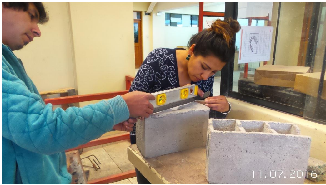
FIGURA 88: ENSAYO DE ALABEO DE LAS UNIDADES
