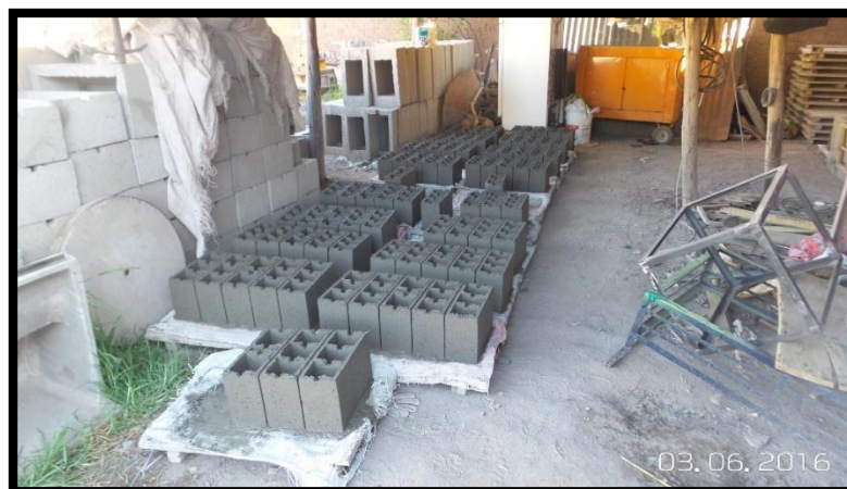
FIGURA 43: COLOCACIÓN DE LOS BLOQUES EN LA ZONA DE SECADO
