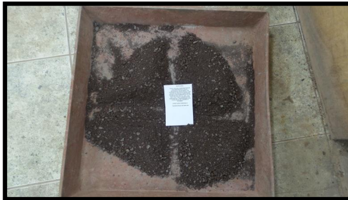
FIGURA 28: CUARTEO DE MATERIAL PARA GRANULOMETRÍA DE AGREGADO GRUESO
