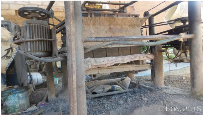
FIGURA 82: DESMOLDE DE LAS UNIDADES
