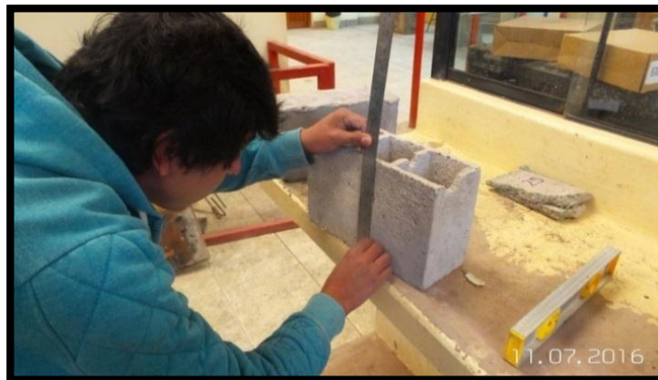
FIGURA 53: ENSAYO DE VARIACIÓN DIMENSIONAL - ALTURA
