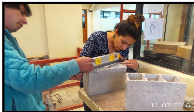
FIGURA 51: ENSAYO DE ALABEO
