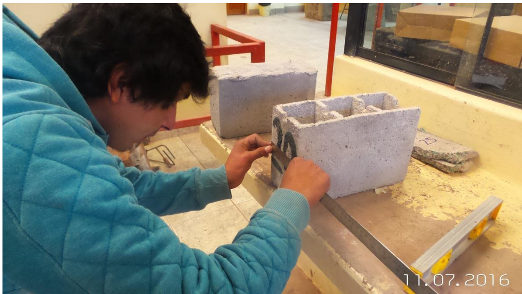
FIGURA 87: ENSAYO DE VARIACIÓN DIMENSIONAL DE LAS UNIDADES
