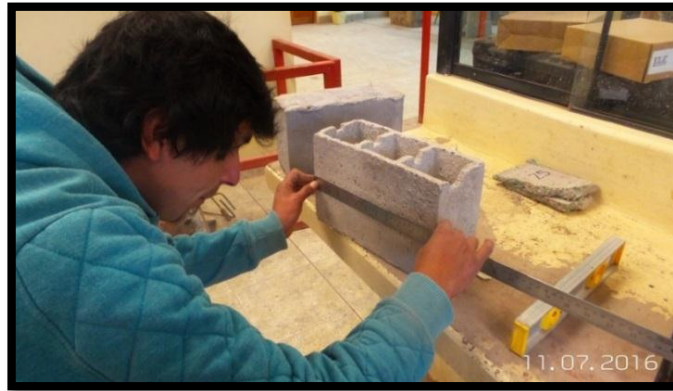
FIGURA 52: ENSAYO DE VARIACIÓN DIMENSIONAL - LONGITUD
