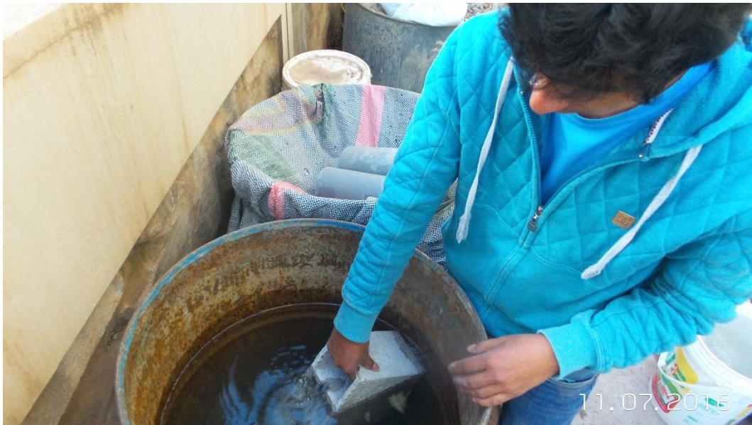
FIGURA 86: ENSAYO DE ABSORCIÓN DE LAS UNIDADES
