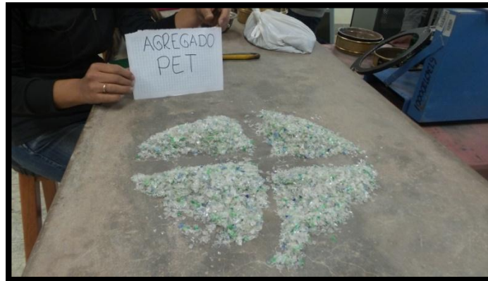
FIGURA 33: CUARTEO DE MATERIAL PARA GRANULOMETRÍA DEL PET
