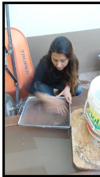
FIGURA 25: LAVADO DE MATERIAL PARA GRANULOMETRÍA DE AGREGADO FINO
