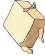
Los adobes hechos con suelos arenosos, se desmenuzan fácilmente cuando secan.
