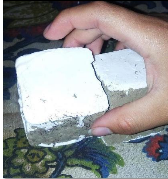
FIGURA N° 77 COLOCADO DEL CAPPING A LOS TESTIGOS CÚBICOS.
