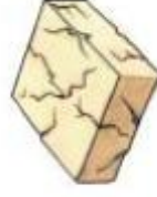
Los adobes hechos con suelos arenosos, se desmenuzan fácilmente cuando secan.
