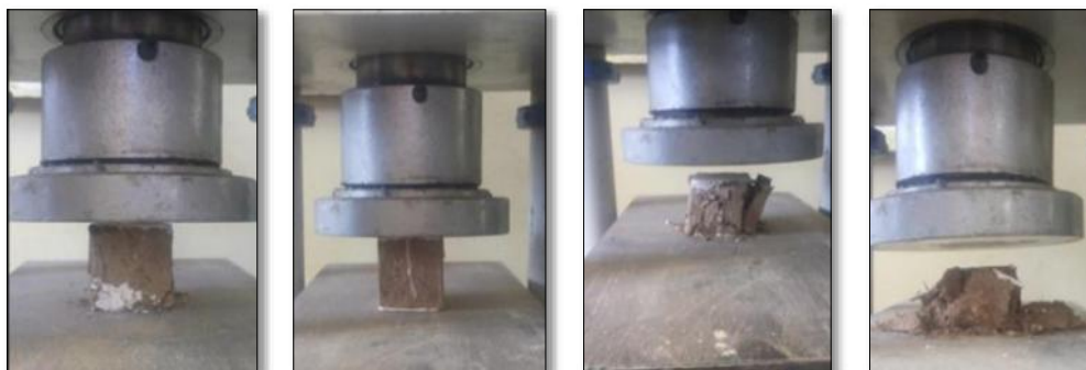
Se realiza la prueba de compresión de cada grupo de testigos cúbicos.
