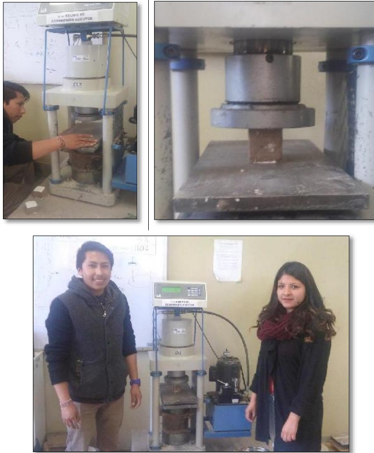
Se realiza la prueba de compresión de cada grupo de testigos cúbicos.
