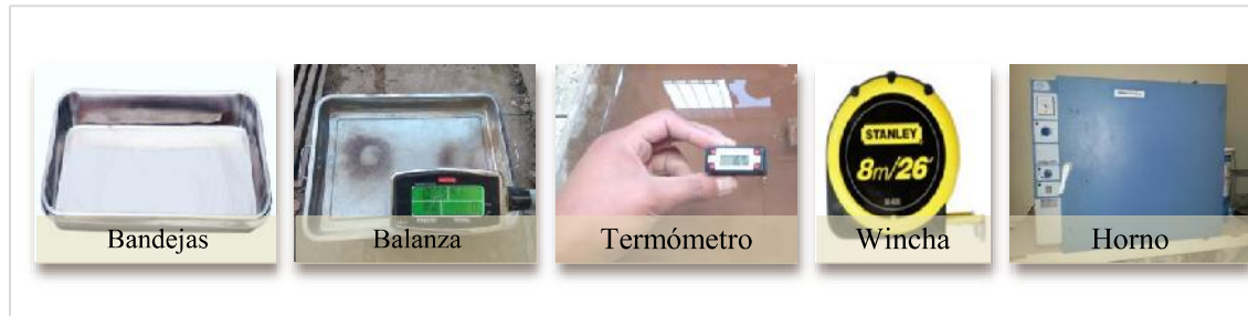
FIGURA N° 54 MATERIALES UTILIZADOS EN EL ENSAYO DE SUCCIÓN
