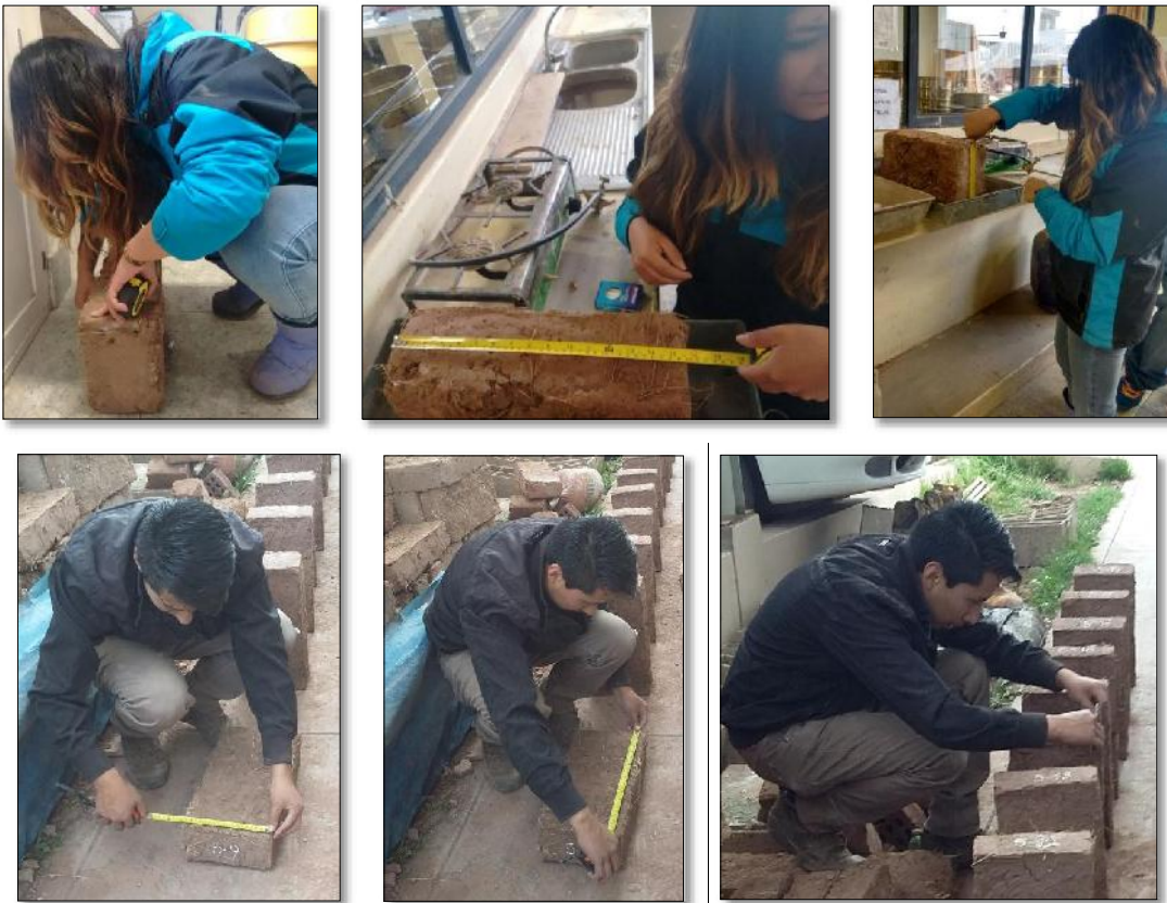
FIGURA N° 53 MEDICIÓN DE LA VARIACIÓN DE DIMENSIONES DE UNIDADES DE ADOBE.
