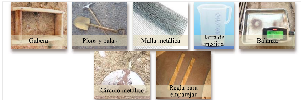
FIGURA N° 38 MATERIALES UTILIZADOS EN LA PREPARACIÓN DE LOS TESTIGOS
