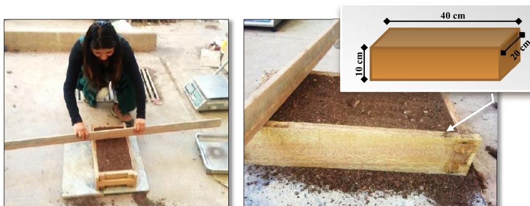
FIGURA N° 39 MEDIDA DEL VOLUMEN DE TIERRA CORRESPONDIENTE A UNA UNIDAD DE ADOBE
