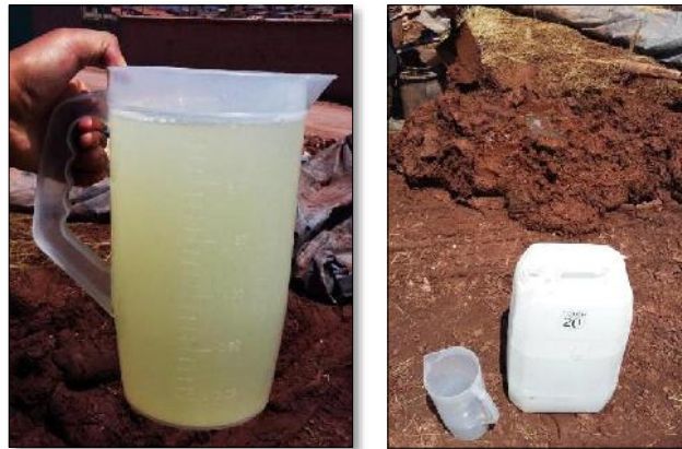
FIGURA N° 43 MEZCLA DEL BARRO CON EL MUCÍLAGO DE GIGANTÓN
