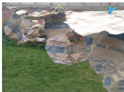
FIG. N° 19. Secado al Aire libre del Papel Multipliego Extensible
