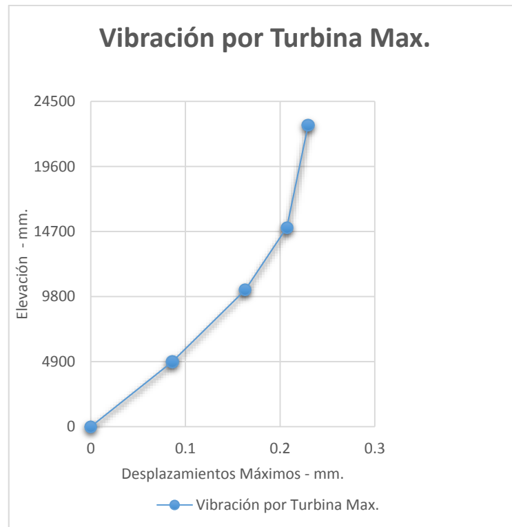
FIGURA N° 85: Desplazamiento lateral Máximo ante Vibraciones por Turbina Francis.
