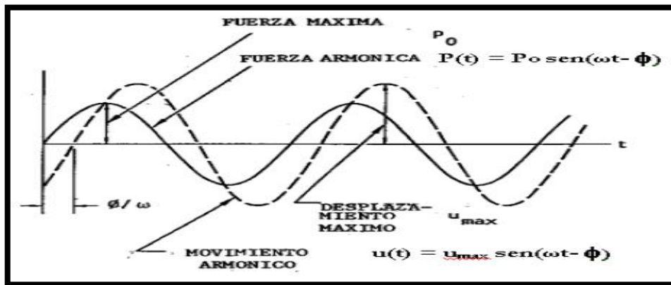
FIGURA N° 20: Desplazamiento inducido por fuerza armónica.
