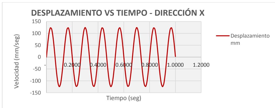
FIGURA N° 64: Desplazamiento en Dirección x Turbina Francis.
