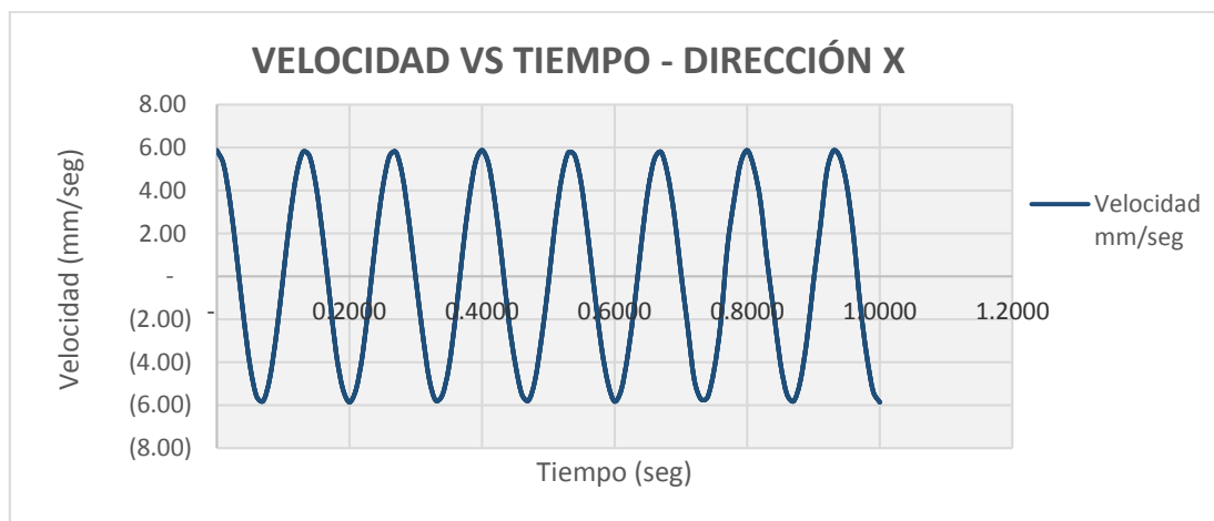
FIGURA N° 65: Velocidad en Dirección x Turbina Francis.
