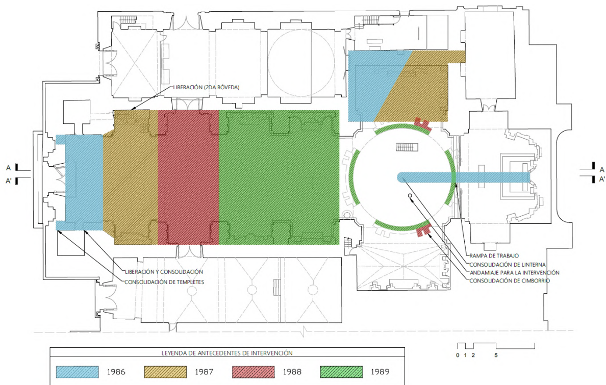
Figura 46: Intervenciones entre los años 1986 y 1989 en la planta de cubierta del Templo de la Compañía de Jesús
