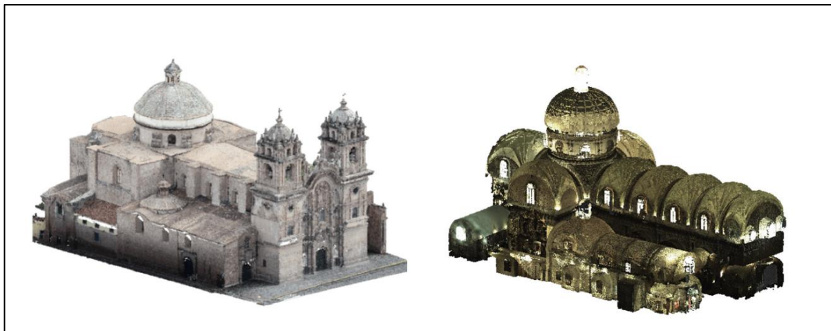
Figura 9: Nube de puntos híbrida de fotogrametría aérea y escaneo laser terrestre.
