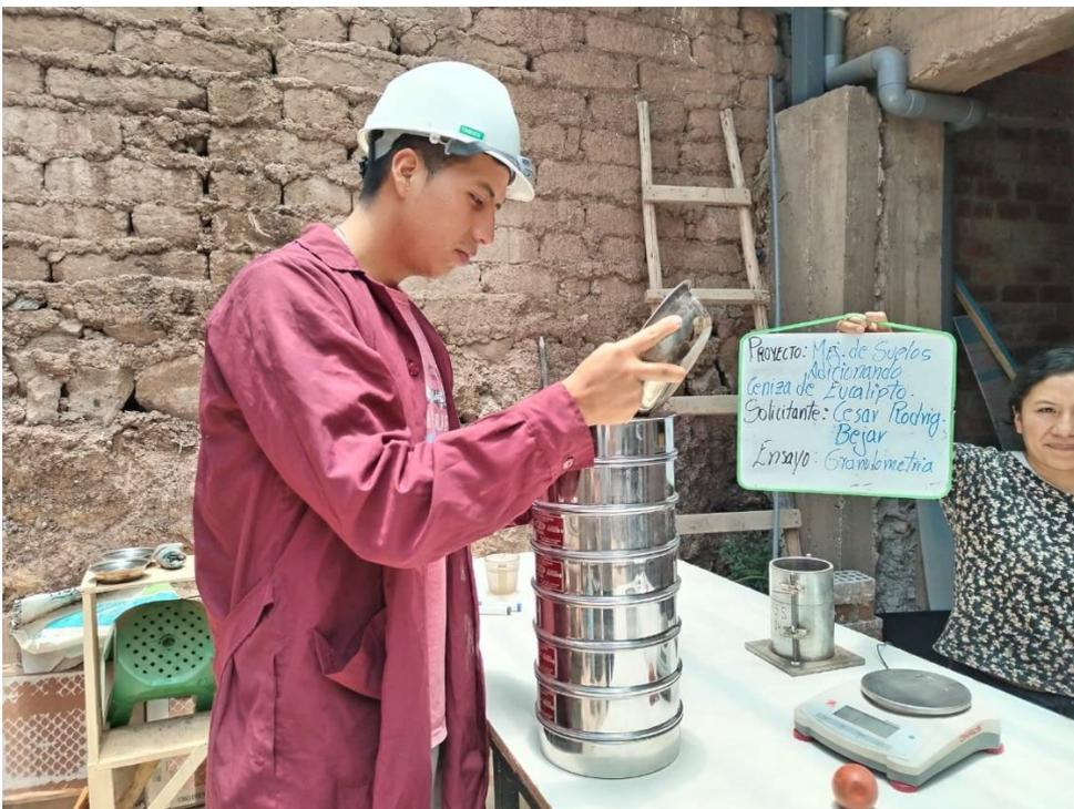
Figura 60. Trabajo de tamizado-ensayo de granulometría – zarandeo-3
