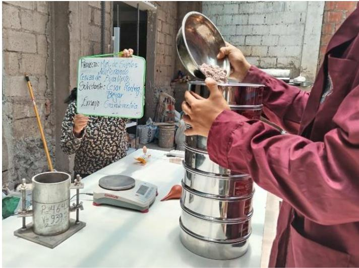
Figura 57. Trabajo de tamizado-ensayo de granulometría - zarandeo
