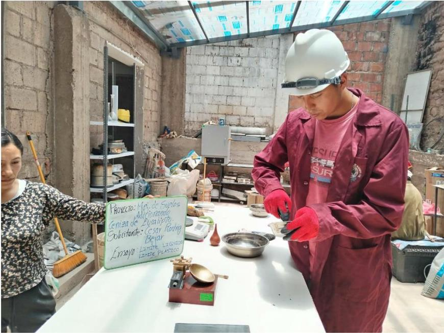
Figura 63. Evidencia de la prueba de Proctor
