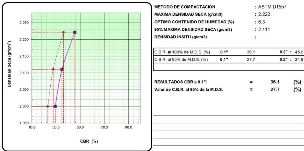
Tabla 105. Resultados de la densidad máxima y humedad óptima con la inclusión de ceniza de eucalipto al 22%
