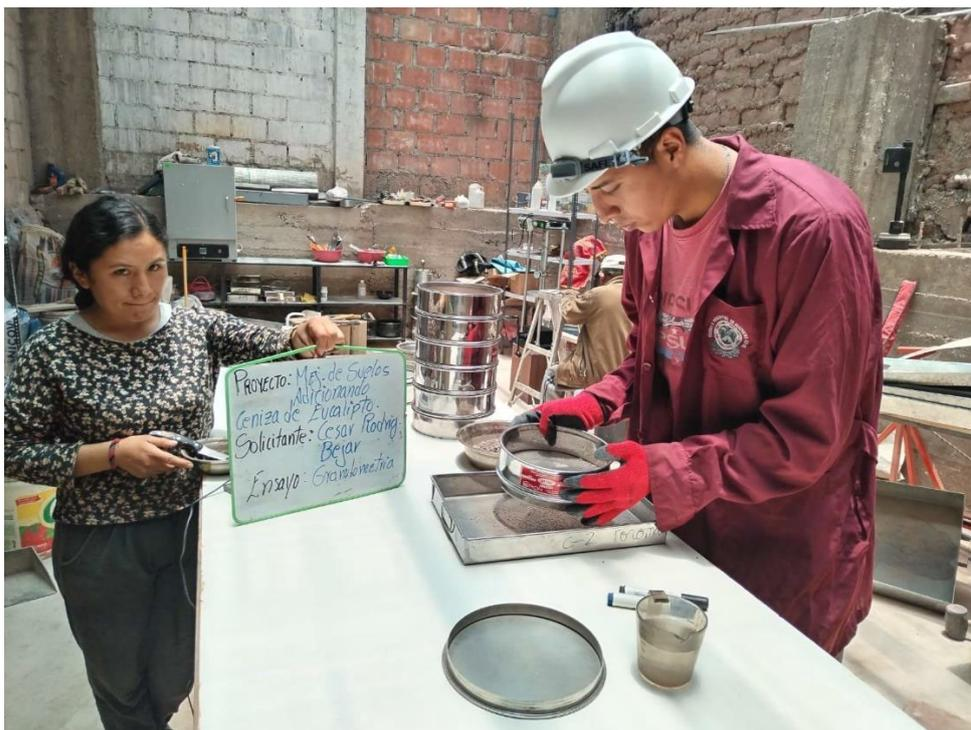
Figura 58. Trabajo de tamizado-ensayo de granulometría – zarandeo-2
