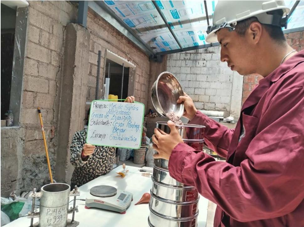
Figura 59. Trabajo de tamizado-ensayo de granulometría – zarandeo-3
