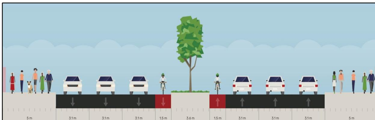
Para este tramo se tienen 2 propuestas, la **primera** es ubicar las ciclovías unidireccionales a la derecha de vía en ambos sentidos y la **segunda** modificar las dimensiones de la berma central, proponiendo una ciclovía bidireccional de 3.0m de ancho, de confinamiento de 1.8m para ambos extremos, cabe resaltar que se deben mover los postes de red eléctrica y el arbolado de este tramo.
