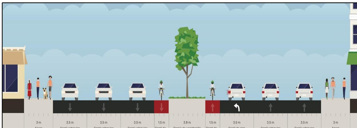
Para este tramo se tienen 2 propuestas, la **primera** es ubicar las ciclovías unidireccionales a la derecha de vía en ambos sentidos con 1.6m de ancho y la **segunda** modificar las dimensiones de la berma central, proponiendo una ciclovía bidireccional de 3.2m de ancho, con confinamiento de 1.9m para ambos extremos, cabe resaltar que se deben mover los postes de red eléctrico, semáforos y el arbolado de este tramo.
