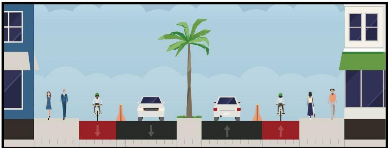
El diseño de una ciclovía debe tener en cuenta la velocidad del ciclista, el espaciamiento y la ubicación de la ciclovía. La velocidad del ciclista depende de la pendiente, a mayor pendiente en descenso se adquieren mayores velocidades, mientras que a mayor pendiente en ascenso disminuirá la velocidad (Municipalidad de Lima, 2017).
