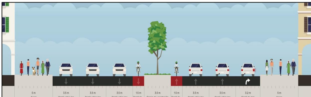
Para este tramo se tienen 2 propuestas, la **primera** es ubicar las ciclovías unidireccionales a la derecha de vía en ambos sentidos y la **segunda** modificar las dimensiones de la berma central, proponiendo una ciclovía bidireccional de 3.0m de ancho, de confinamiento de 1.75m para ambos extremos, cabe resaltar que se deben mover los postes de red eléctrico, semáforos y el arbolado de este tramo.
