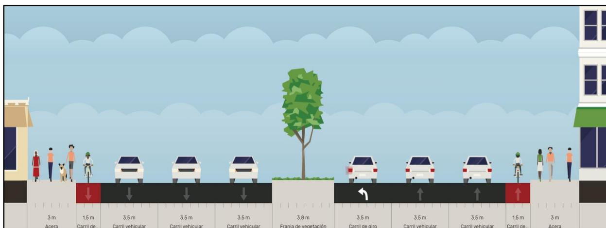
Figura 89: Propuesta 2 – Sección Transversal de la Intersección Prado
