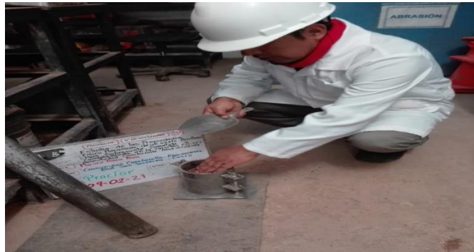
Figura N°59.- Adecuación del material para la prueba Proctor.
