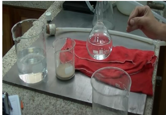
Figura N°12.- Equipos para determinar el Peso Específico del Suelo
