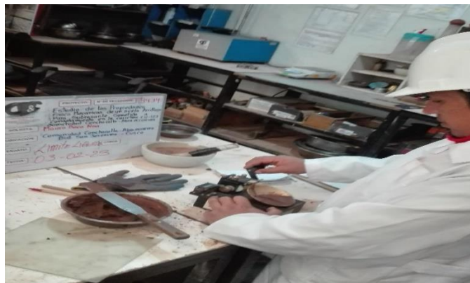
Figura N°50.- Uso de la cuchara de Casa Grande.
