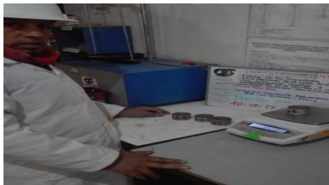
Figura N°58.- Peso de la muestra luego de compactado
