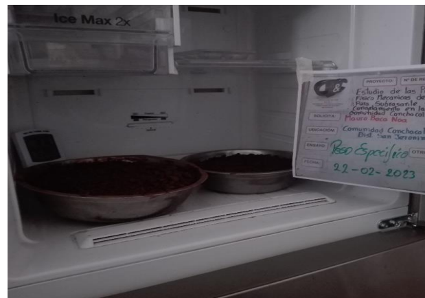
Figura N°46.- Muestra congelada para el Peso Específico para suelo congelado a -10\text{ }^{\circ}\text{C} .
