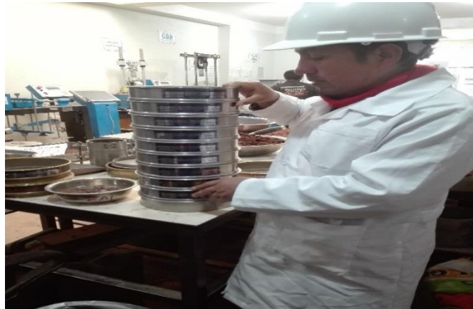
Figura N°42.- Proceso de Tamizado calicata N°+-03
