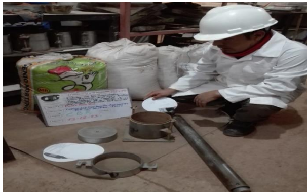
Figura N°60.- Colocación del filtro para prueba BCR.
