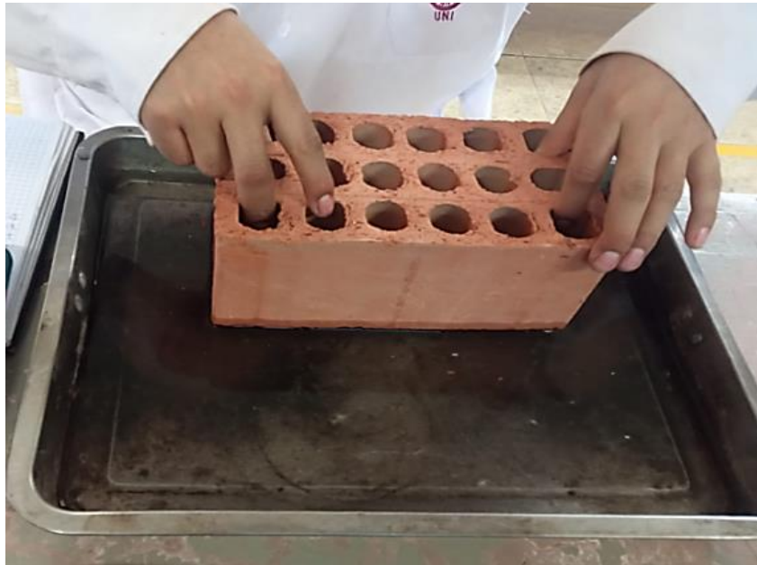
Figura 35 Colocado de la unidad de albañilería en el recipiente con agua.
