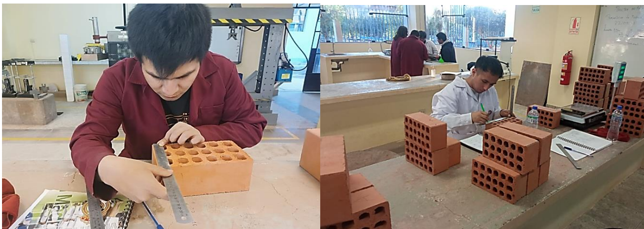
Figura 29 Medición de largo, ancho y altura de la unidad de albañilería
