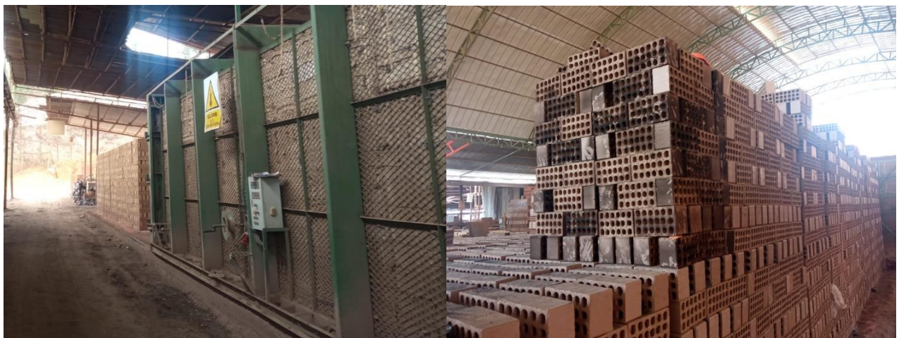
Figura 85 Unidades de ladrillo colocadas en el horno móvil para el proceso de cocción.
