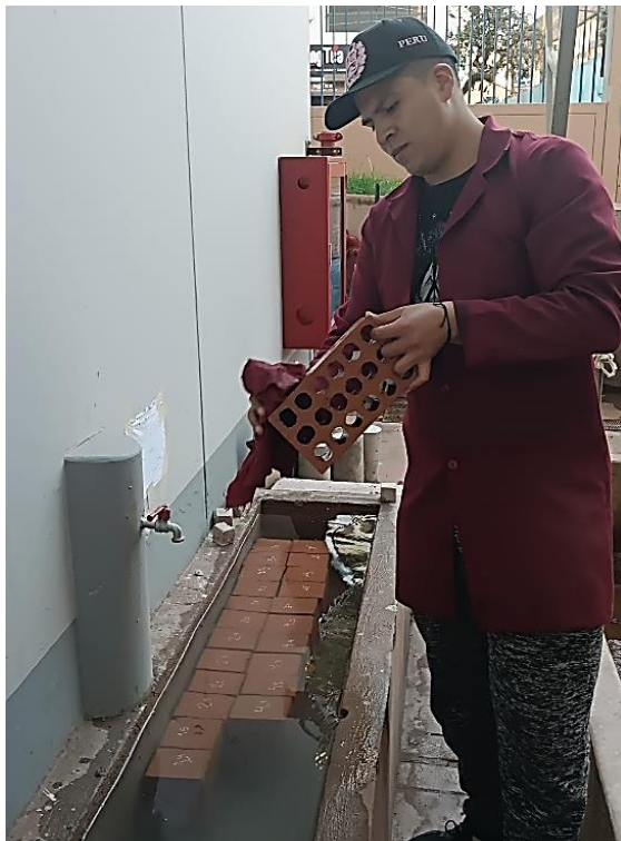
Figura 39 Secado de muestras con un paño seco.
