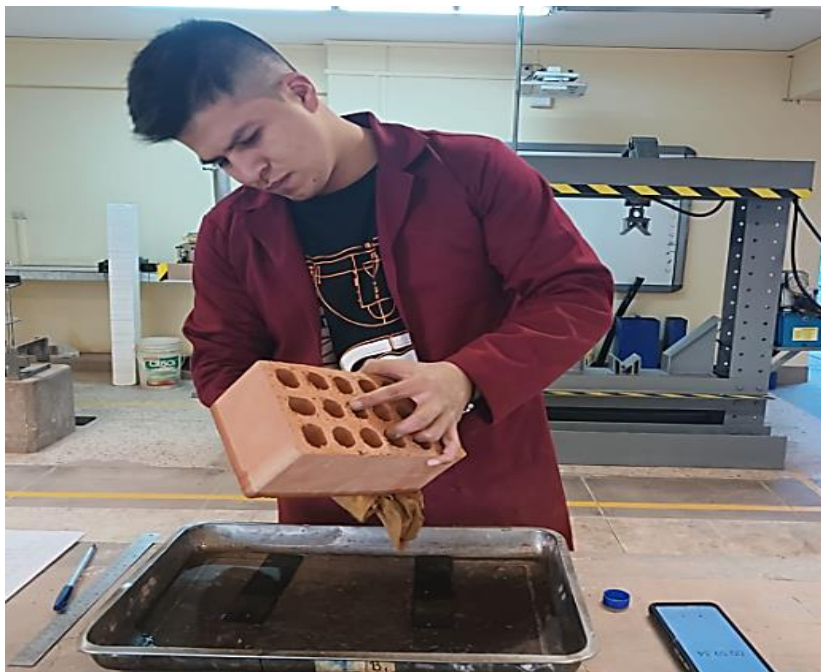
Figura 36 Secado con paño húmedo a la unidad de Albañilería.
