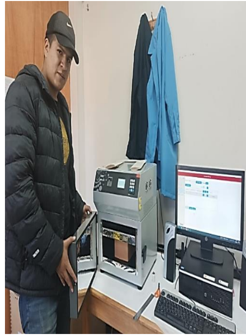
Figura 100 Colocado de la muestra en la maquina HFM-100
