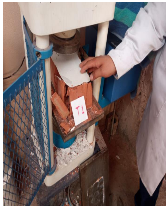
Figura 168 Ruptura de ladrillo. Ensayo de compresión
