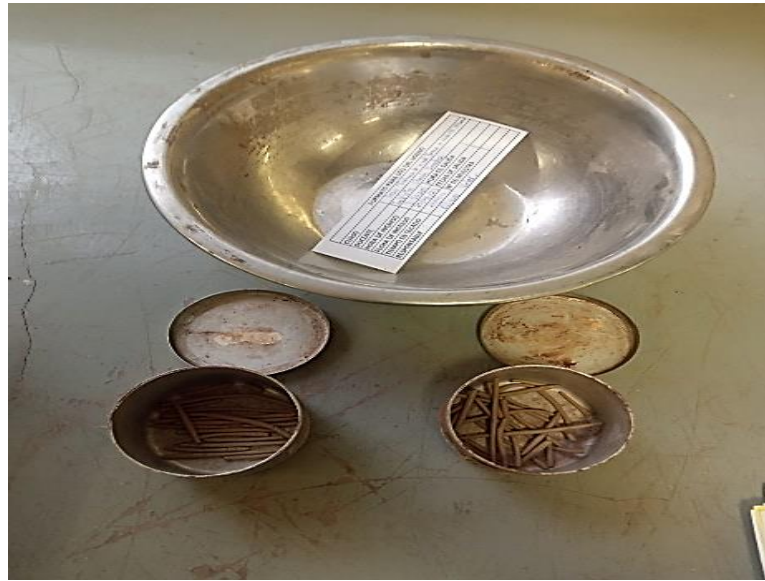
Figura 28 Muestras de material post secado para el ensayo de Limite Plástico.
