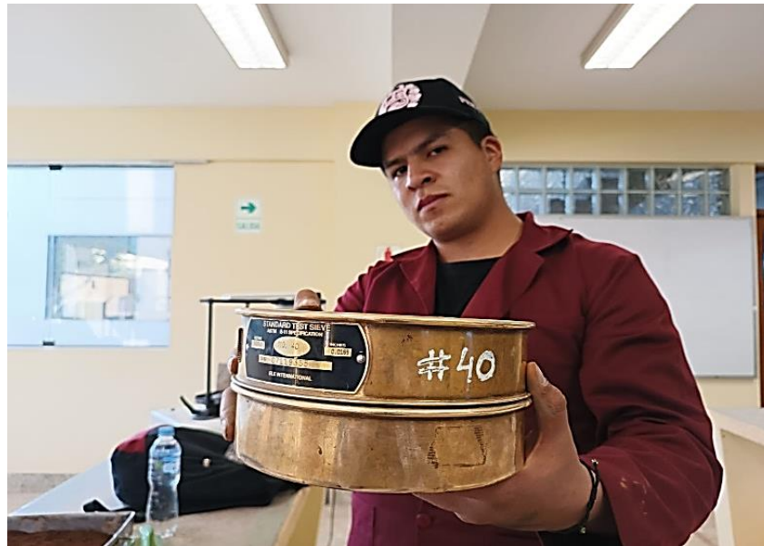
Figura 89 Tamizado de material para el ensayo de límites de Atterberg.
