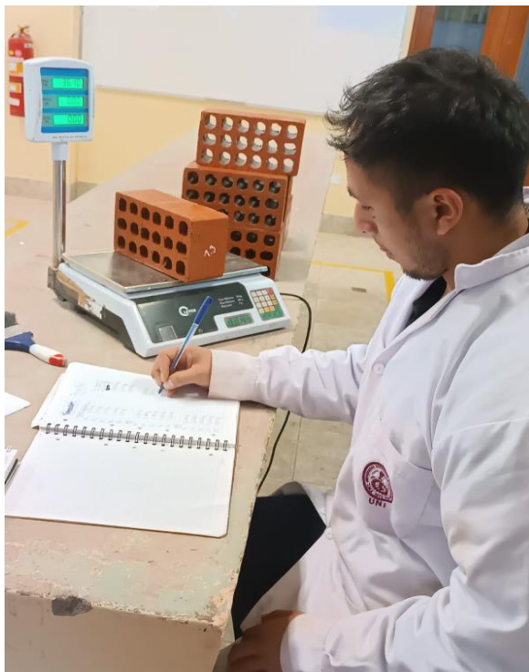
Figura 167 Apunte de resultados del ensayo de Absorción.
