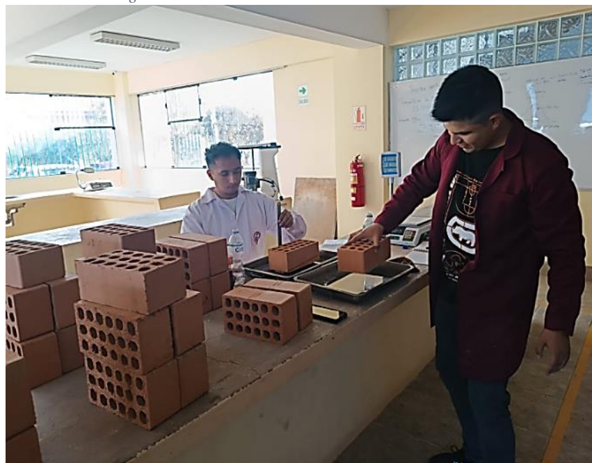
Figura 34 Colocado de la unidad de albañilería.
