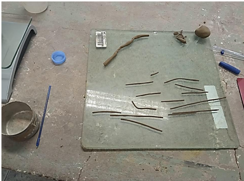
Figura 92 Material moldeado en hilos para el ensayo de limite plástico.
