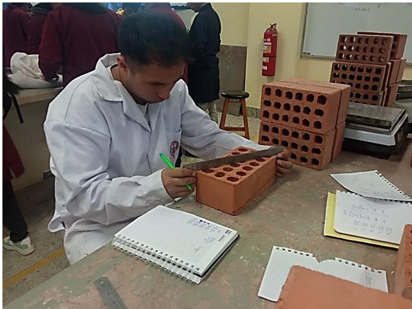
Figura 95 Procedimiento del ensayo de alabeo.
