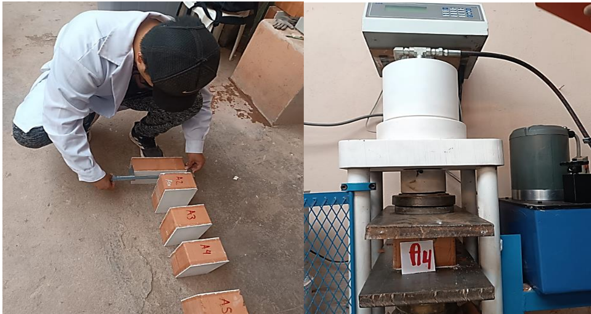
Figura 41 Medición y colocado de las unidades de albañilería en la máquina de compresión.
