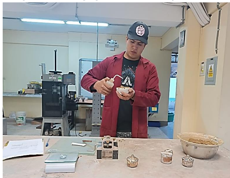
Figura 90 Adición de agua gradualmente sobre el recipiente cerámico.
