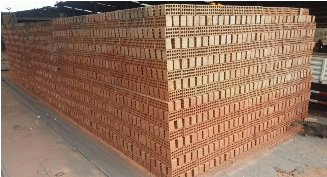
Figura 74 Proceso de Enfriamiento posterior a la cocción.
