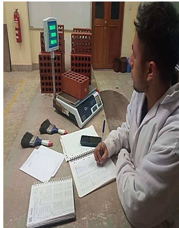
Figura 40 Toma de datos post sumersión.
