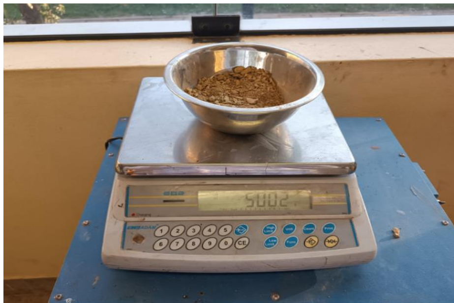
Figura 19 Pesado de arcilla, arena o tierra negra, independientemente separados.
