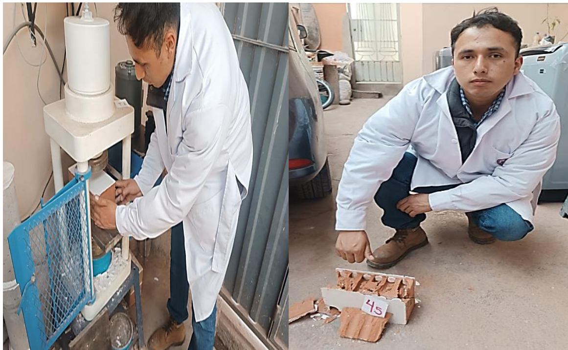
Figura 42 Resultado de las unidades de albañilería post rotura.
