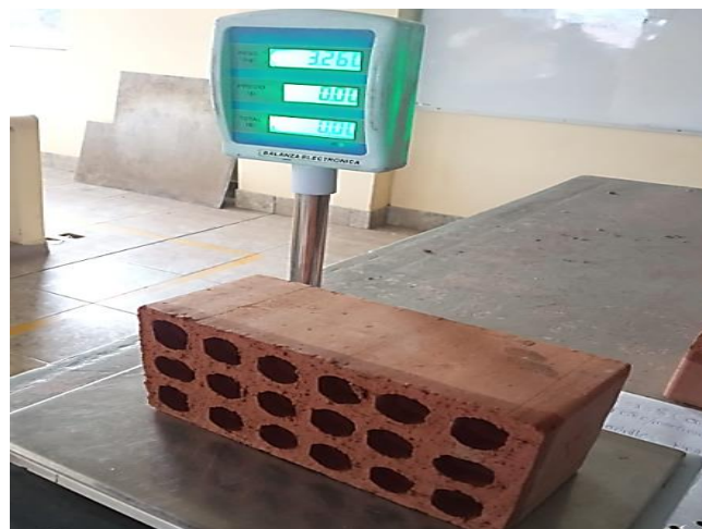
Figura 32 Pesado de la unidad de Albañilería.
