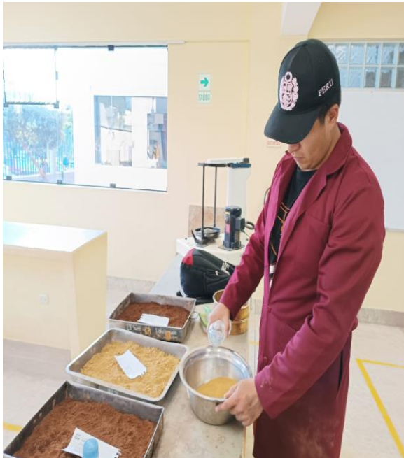
Figura 158 Ensayo de límites de atterberg
