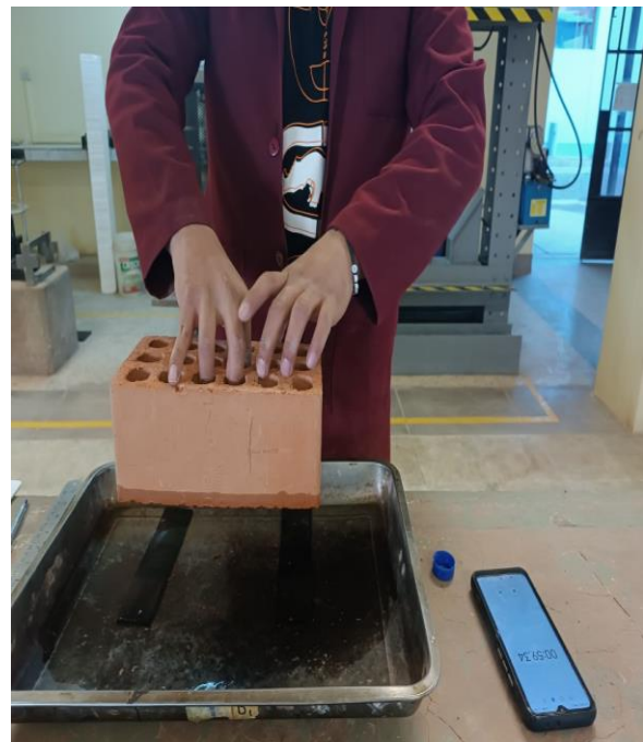
Figura 164 Procedimiento del ensayo de Succión.
