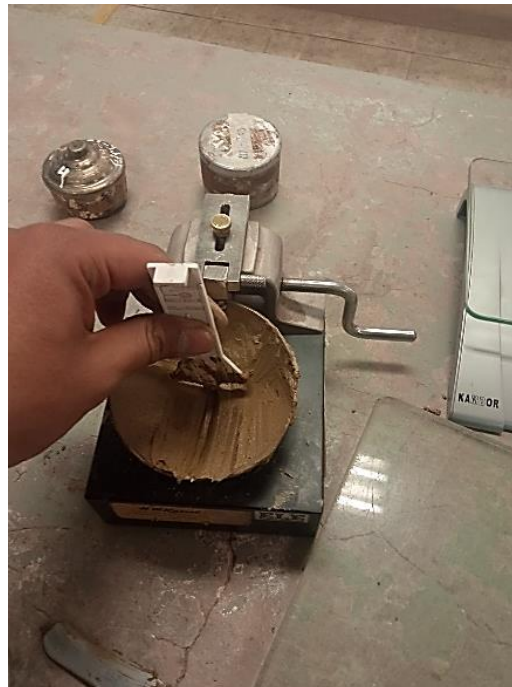
Figura 25 Retiro de muestra con el acanalador del aparato de Casagrande.
