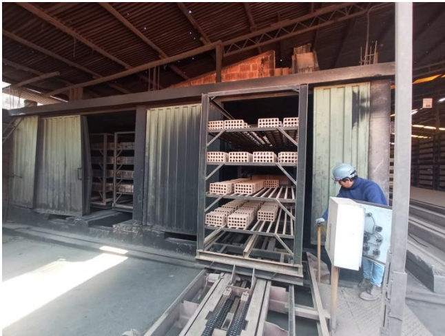
Figura 83 Ingreso de ladrillos al secadero.
