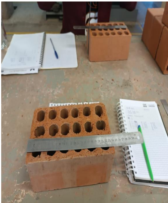
Figura 163 Ensayo de Variación dimensional
