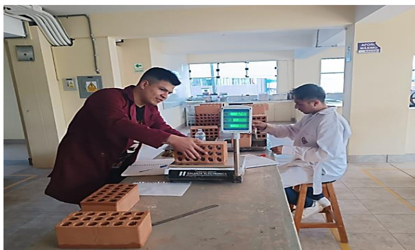
Figura 96 Peso del ladrillo para obtener los datos finales del ensayo de succión.
