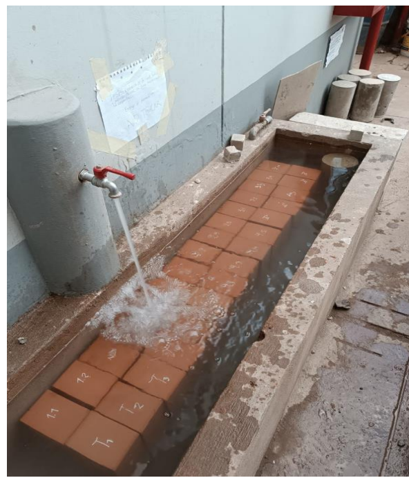
Figura 166 Relleno de agua, por 24 hrs.
