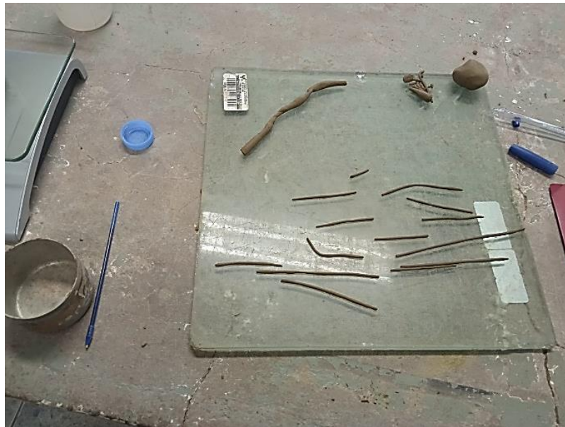
Figura 27 Conformación de hilos para el ensayo de Limite Plástico.
