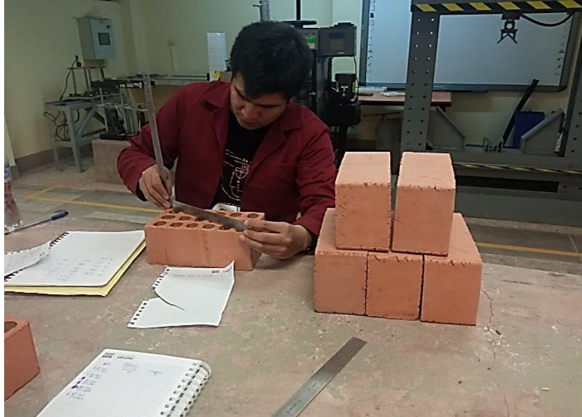
Figura 94 Procedimiento del ensayo de alabeo
