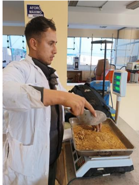
Figura 88 Peso del material hacer llevado al horno.
