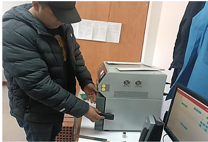
Figura 46 Sellado con la unidad de Albañilería en el Termica- Heat Flow Meter-100.
