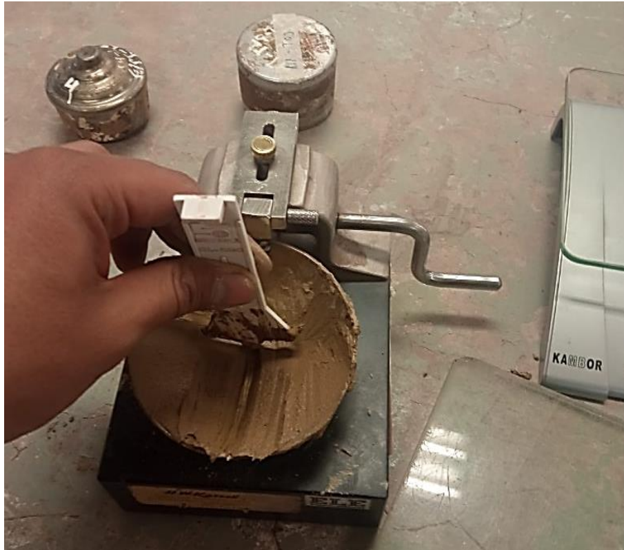
Figura 91 Muestra extraída con acanalador de la copa de Casagrande.
