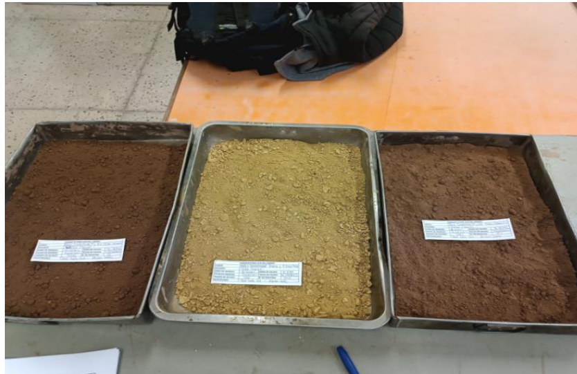
Figura 20 Colocación de arcilla, arena y tierra negra, independientemente separados cada materia prima para ser llevados al horno.
