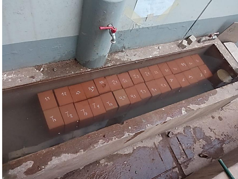
Figura 38 Unidades sumergidas en agua para el ensayo de Absorción
