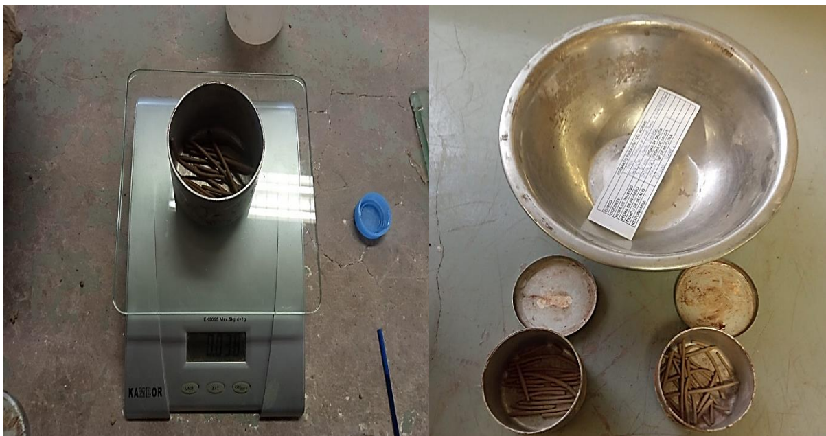
Figura 93 Muestra húmeda y seca para el ensayo del límite plástico.
