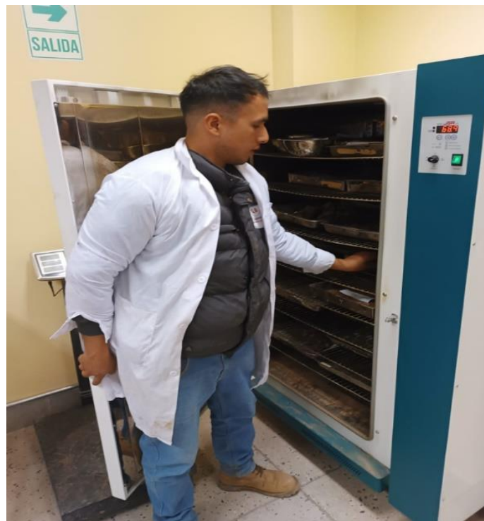
Figura 21 Colocación de arcilla, arena y tierra negra en el horno para su cocción por 24 horas a 110 \pm 5^{\circ}\text{C}
