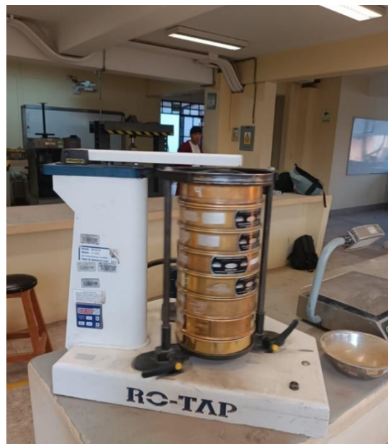
Figura 23 Tamizado de la arcilla, arena o tierra negra, independientemente separados cada materia prima.
