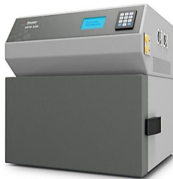
Figura 7 Equipo HFM -100 para el ensayo de conductividad térmica
