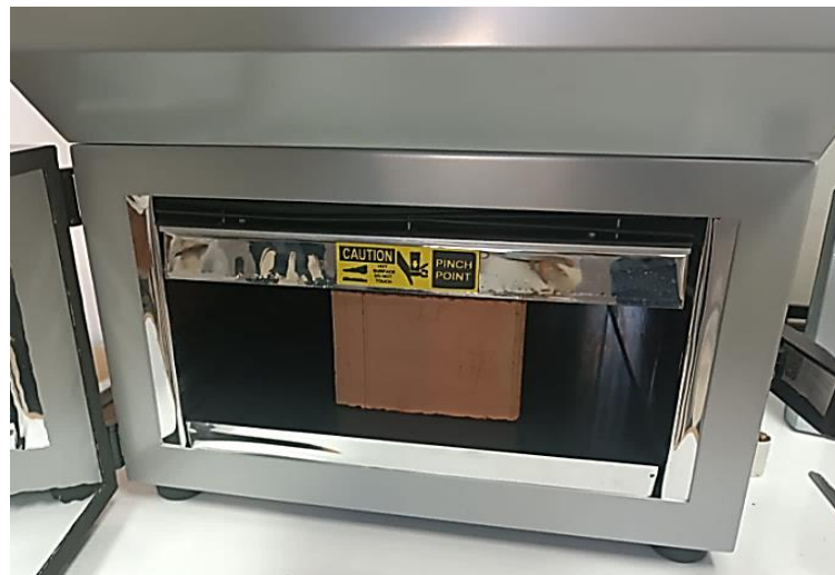
Figura 45 Verificación de correcto colocado de la unidad de Albañilería a Térmica- Heat Flow Meter-100 s
