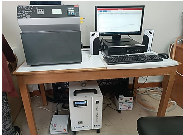
Figura 43 Maquina de conductividad Termica- Heat Flow Meter-100 s y computador para obtención de resultados.
