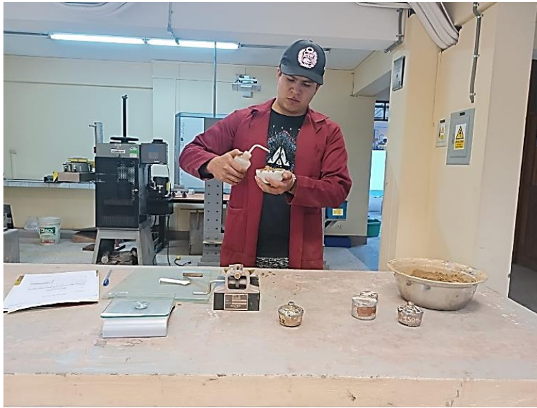
Figura 24 Mezcla de agua en el contenedor de porcelana con la muestra.
