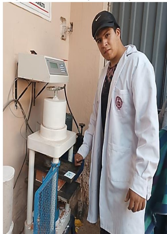
Figura 98 Realización de la prueba de compresión.
