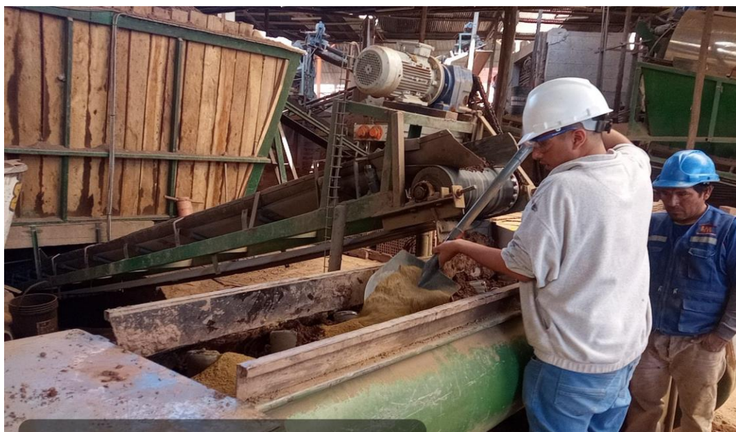
Figura 78 Mezcla al interior del depósito de la extrusora según dosificación
