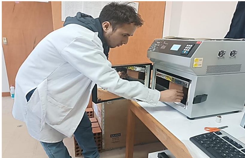
Figura 44 Colocación de la unidad de Albañilería a Termica- Heat Flow Meter-100 s
