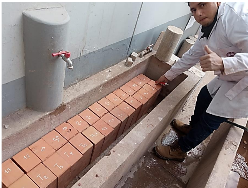
Figura 37 Identificación de unidades y colocado en el contenedor.
