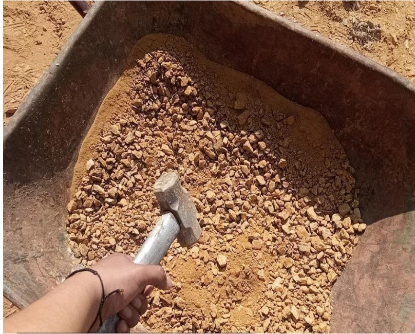
Figura 75 Chancado manual de arcilla con combo.
