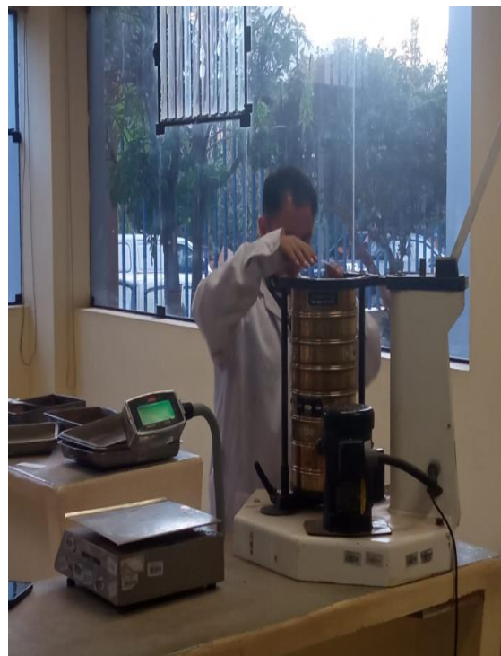
Figura 157 Ensayo de Granulometría.
