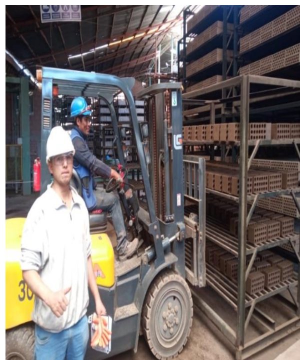
Figura 149 Orden y colocado de los ladrillos en andamio.
