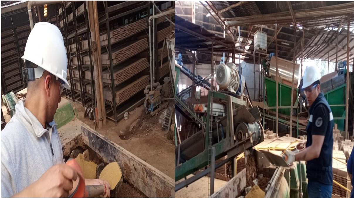
Figura 147 Colocado de arcilla en mayor porcentaje de acuerdo al porcentaje de dosificación.
