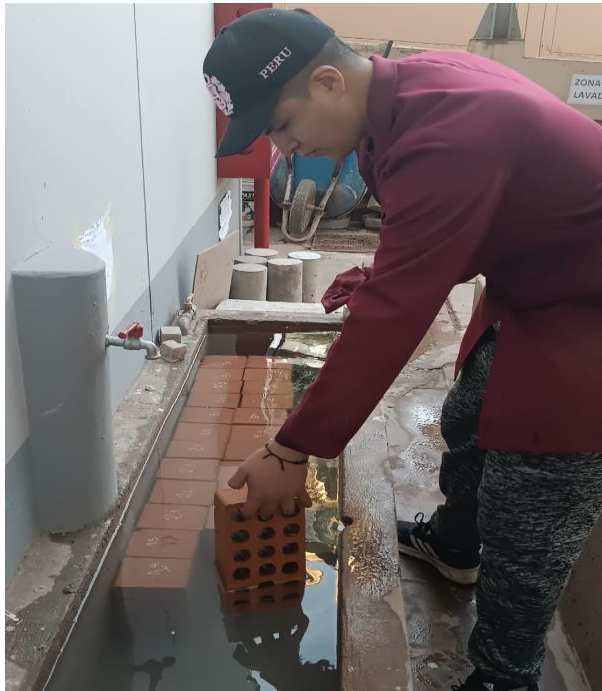
Figura 165 Sumergido de los ladrillos para el E. de Absorción.
