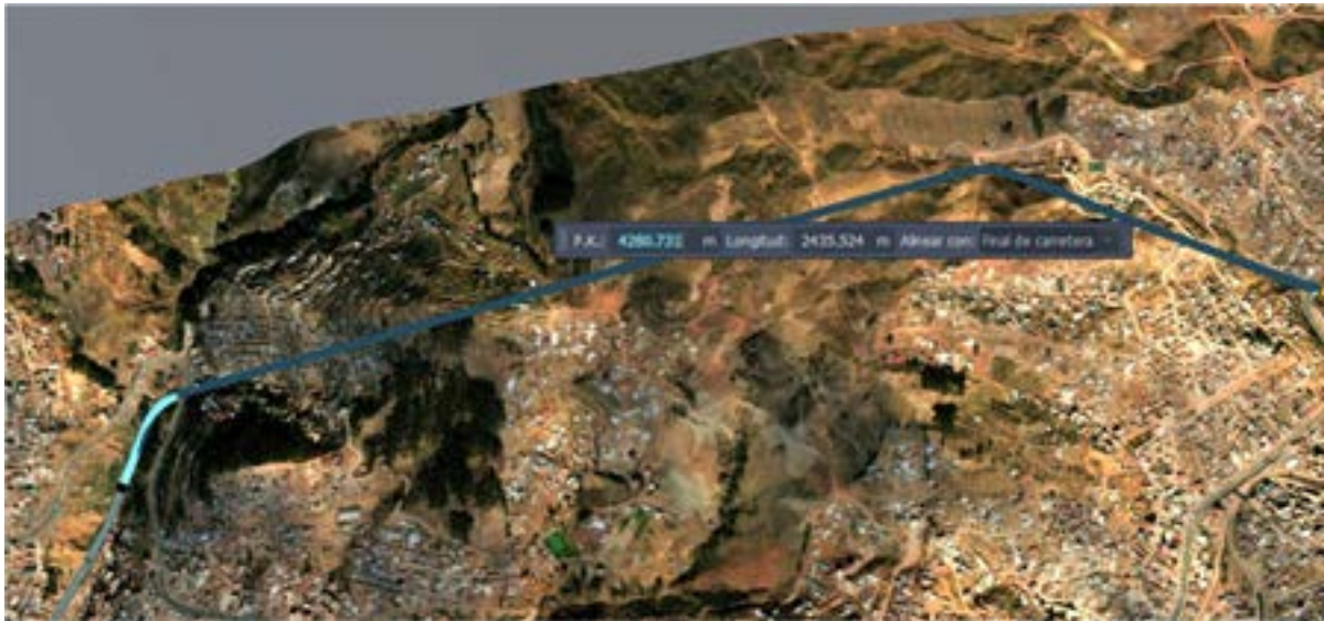
Figura 83 Trazado en planta del túnel
