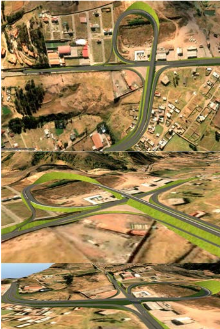
Figura 96 Alternativa 01 de intercambiador entre PE-3S y PE-28F
