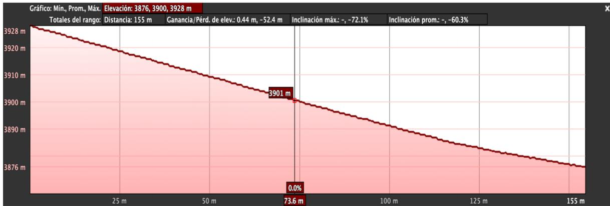
La pendiente del primer tramo corresponde a 33%, la zona cuenta con cobertura vegetal, según la tabla difundida por el MINAGRI las zanjas de infiltración corresponden a un 30% de pendiente (aproximándolo) y un distanciamiento entre zanjas de 17 metros. Por lo tanto, corresponde hacer 4 (cuatro) líneas de zanjas de infiltración.
