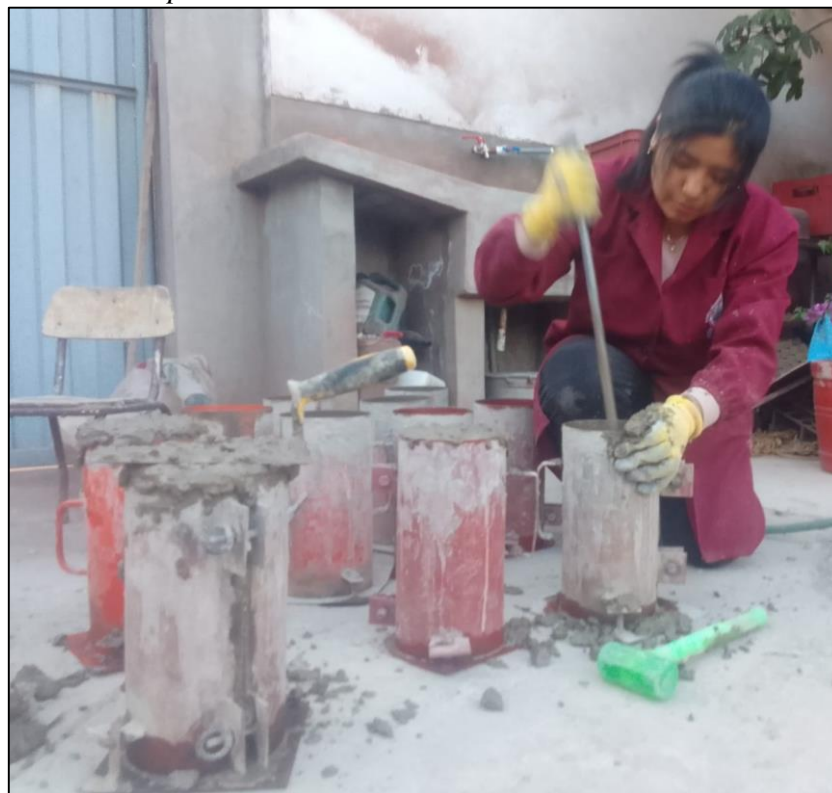
Figura 114. Elaboración de las probetas cilíndricas.
