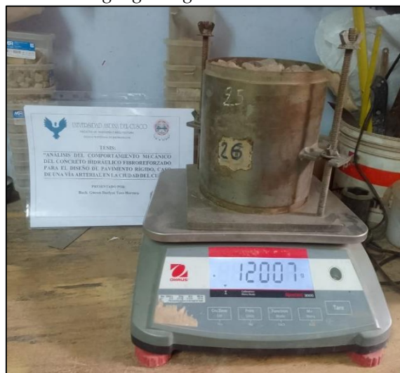
Figura 98. Peso de una muestra del Agregado grueso más el molde.
