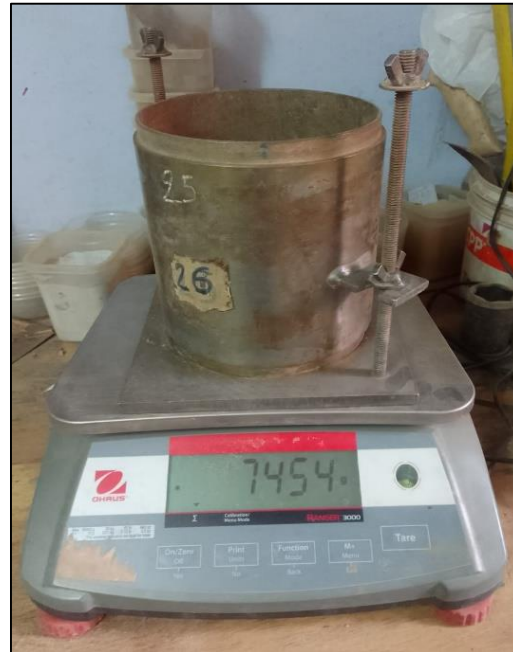
Figura 97. Determinación del peso del molde.
