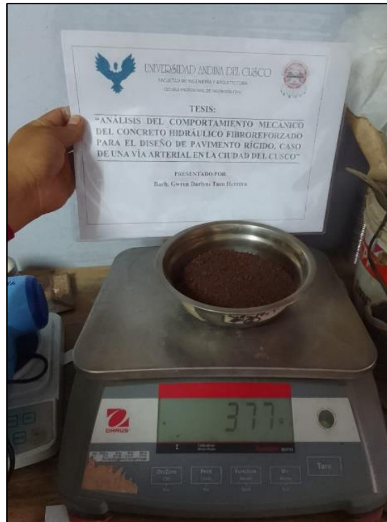
Figura 84. Peso de la Muestra del Agregado fino.
