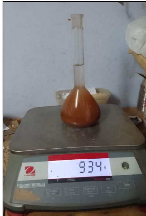
Figura 86. Peso de la fiola más agua y el Agregado fino.
