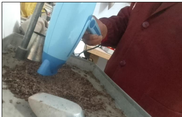
Figura 81. Muestra de Agregado fino sometida a una corriente suave de aire caliente.
