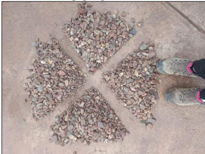
Cuarteo de la muestra del Agregado grueso
