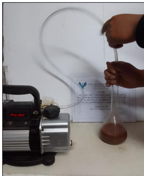
Figura 85. Uso de la bomba de vacíos para eliminación del aire en la Fiola.
