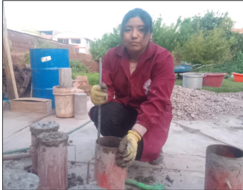
Figura 113. Varillado de concreto en las briqueteras.
