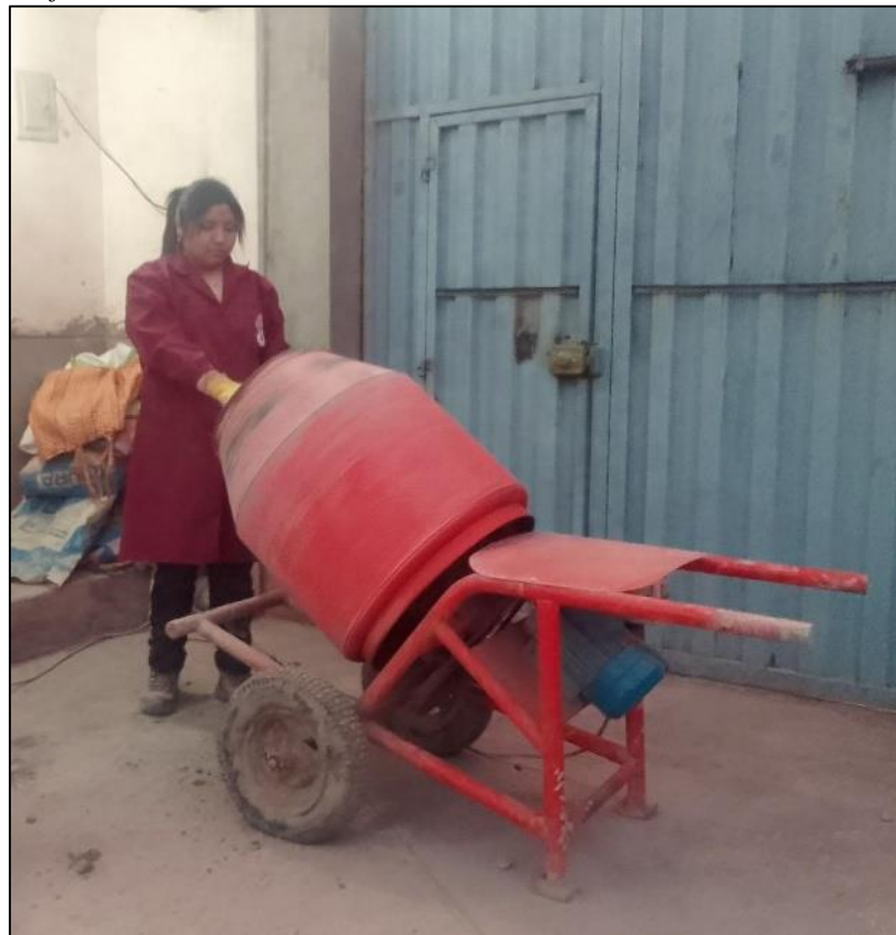
Figura 124. Adición de fibras metálicas FF1 en la mezcladora
