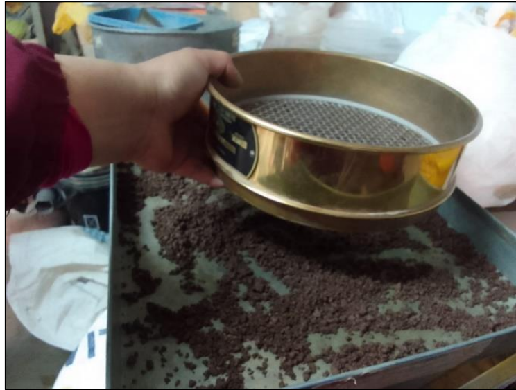
Figura 80. Selección de muestra del Agregado fino.
