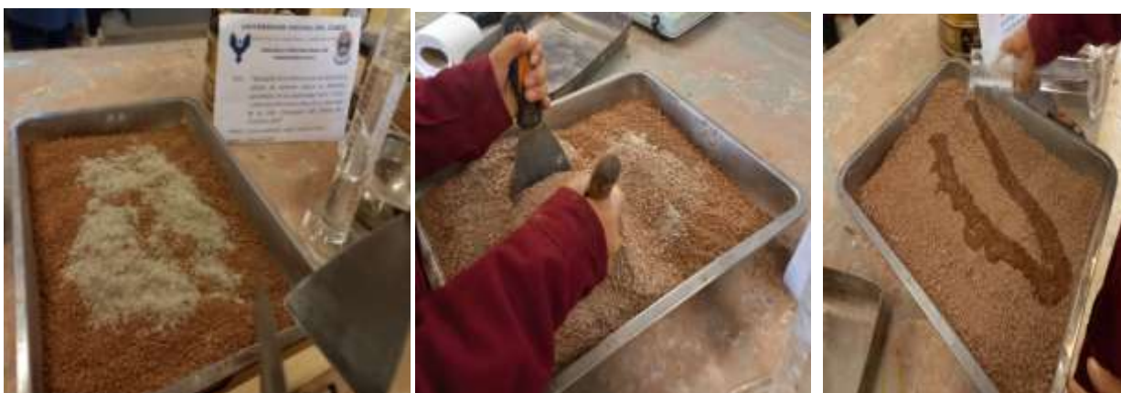
Mezclado de la muestra para el ensayo de proctor modificado
