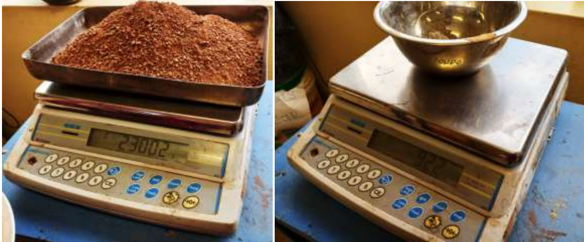
Pesado de la muestra para el ensayo de proctor modificado
