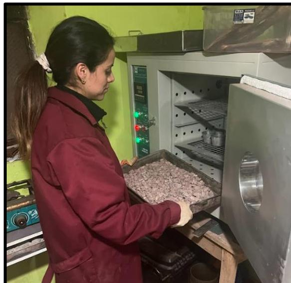
*Nota.* En la figura se aprecia la aplicación del horno eléctrico para la determinación de la cantidad de humedad de los agregados.
