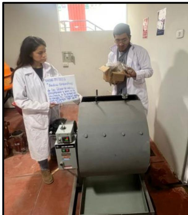
*Nota.* Se aprecia los instrumentos y aplicación de los pasos para la determinación de la resistencia a la abrasión mediante la aplicación de la máquina de los ángeles.
