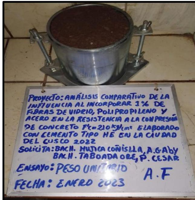
*Nota.* En la figura se aprecia la aplicación del ensayo del peso unitario para el agregado fino.
