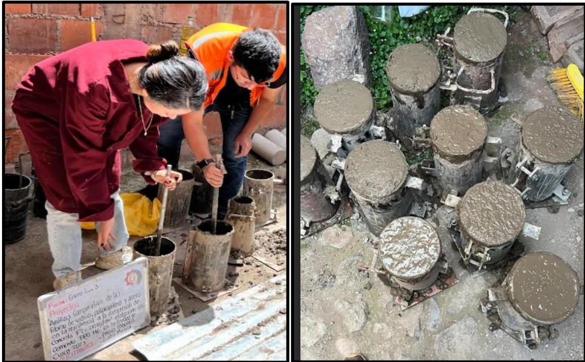
*Nota.* Aplicación de la mezcla de concreto en las briqueteras.
