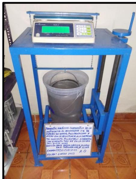
*Nota.* En la figura se aprecia la aplicación de los instrumentos y el ensayo del peso específico del agregado fino.
