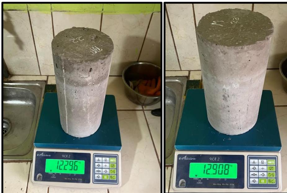
*Nota.* Taraje de las muestras a ser ensayadas en la maquina a compresión y determinar la resistencia a compresión a la cual pueden soportar.
