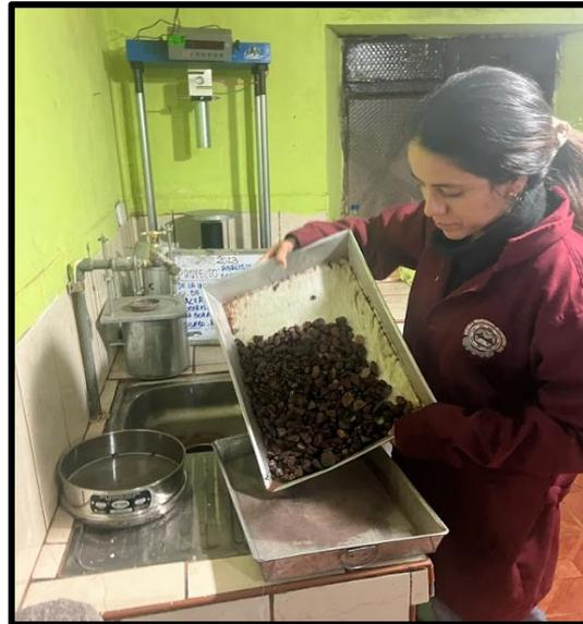
*Nota.* En la figura se puede apreciar el uso de las bandejas para la el ensayo de tamizaje de los agregados finos y guresos.
