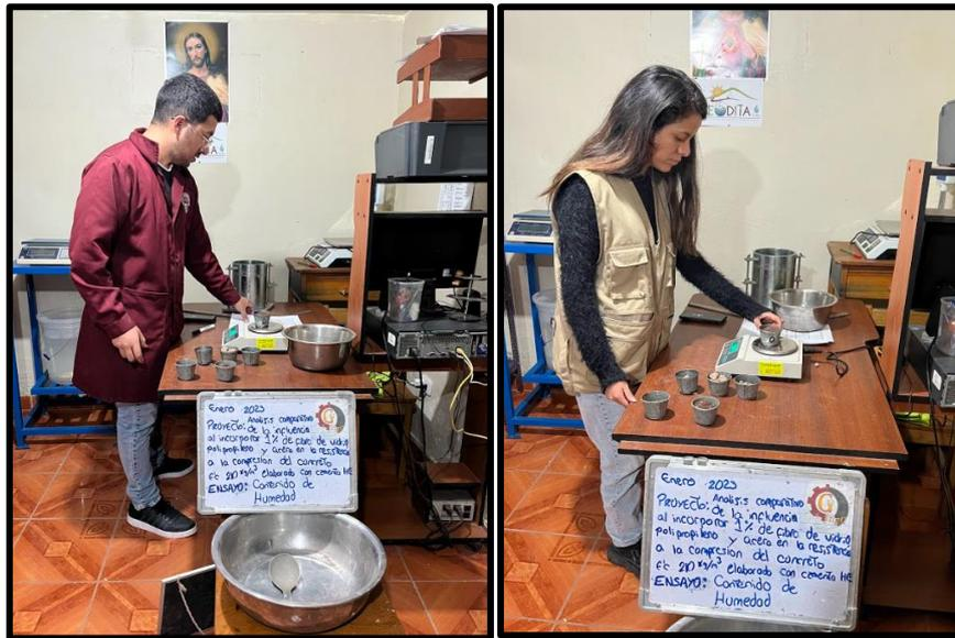
*Nota.* Se aprecia los instrumentos y aplicación de los pasos para la determinación del porcentaje de humedad de los agregados.
