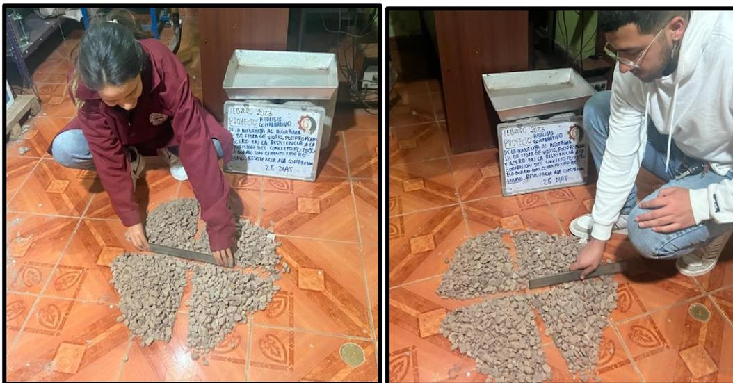
*Nota.* En la figura se aprecia la aplicación del método de cuarteo para el agregado fino y agregado grueso.
