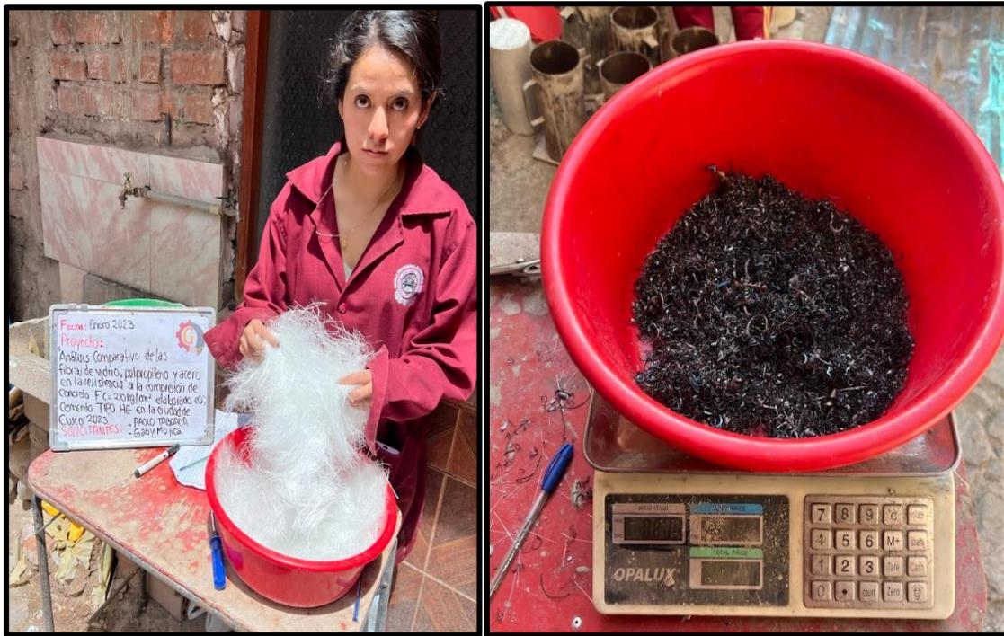
*Nota.* Se aprecia la aplicación de las fibras a la elaboración del concreto  $f'c=280 \text{ Kg/cm}^2$ .
