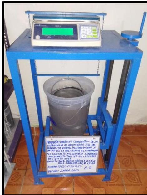
*Nota.* Se aprecia los instrumentos y aplicación de los pasos para la determinación del Peso específico del agregado grueso.
