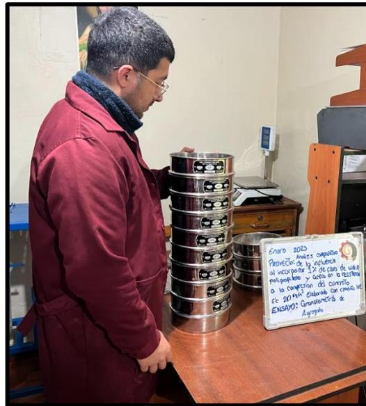
*Nota.* En la figura se puede apreciar el uso del juego de tamices para la determinación de la granulometría para los agregados finos y gruesos.
