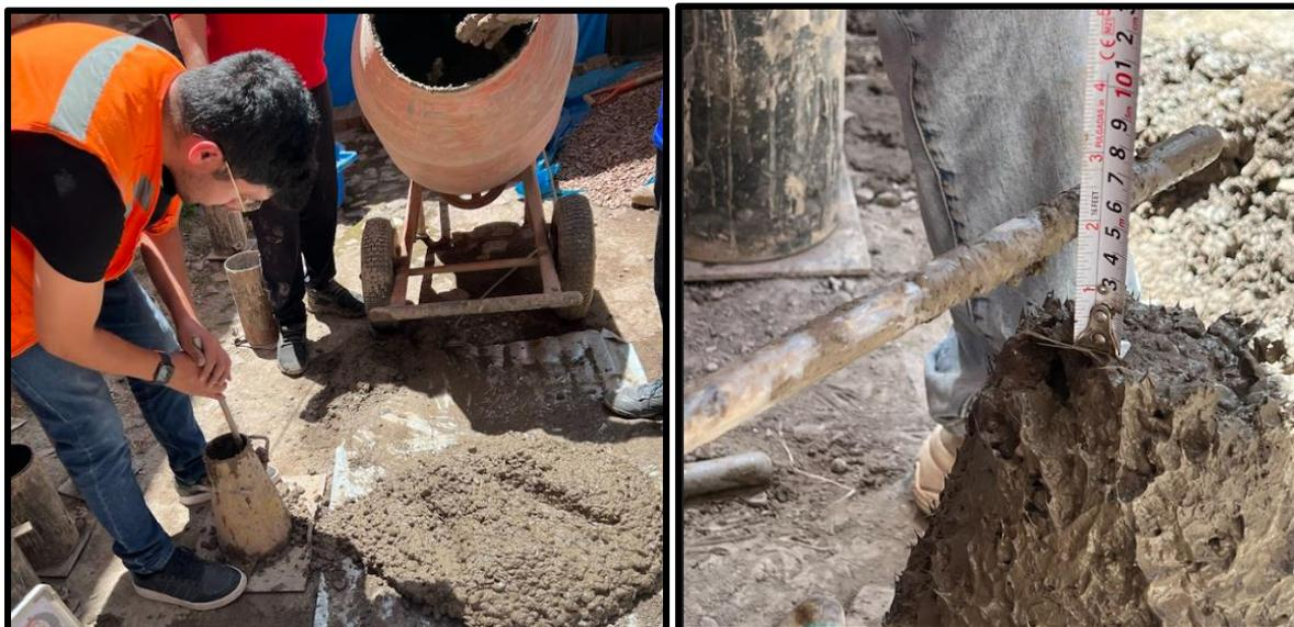
*Nota.* Determinación del slump del concreto fresco.
