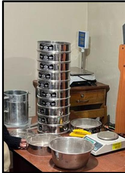
*Nota.* En la figura se aprecia la aplicación del ensayo del tamizado para la determinación de la granulometría de los agregados.
