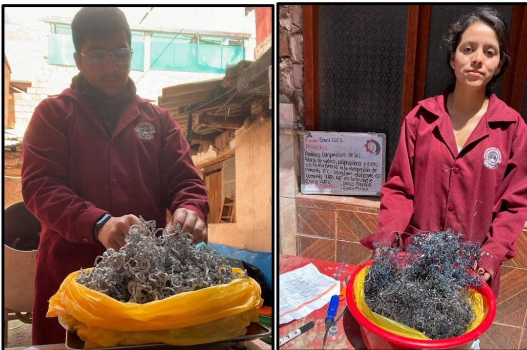
*Nota.* Se aprecia la aplicación de las fibras de acero a la elaboración del concreto  $f'c=280 \text{ Kg/cm}^2$ .
