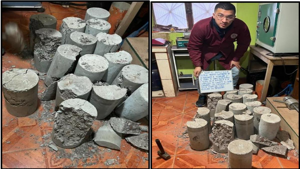
*Nota.* Muestras después de la aplicación del ensayo de resistencia a la compresión la cual fue aplicada mediante una maquina compresora.
