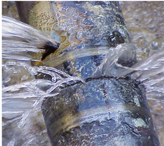
*Ilustración 18- Rotura de tubería por golpe de ariete*
