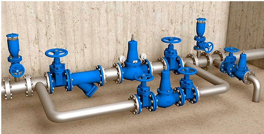
*Ilustración 9- Cámara de válvula reguladora de presión*
