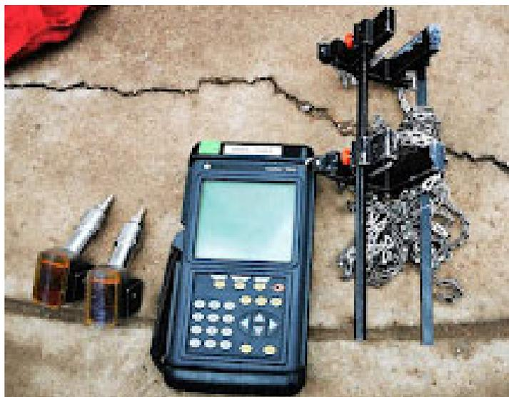
*Ilustración 24- Caudalímetro Ultrasonico Portátil*
