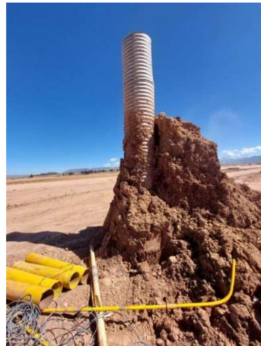
Figura 191 Instrumentación colocada, water point y placa de asentamiento
