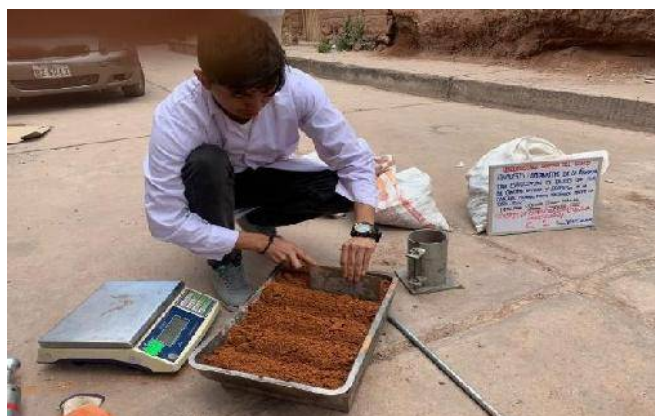
Figura 92: Se obtiene una muestra de unos 36 kg y se cuartea en porciones de 6kg.
