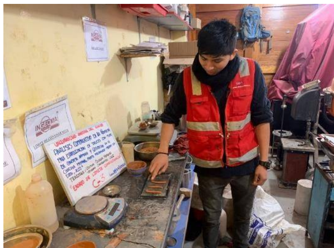
Figura 83: Realización del ensayo limite plástico.
