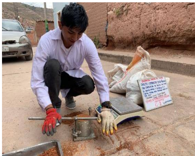
Figura 94: Realización de compactación.
