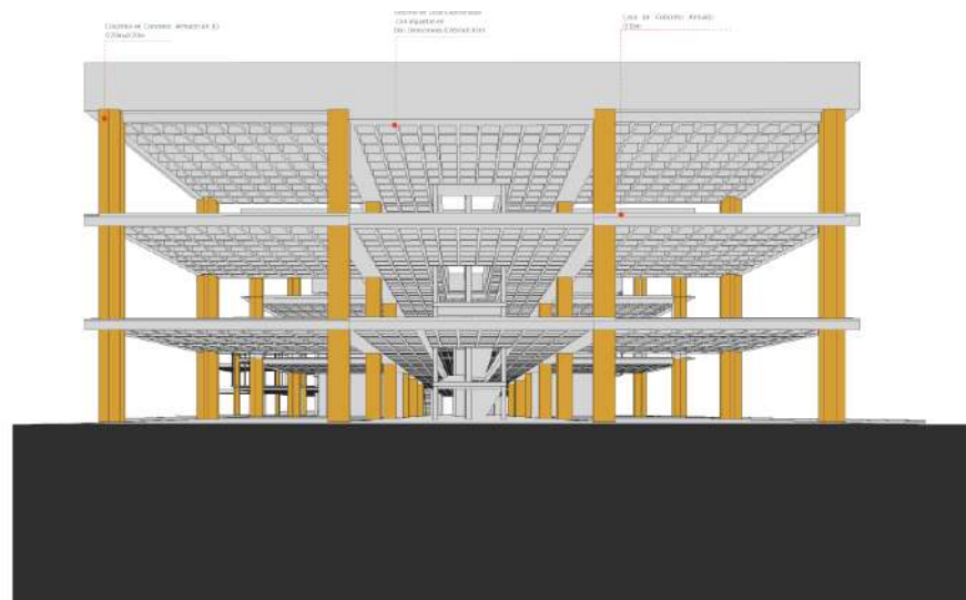
Figura 116. Vista en perspectiva de Losa casetonada
