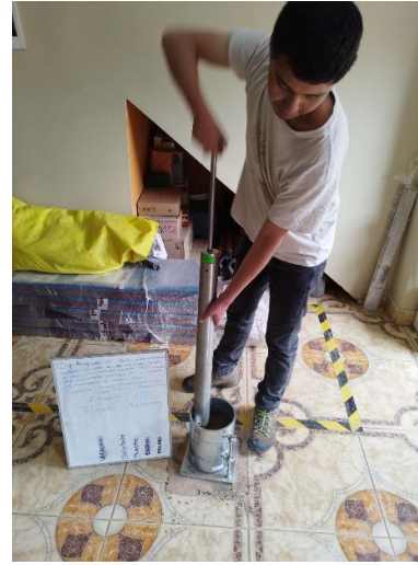
Figura 26: Apisonado de material CBR
