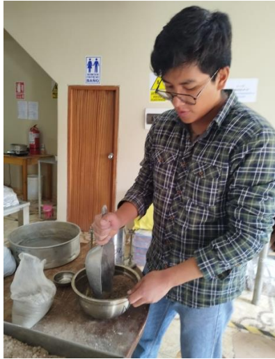
Figura 27: Preparación de muestras con la humedad óptima brindada por el ensayo Proctor.
