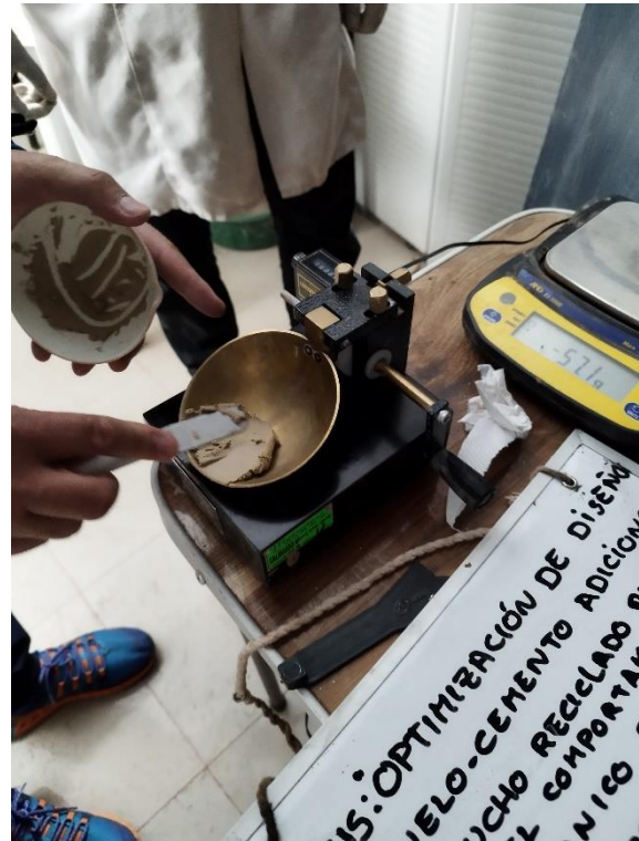
Figura 153: Preparación de suelo y colocado en la cuchara de Casagrande (Ensayo Limite Liquido)
