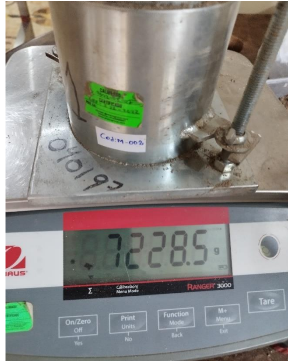
Figura 169: Nivelado y pesaje de molde con muestra compactada
