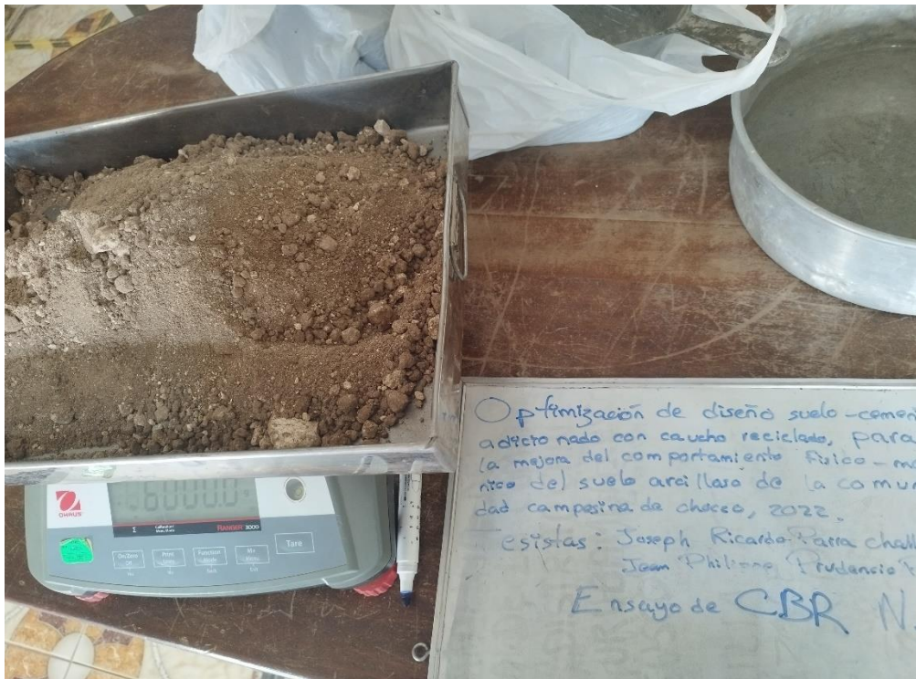
Figura 173: Preparado de muestra ensayo de CBR
