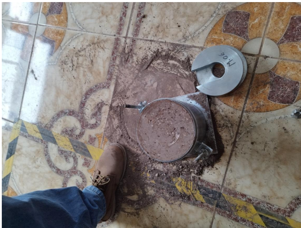
Figura 174: Molde con muestra sin collarín Ensayo de CBR
