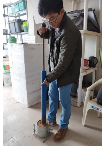
Figura 19: Apisonado en molde proctor.
