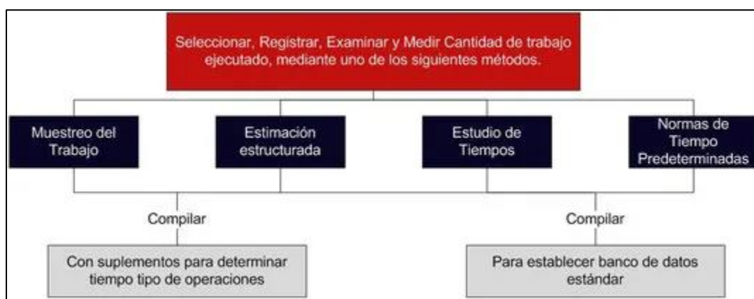
Figura N° 10: Principales técnicas que se usan en la Medición del Trabajo Fuente (Oficina Internacional del Trabajo, 1996, pág. 256)
