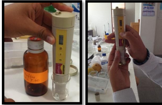
(Fig.2). CALIBRACIÓN EL pH METRO
