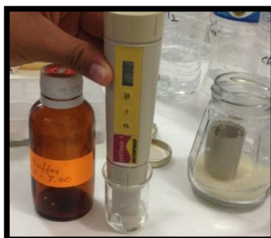
(Fig. 11) CALIBRACIÓN DEL pH metro CON SOLUCION BUFFER (7)
