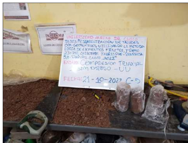
Figura 93: Muestras ya moldeadas y cubiertas con cinta de embalaje
