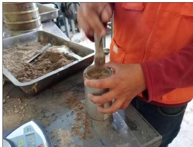
Figura 95: Proceso de compactación con ayuda de un pisón en 3 capas
