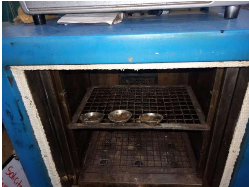
Figura 67: Colocación de la muestra en el horno para determinar su contenido de humedad
