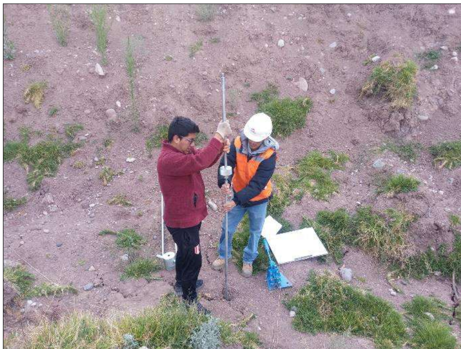
Figura 104: Ensamblaje del equipo DPL
