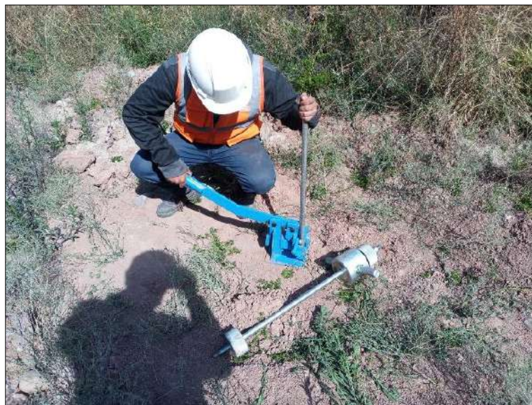
Figura 107: Extracción de las varillas penetradas
