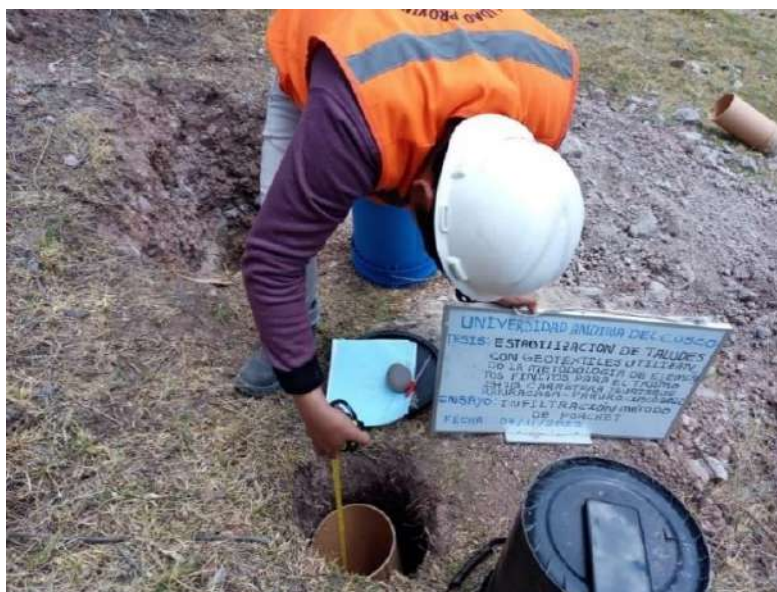
Figura 87: Colocación del tubo de en el agujero
