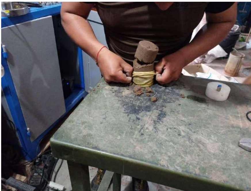
Figura 103: Vista de la Falla de la muestra fuera de la Cámara de confinamiento
