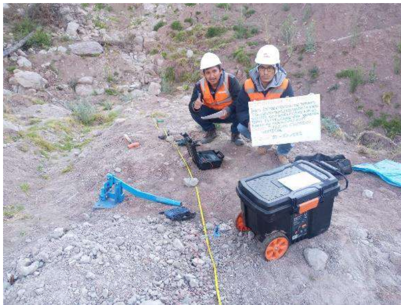
Figura 39: Fijación en el terreno el punto elegido como centro del SEV
