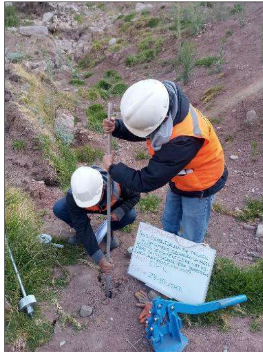
Figura 106: Acoplamiento de una segunda varilla
