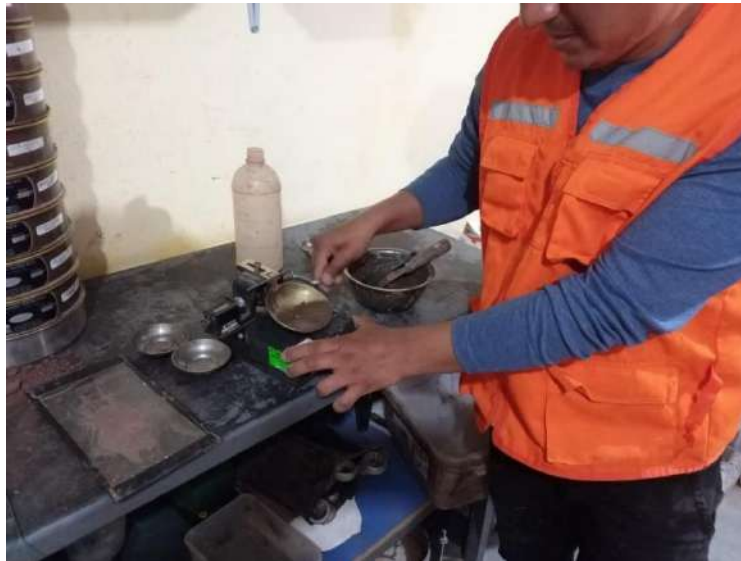
Figura 59: Puesta en movimiento de la cuchara por medio de la manivela
