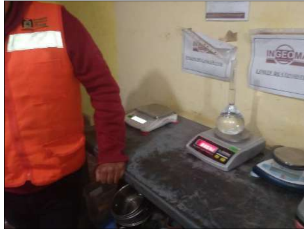
Figura 79: Pesaje del picnómetro y el agua desairada
