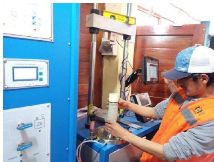
Figura 99: Muestra Colocada dentro del latex y sujeción con anillos de jebe
