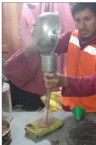
Figura 80: Colocación del material seleccionado dentro del picnómetro.
