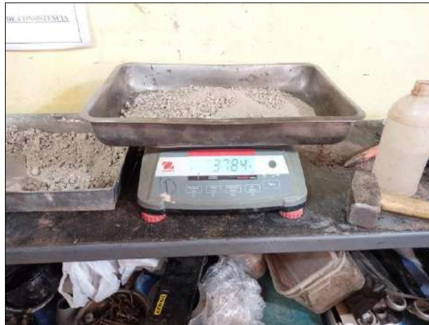
Figura 94: Muestra alterada pesado para el ensayo
