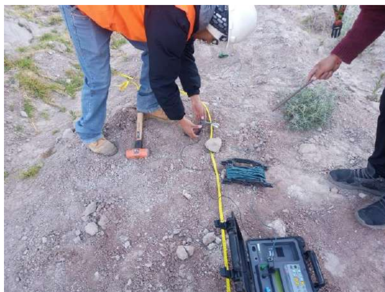
Figura 40: Colocación de los electrodos y conexión de los cables
