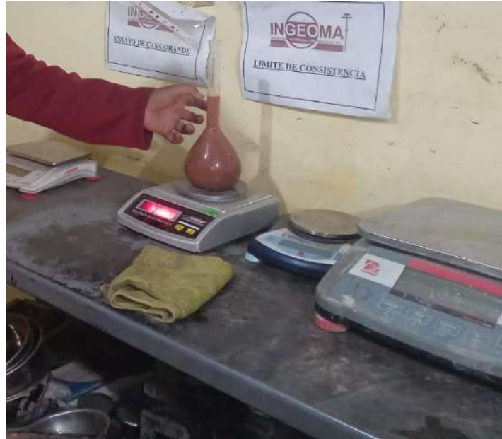
Figura 83: Pesaje del suelo, agua y picnómetro terminado el ensayo
