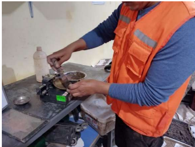
Figura 56: Colocación de la mezcla húmeda en la copa
