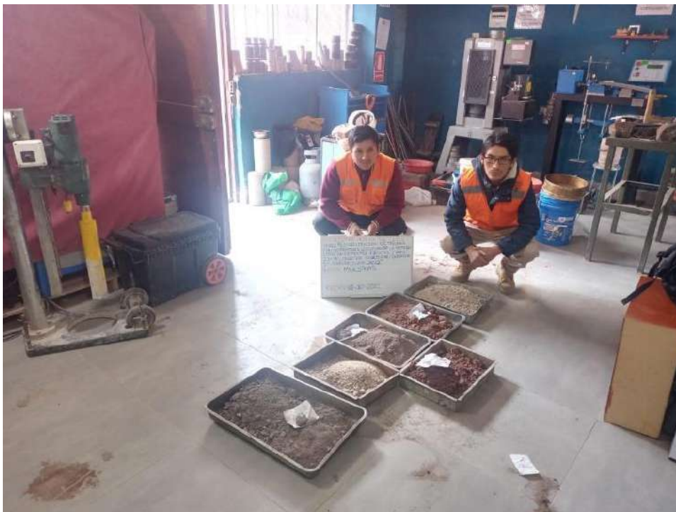
Figura 44: Muestras representativas extraídas de las calicatas
