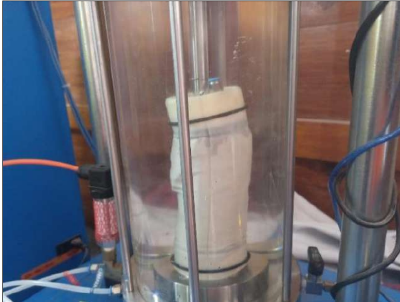
Figura 102: Vista de la Falla de la muestra dentro de la Cámara de confinamiento
