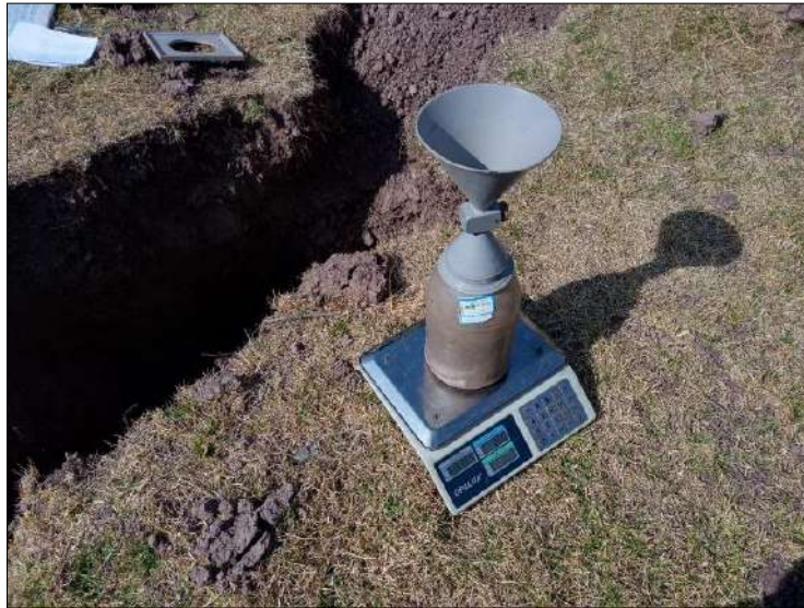
Figura 72: Pesaje del equipo de cono de arena con la arena graduada (P1)
