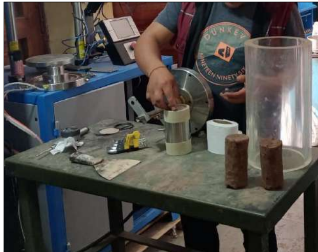
Figura 98: Membrana de Látex dentro del molde con extractor de aire
