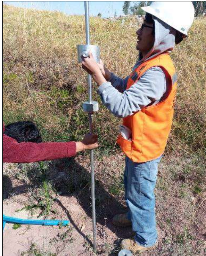
Figura 105: Aplicación de la carga con el martillo de 10kg
