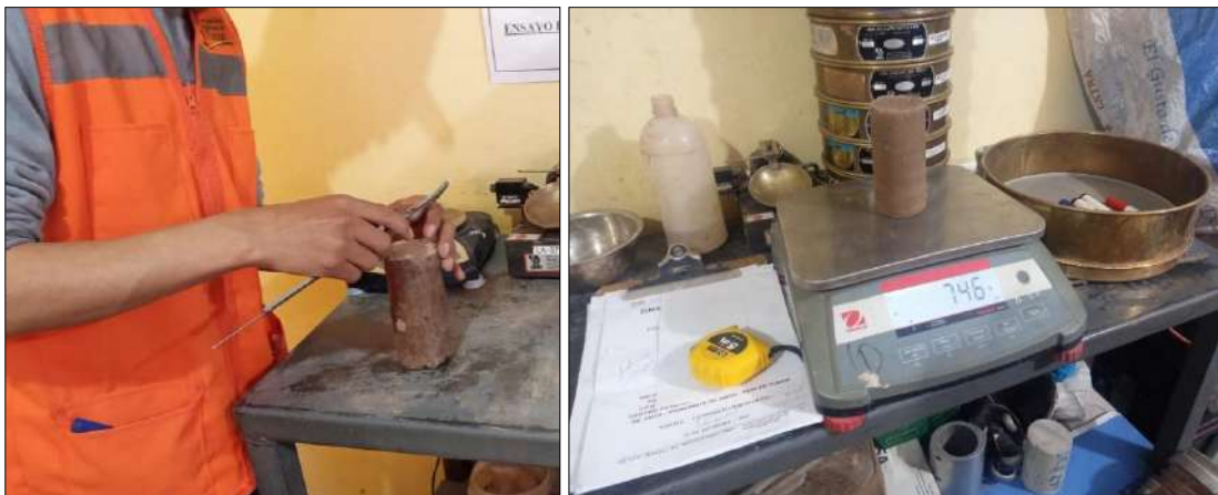
Figura 97: Medición del diámetro, altura y pesaje de las muestras
