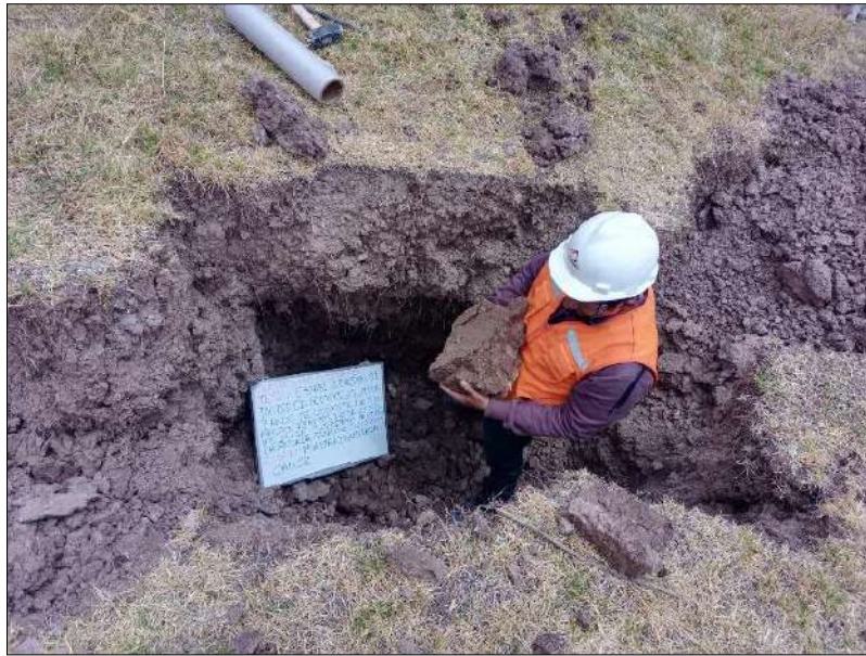
Figura 90: Extracción de la Muestra inalterada de Campo
