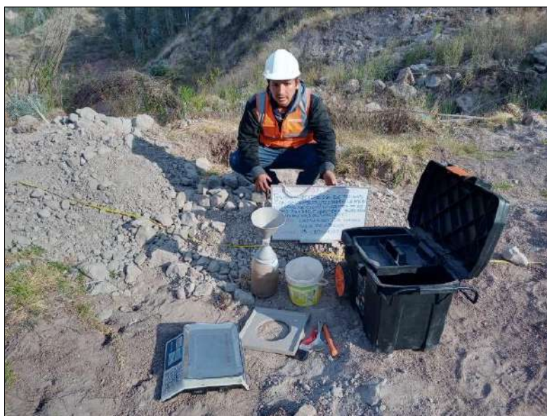
Figura 71: Verificación del equipo de cono de Arena
