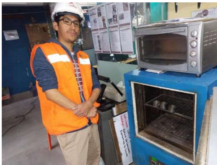
Figura 60: Toma de muestra para la determinación del contenido de humedad
