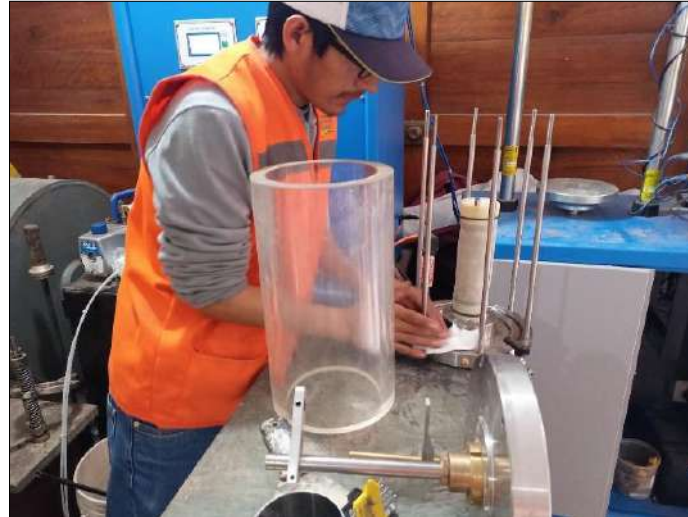
Figura 100: Colocación de la muestra e instalación de la cámara de carga
