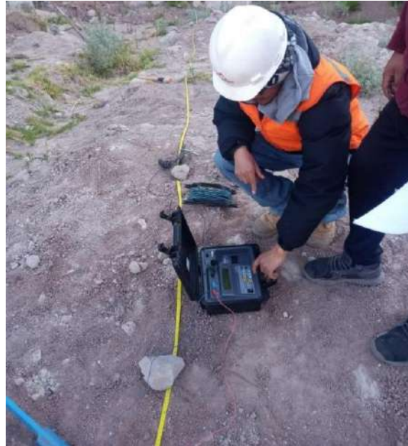
Figura 41: Inyección de corriente y lectura de la medida
