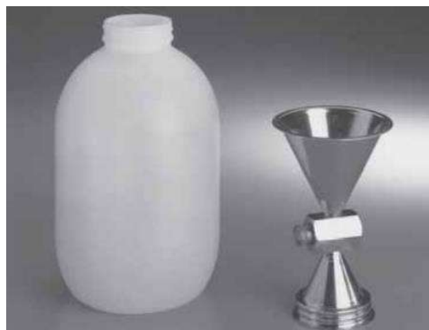
Figura 17: Jarra de plástico y cono de metal para el dispositivo del cono de arena
