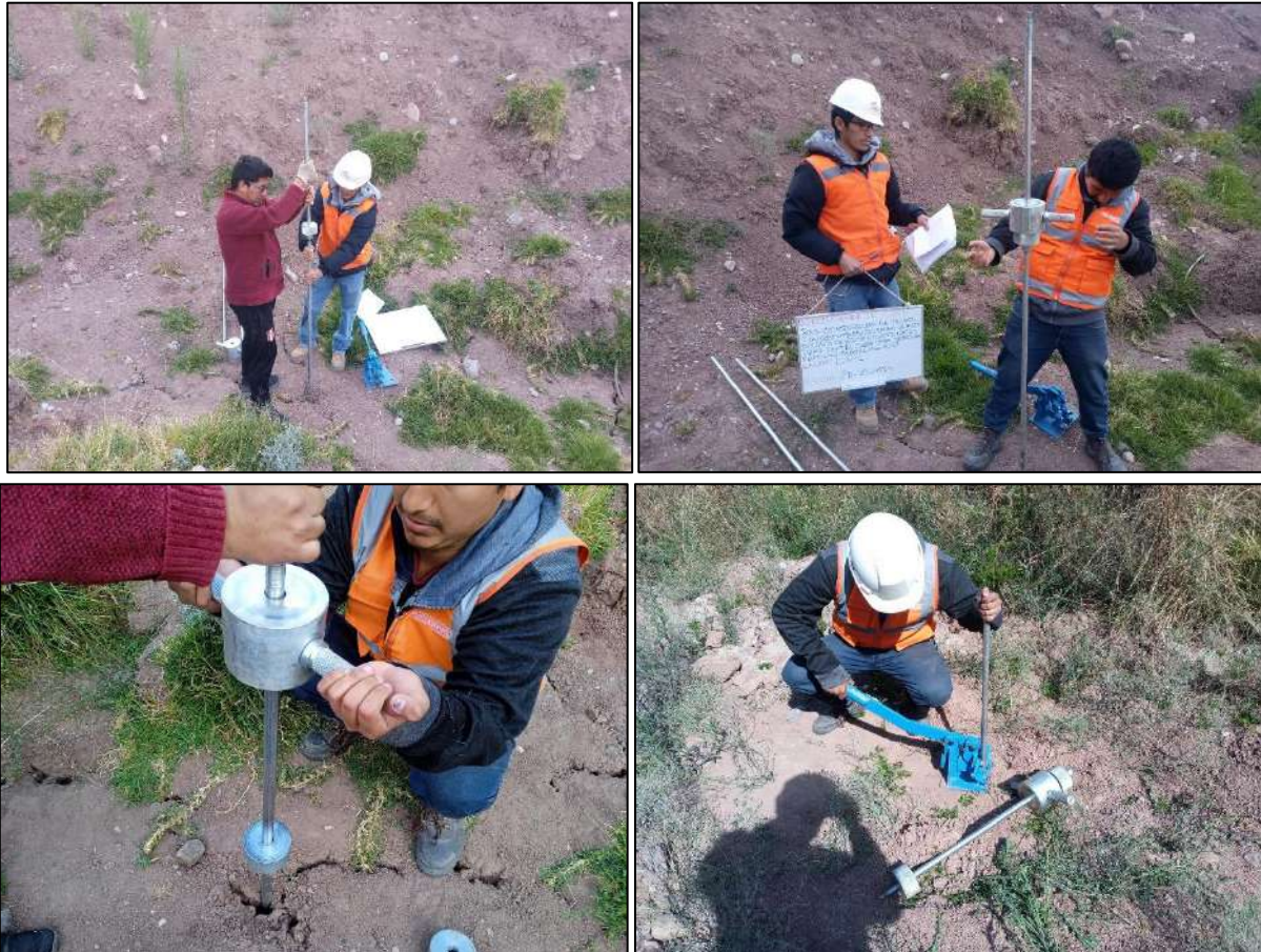
Nota: Ejecución del ensayo de DPL fotografías tomadas el día 23 de octubre del 2022.
