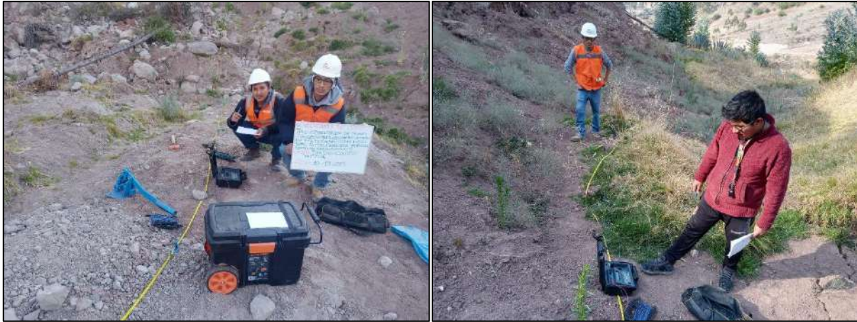
Nota: Ejecución del ensayo de sondaje eléctrico vertical fotografías tomadas el día 23 de octubre del 2022.
