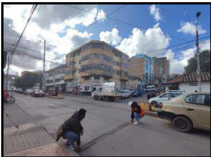
Medición manual del ancho de carril de vía principal
