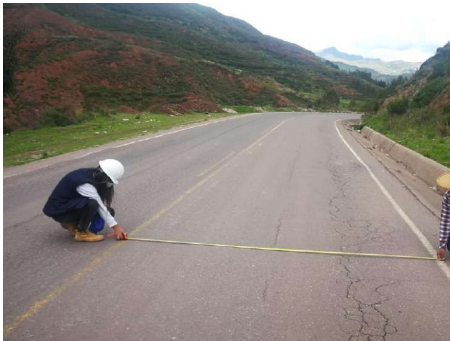
Figura N°32: toma de medidas del carril de bajada III
